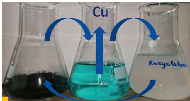
8 Schéma uzavretého cyklu extrakcie medi z odpadu na odkalisku Slovinky.
