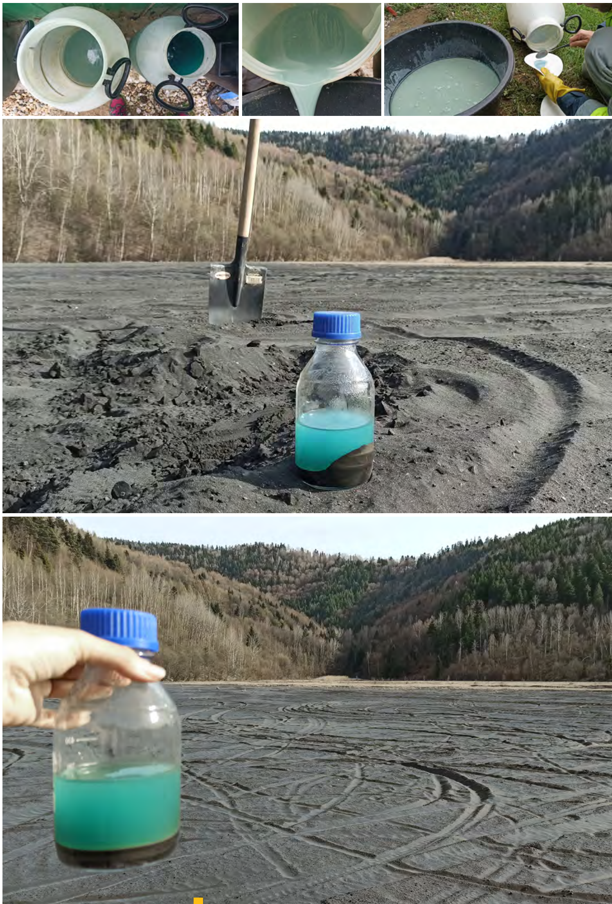
14 Z ťažobného odpadu s vysokým obsahom medi sa realizovali testy lúhovania s rôznymi médiami. Na obrázkoch hore je precipitačný proces s vápnom v 50 l výluhoch. Na obrázkoch v strede a dole vizuálny efekt extrakcie kovov vo fľašiach.
