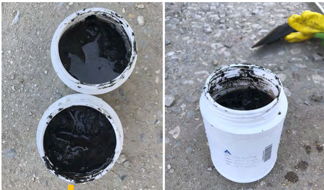
8 Odber vzoriek dnových sedimentov
