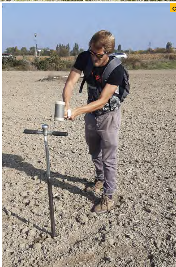
3 a) Vítanie atmogeochemickej sondy pomocou zemného vrtáka, b) Meranie znečistenia pôdneho vzduchu pomocou prístroja ECOPROBE 5, c) Hĺbenie atmogeochemickej sondy pomocou žliabkového vrtáka
