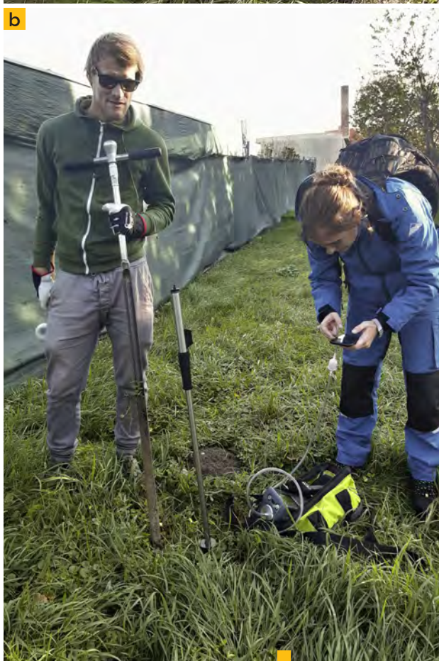
3 a) Vítanie atmogeochemickej sondy pomocou zemného vrtáka, b) Meranie znečistenia pôdneho vzduchu pomocou prístroja ECOPROBE 5, c) Hĺbenie atmogeochemickej sondy pomocou žliabkového vrtáka
