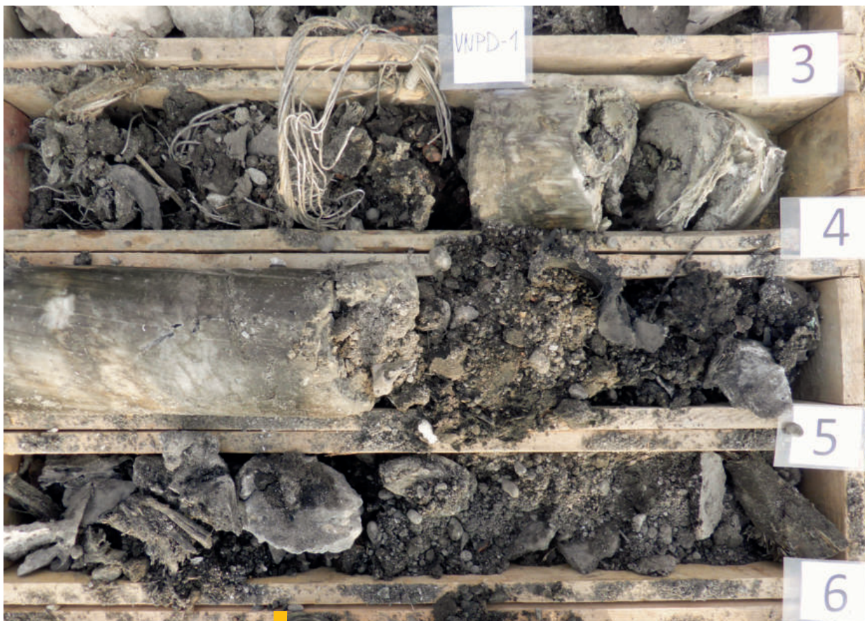
5 Profil vrtného jadra z vrtu VNPD-1 (3 – 6 m p. t.) – materiál starej časti skládky
