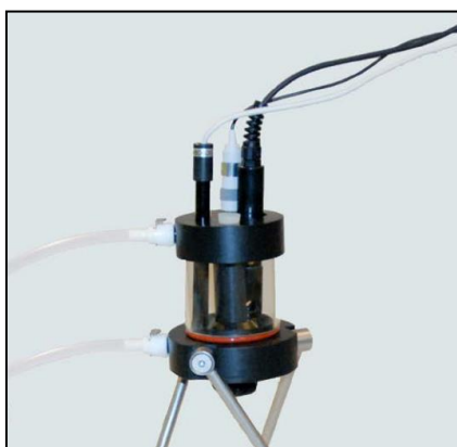
Obrázok P12_1. Meracia prietoková cela na meranie charakteristík čerpanej vody
