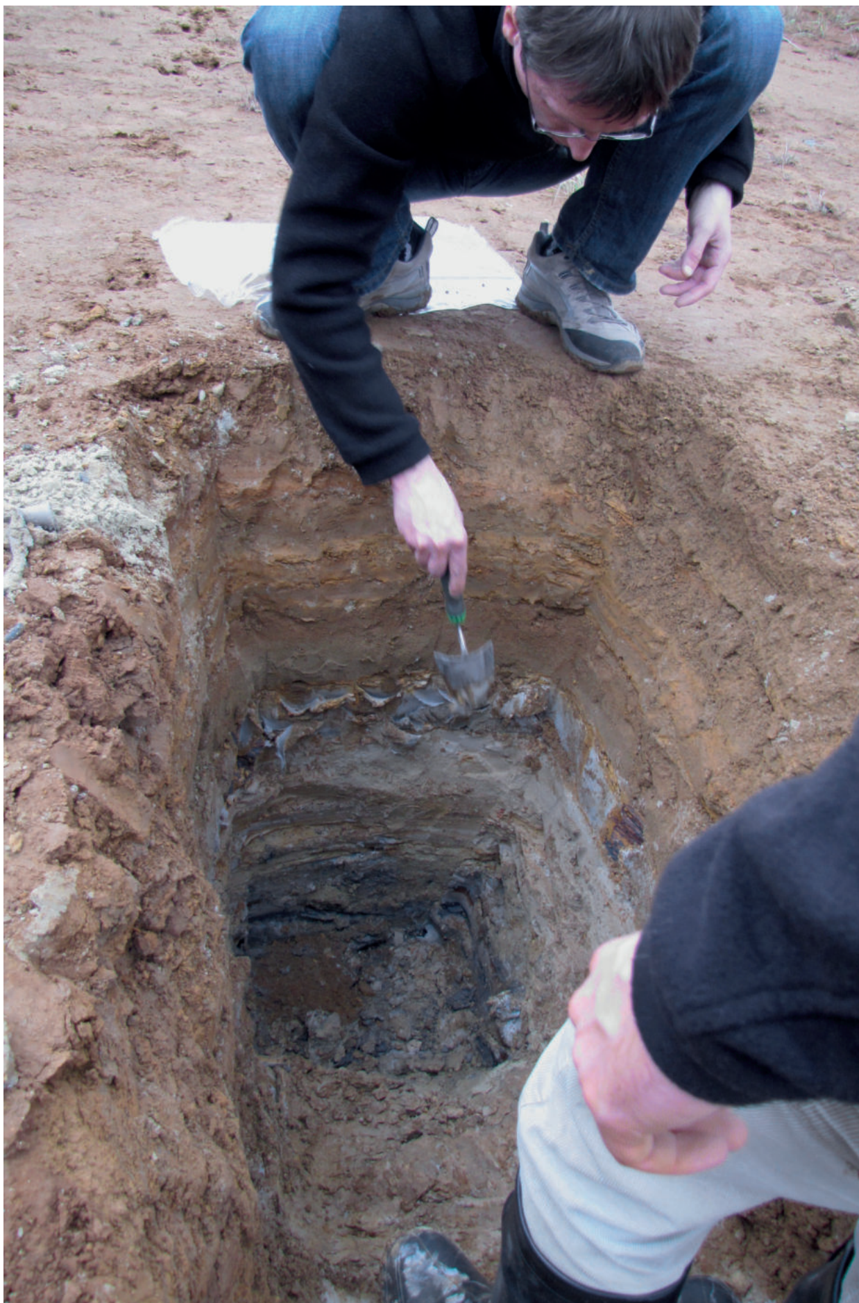
Odkalisko Markušovce-Rudňany – odber vzoriek z kopaných sond na odkalisku
