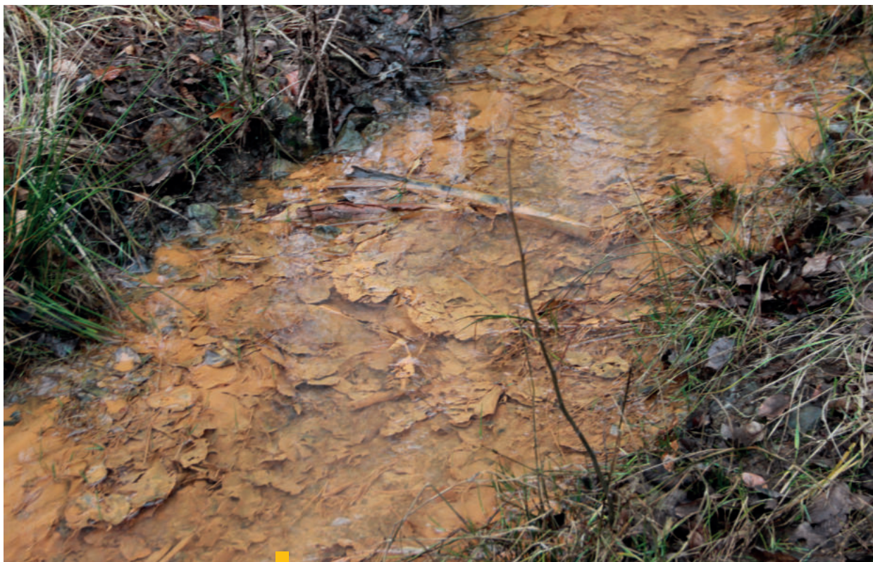
5 Fe-okre precipitujúce z drenážnej banskej vody. Na mnohých miestach sa v okolí starých baní za vhodných sedimentačných podmienok tvoria Fe okre. Ide o nespevnené oranžové zrazeniny, tvorené zväčša ťažko identifikovateľným ferihydrítom, s vysokými obsahmi As a Sb.
