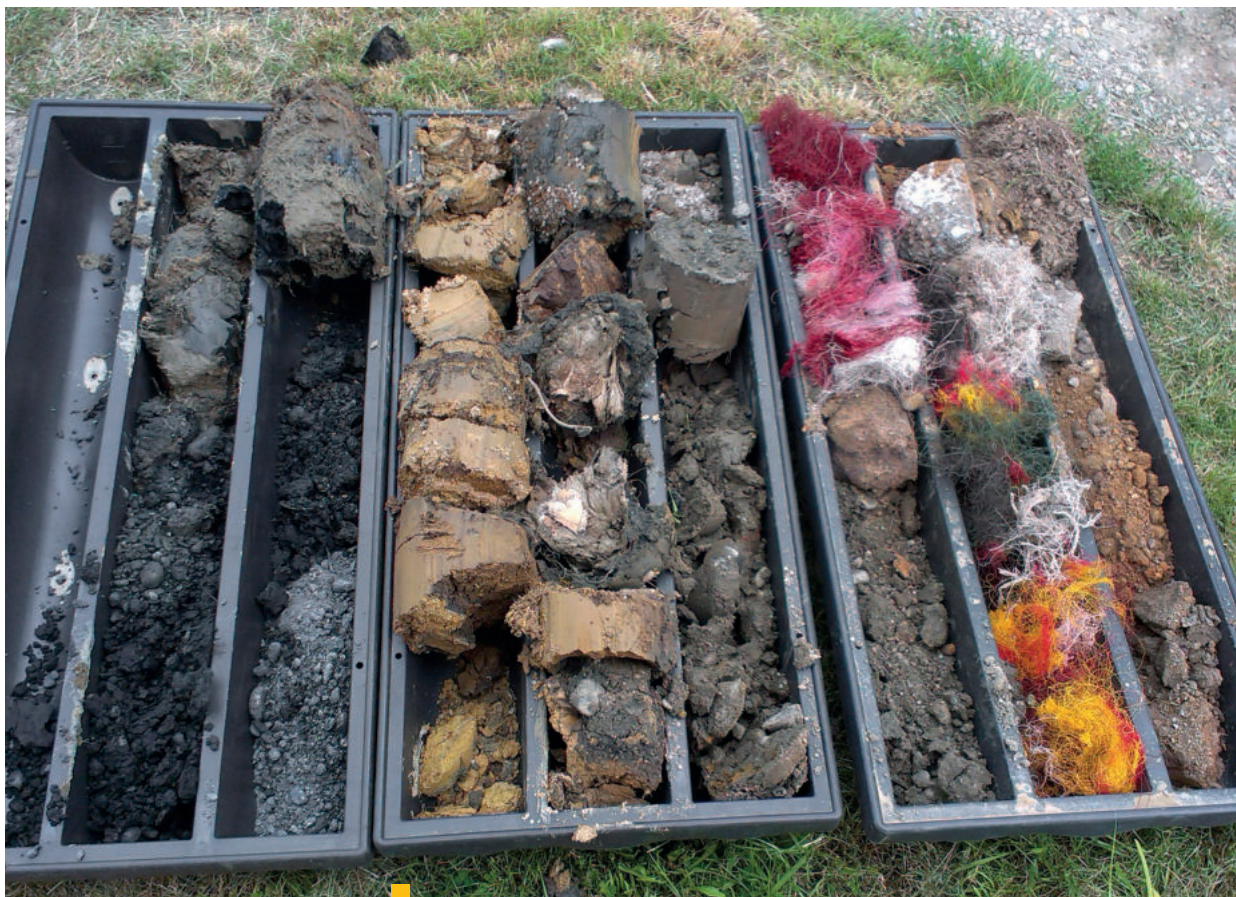
4b Profil vrtného jadra s výrazným znečistením
