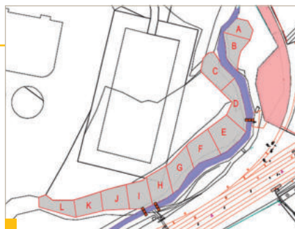
19 Rozloženie jednotlivých segmentov a umiestnenie dočasných hrádzok
