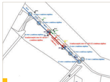
24 Schematické znázornenie celej reakčnej bariéry (červená časť vybudovaná ako pilotný pokus, modrá dobudovaná v roku 2019)
