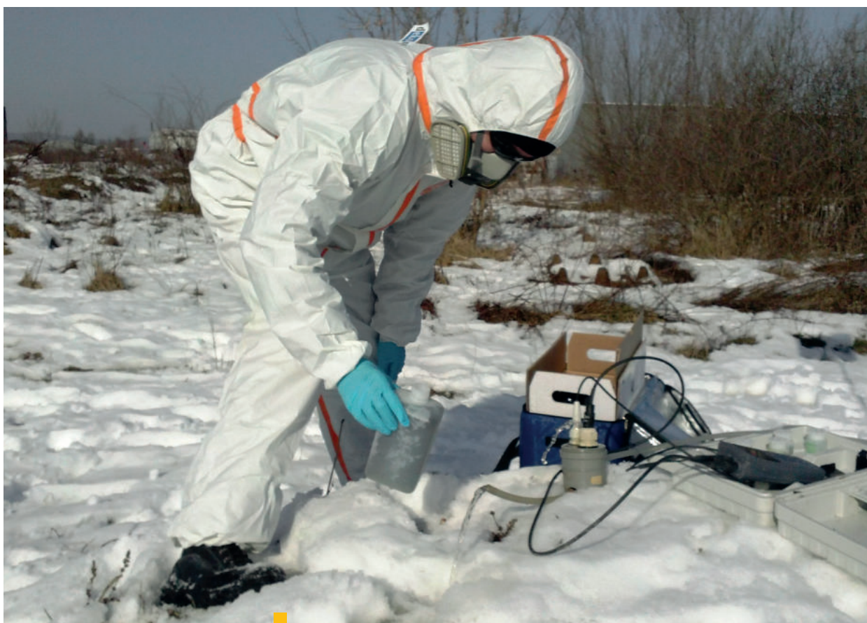
5c Obr. č. 5b a 5c – odber vzoriek podzemných vôd v zimnom období
