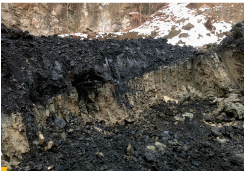
5 Vrstva tesniaceho ílu vmiešaná medzi dve guadrónové vrstvy
