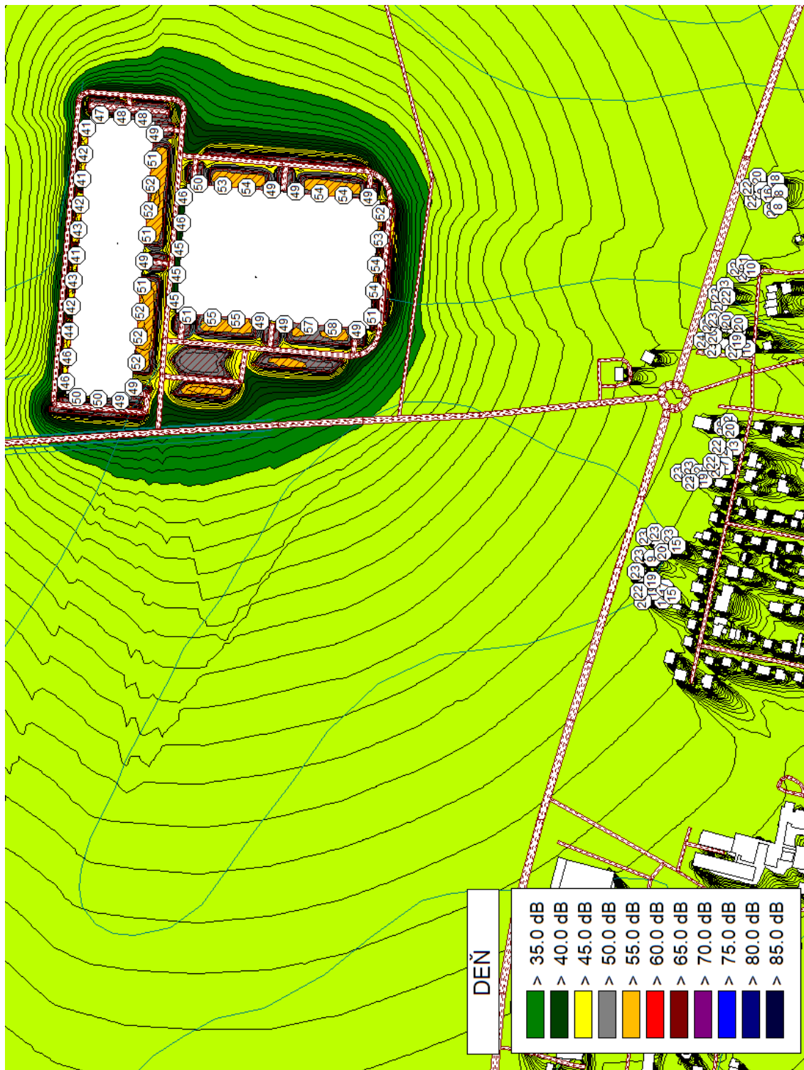
Obrázok 18 Plošná hluková zaťaž spôsobená statickou dopravou vypočítaná vo výške 1,5 m nad terénom a najvyššie hodnoty L_{Aeq} 2 m pred fasádami posudzovaných objektov a susedných budov pre referenčný časový interval DEN
