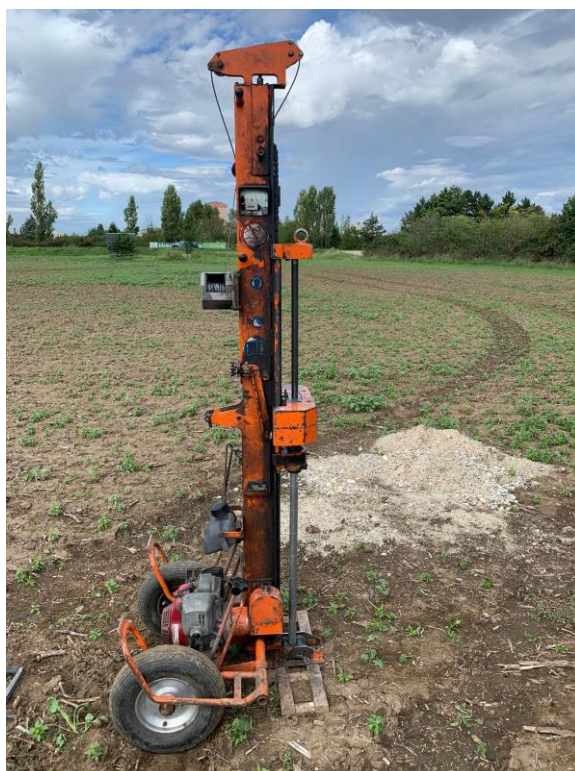
FOTO 7, 8 Vŕtaná sonda VS-4, výnos štrkov, dynamická penetračná sonda PS-4, hĺbka 10,00 m
