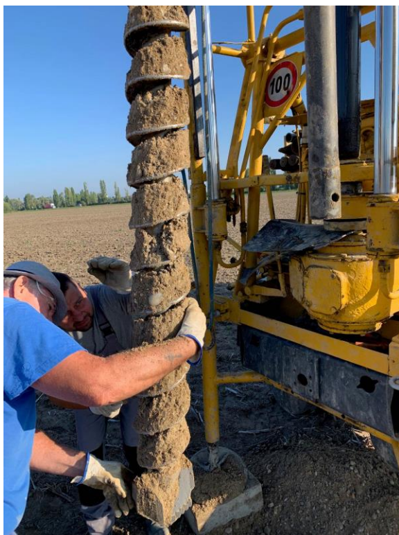
FOTO 1, 2 Vŕtaná sonda VS-1 PS-1, výnos štrkov, vrtná súprava UGB 50M, dynamická penetračná sonda PS-1, penetračná súprava Lindenmeyer, hĺbka 10,00 m
