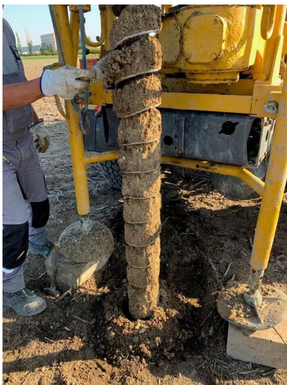
FOTO 3, 4 Vŕtaná sonda VS-2, výnos štrkov, dynamická penetračná sonda PS-2, hĺbka 10,00 m
