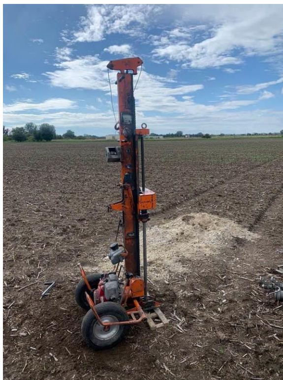
FOTO 5, 6 Vŕtaná sonda VS-3, výnos pieskov a štrkov, dynamická penetračná sonda PS-3, hĺbka 10,00 m
