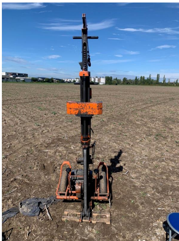
FOTO 1, 2 Vŕtaná sonda VS-1 PS-1, výnos štrkov, vrtná súprava UGB 50M, dynamická penetračná sonda PS-1, penetračná súprava Lindenmeyer, hĺbka 10,00 m
