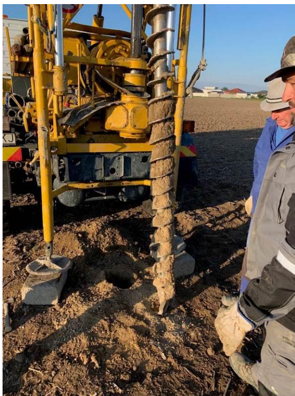
FOTO 5, 6 Vŕtaná sonda VS-3, výnos pieskov a štrkov, dynamická penetračná sonda PS-3, hĺbka 10,00 m
