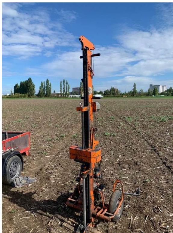
FOTO 9, 10 Vrtaná sonda VS-5, výnos štrkov, dynamická penetračná sonda PS-5, hĺbka 10,00 m
