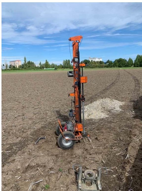
FOTO 3, 4 Vŕtaná sonda VS-2, výnos štrkov, dynamická penetračná sonda PS-2, hĺbka 10,00 m
