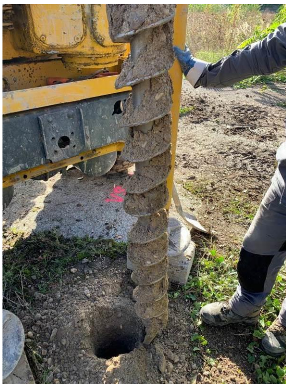
FOTO 1, 2 Vŕtaná sonda VS-1 PS-1, výnos štrkov, dynamická penetračná sonda PS-1, penetračná súprava Lindenmeyer, hĺbka 8,00 m
