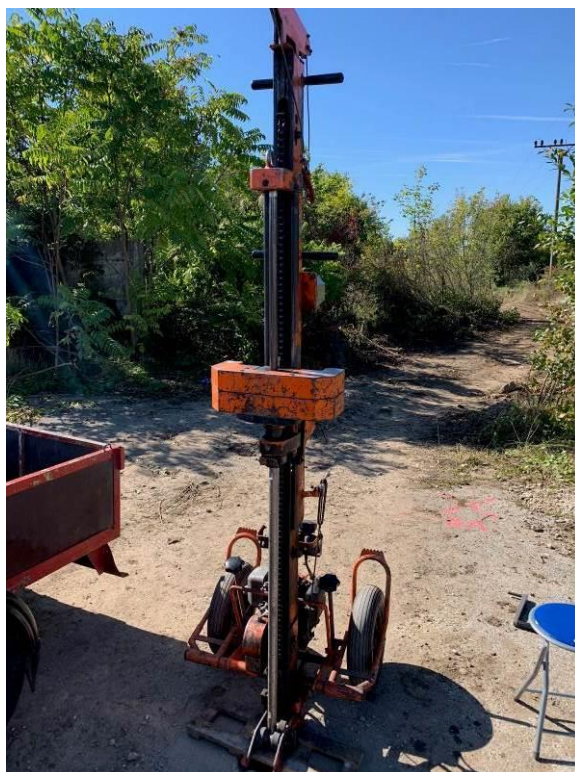
FOTO 1, 2 Vŕtaná sonda VS-1 PS-1, výnos štrkov, dynamická penetračná sonda PS-1, penetračná súprava Lindenmeyer, hĺbka 8,00 m
