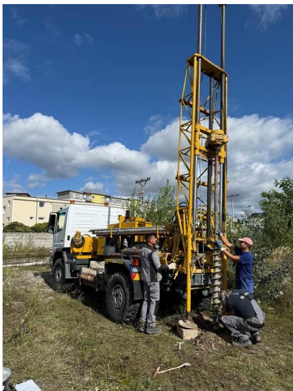
FOTO 5, 6 Vrtaná sonda VS-3, vrtná súprava UGB 50M, dynamická penetračná sonda PS-3, hĺbka 8,00 m
