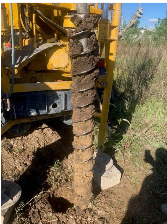
FOTO 7, 8 Vrtaná sonda VS-4, ornica a silty, dynamická penetračná sonda PS-4, hĺbka 8,00 m
