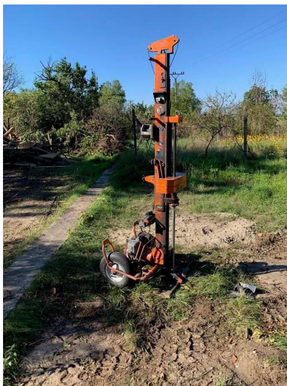
FOTO 11, 12 Vrtaná sonda VS-6, výnos štrkov, dynamická penetračná sonda PS-6, hĺbka 8,00 m
