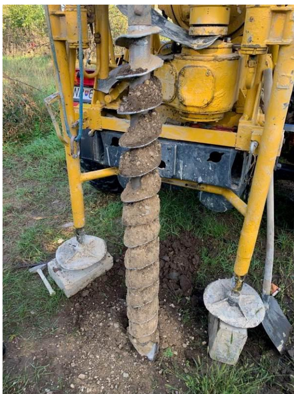
FOTO 11, 12 Vrtaná sonda VS-6, výnos štrkov, dynamická penetračná sonda PS-6, hĺbka 8,00 m
