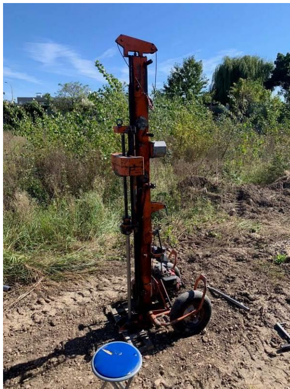
FOTO 9, 10 Vrtaná sonda VS-5, dynamická penetračná sonda PS-5, hĺbka 8,00 m
