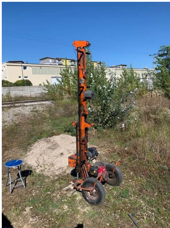
FOTO 5, 6 Vrtaná sonda VS-3, vrtná súprava UGB 50M, dynamická penetračná sonda PS-3, hĺbka 8,00 m
