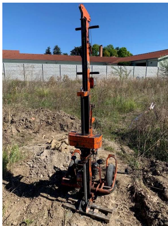
FOTO 7, 8 Vrtaná sonda VS-4, ornica a silty, dynamická penetračná sonda PS-4, hĺbka 8,00 m
