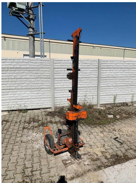
FOTO 3, 4 Vŕtaná sonda VS-2, výnos pieskov, dynamická penetračná sonda PS-2, hĺbka 8,00 m
