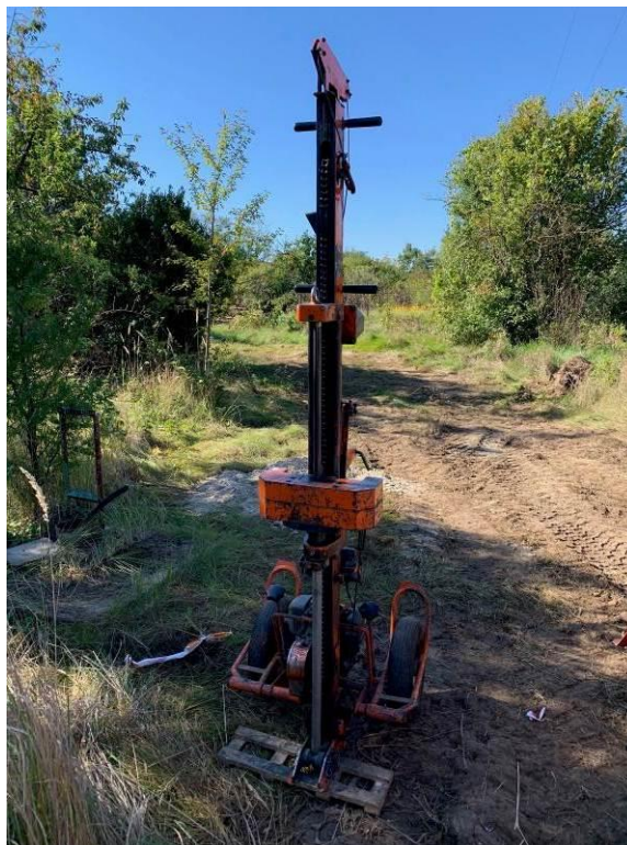
FOTO 13, 14 Vŕtaná sonda VS-7, dynamická penetračná sonda PS-7, hĺbka 8,00 m
