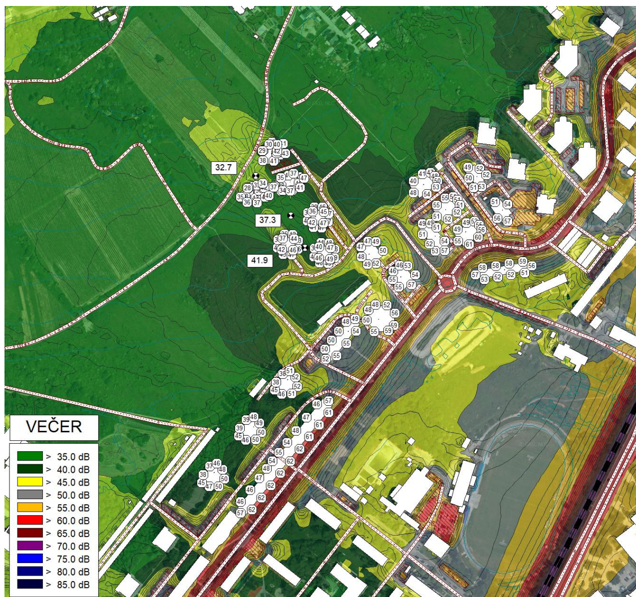
Obrázok 50 Plošná hluková záťaž spôsobená kumulatívnou dopravou vypočítaná vo výške 1,5 m nad terénom, hodnota L_{Aeq} v pozorovacích bodoch v oddychových zónach, najvyššie hodnoty L_{Aeq} 2 m pred fasádami posudzovaných objektov a najvyššie hodnoty L_{Aeq} 2 m pred fasádami okolitých budov pre referenčný časový interval VEČER
