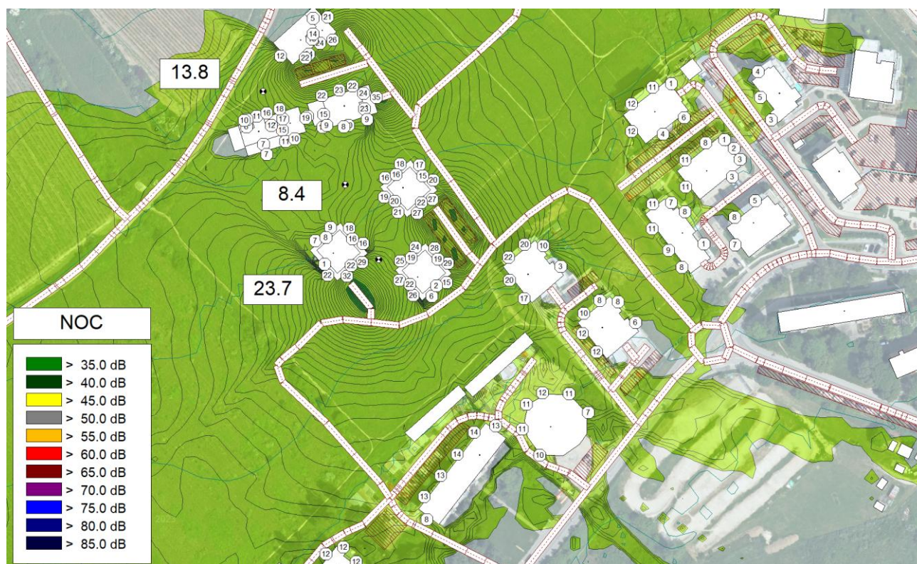
Obrázok 48 Plošná hluková záťaž spôsobená statickou dopravou vypočítaná vo výške 1,5 m nad terénom, hodnota L_{Aeq} v pozorovacích bodoch v oddychových zónach, najvyššie hodnoty L_{Aeq} 2 m pred fasádami posudzovaných objektov a najvyššie hodnoty L_{Aeq} 2 m pred fasádami okolitých budov pre referenčný časový interval NOC
