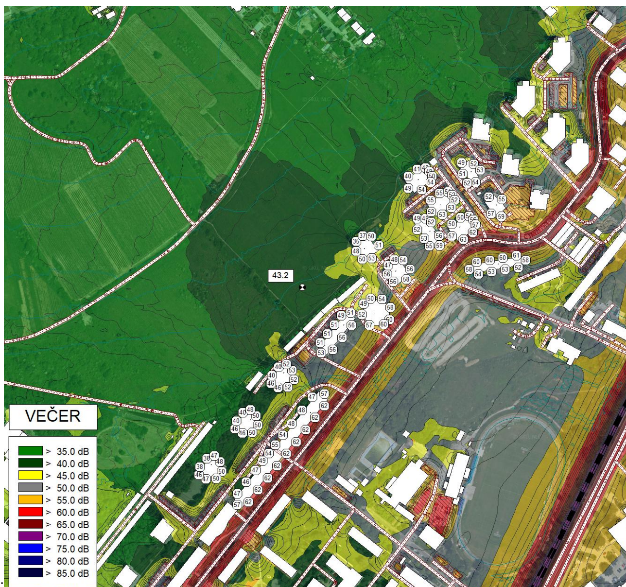
Obrázok 38 Plošná hluková záťaž spôsobená pozemnou dopravou v súčasnom stave vypočítaná vo výške 1,5 m nad terénom, hodnoty L_{Aeq} v pozorovacom bode a najvyššie hodnoty L_{Aeq} 2 m pred fasádami okolitých budov pre referenčný časový interval VEČER
