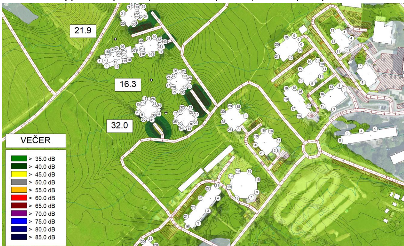
Obrázok 47 Plošná hluková záťaž spôsobená statickou dopravou vypočítaná vo výške 1,5 m nad terénom, hodnota L_{Aeq} v pozorovacích bodoch v oddychových zónach, najvyššie hodnoty L_{Aeq} 2 m pred fasádami posudzovaných objektov a najvyššie hodnoty L_{Aeq} 2 m pred fasádami okolitých budov pre referenčný časový interval VEČER
