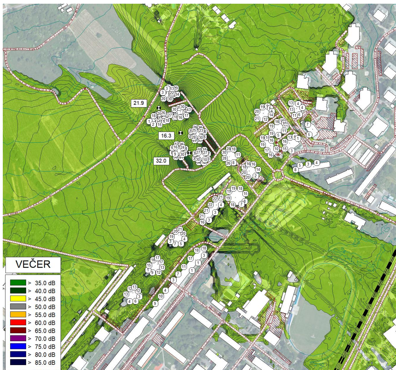
Obrázok 44 Plošná hluková záťaž spôsobená statickou dopravou vypočítaná vo výške 1,5 m nad terénom, hodnota L_{Aeq} v pozorovacích bodoch v oddychových zónach, najvyššie hodnoty L_{Aeq} 2 m pred fasádami posudzovaných objektov a najvyššie hodnoty L_{Aeq} 2 m pred fasádami okolitých budov pre referenčný časový interval VEČER
