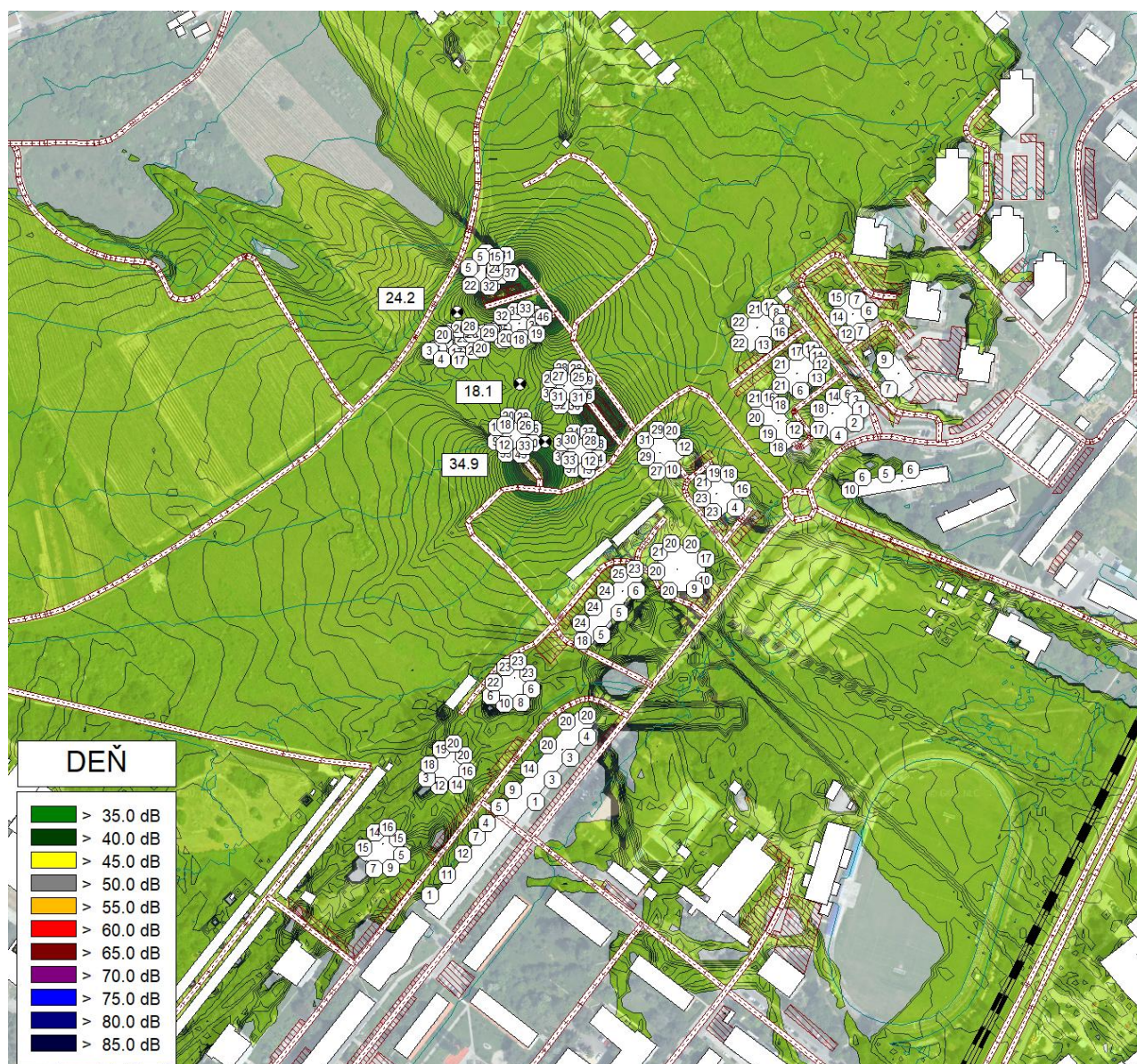
Obrázok 43 Plošná hluková záťaž spôsobená statickou dopravou vypočítaná vo výške 1,5 m nad terénom, hodnota L_{Aeq} v pozorovacích bodoch v oddychových zónach, najvyššie hodnoty L_{Aeq} 2 m pred fasádami posudzovaných objektov a najvyššie hodnoty L_{Aeq} 2 m pred fasádami okolitých budov pre referenčný časový interval DEŇ
