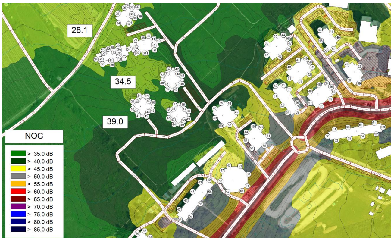
Obrázok 54 Plošná hluková záťaž spôsobená kumulatívnou dopravou vypočítaná vo výške 1,5 m nad terénom, hodnota L_{Aeq} v pozorovacích bodoch v oddychových zónach, najvyššie hodnoty L_{Aeq} 2 m pred fasádami posudzovaných objektov a najvyššie hodnoty L_{Aeq} 2 m pred fasádami okolitých budov pre referenčný časový interval NOC
