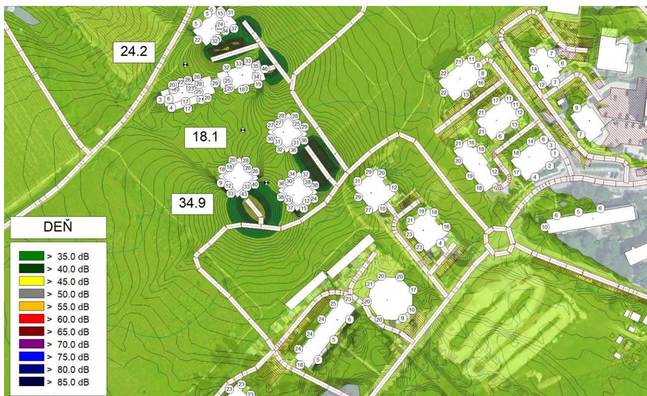
Obrázok 46 Plošná hluková záťaž spôsobená statickou dopravou vypočítaná vo výške 1,5 m nad terénom, hodnota L_{Aeq} v pozorovacích bodoch v oddychových zónach, najvyššie hodnoty L_{Aeq} 2 m pred fasádami posudzovaných objektov a najvyššie hodnoty L_{Aeq} 2 m pred fasádami okolitých budov pre referenčný časový interval DEŇ
