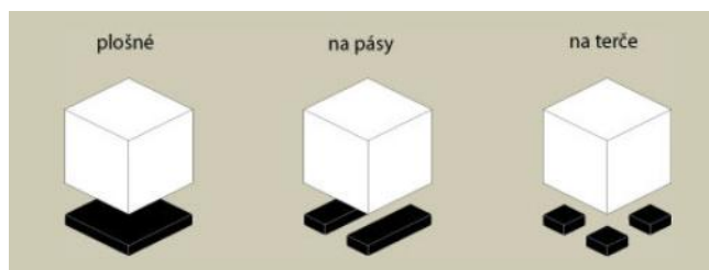
Obrázok 30 Možnosti uloženia antivibračných podložiek (dostupné na: https://www.sylomer.cz/ , https://www.getzner.com/en )
