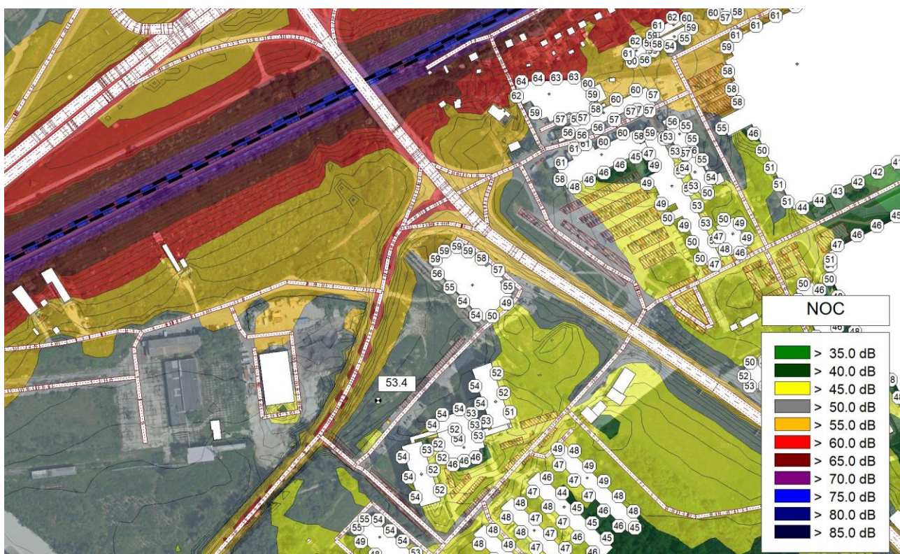
Obrázok 15 Plošná hluková záťaž spôsobená pozemnou dopravou v súčasnom stave vypočítaná vo výške 1,5 m nad terénom, hodnoty L_{Aeq} v pozorovacom bode a najvyššie hodnoty L_{Aeq} 2 m pred fasádami okolitých budov pre referenčný časový interval NOC
