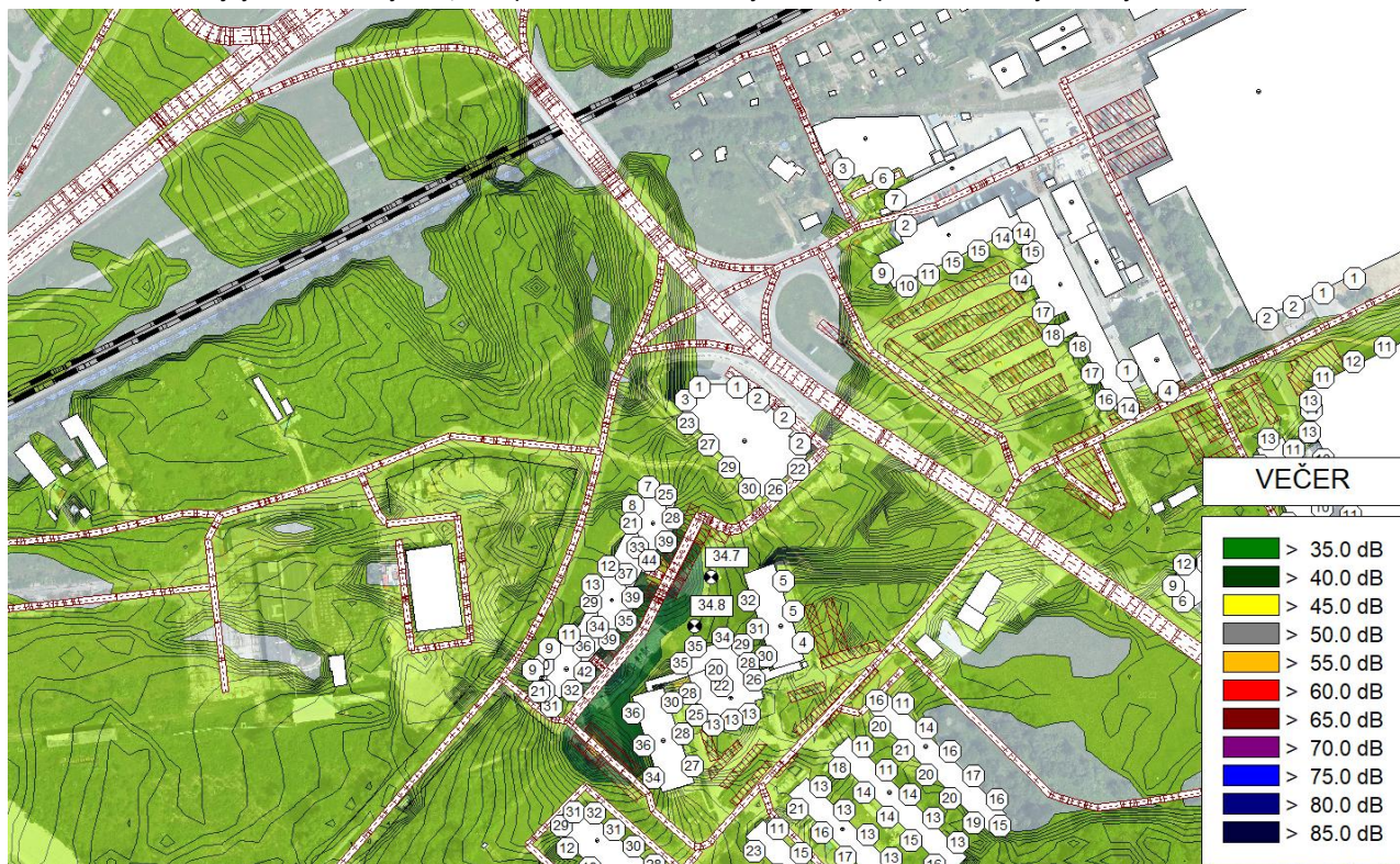
Obrázok 18 Plošná hluková záťaž spôsobená statickou dopravou vypočítaná vo výške 1,5 m nad terénom, hodnota L_{Aeq} v pozorovacích bodoch v oddychových zónach, najvyššie hodnoty L_{Aeq} 2 m pred fasádami ubytovacieho zariadenia a najvyššie hodnoty L_{Aeq} 2 m pred fasádami okolitých budov pre referenčný časový interval VEČER
