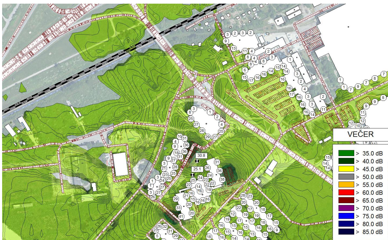
Obrázok 21 Plošná hluková záťaž spôsobená statickou dopravou vypočítaná vo výške 1,5 m nad terénom, hodnota L_{Aeq} v pozorovacích bodoch v oddychových zónach, najvyššie hodnoty L_{Aeq} 2 m pred fasádami bytovacieho zariadenia a najvyššie hodnoty L_{Aeq} 2 m pred fasádami okolitých budov pre referenčný časový interval VEČER
