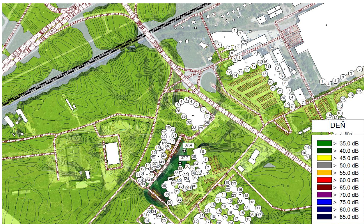
Obrázok 17 Plošná hluková záťaž spôsobená statickou dopravou vypočítaná vo výške 1,5 m nad terénom, hodnota L_{Aeq} v pozorovacích bodoch v oddychových zónach, najvyššie hodnoty L_{Aeq} 2 m pred fasádami ubytovacieho zariadenia a najvyššie hodnoty L_{Aeq} 2 m pred fasádami okolitých budov pre referenčný časový interval DEN
