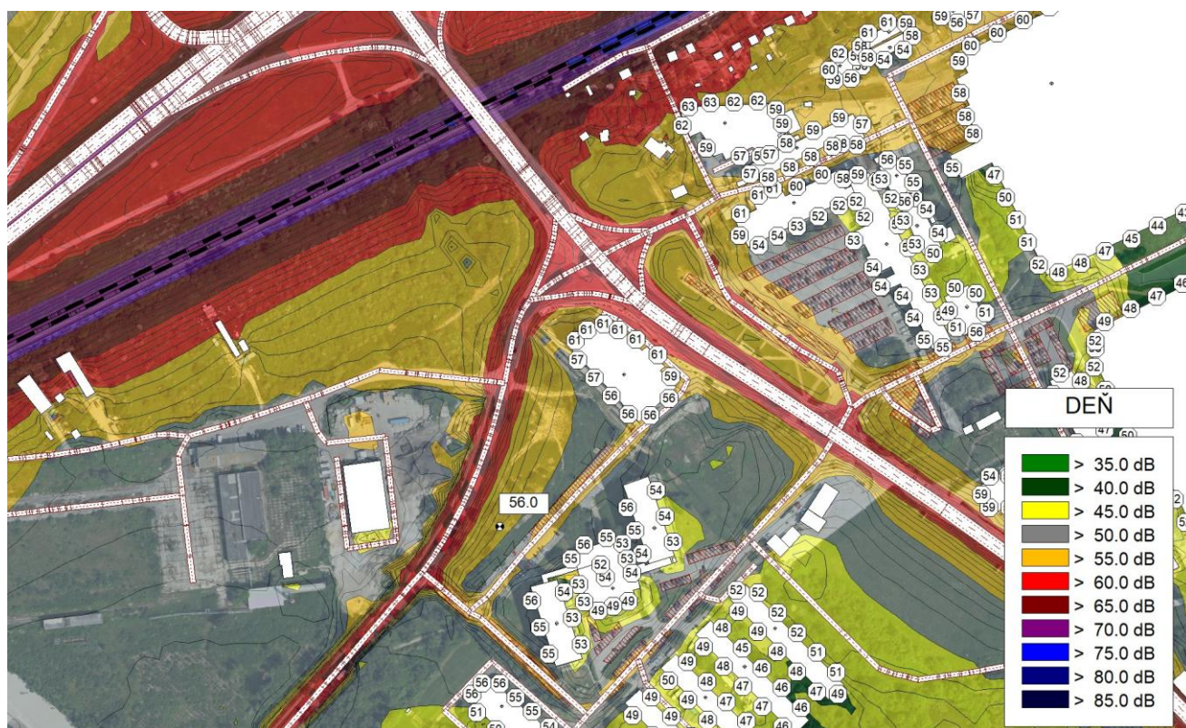
Obrázok 13 Plošná hluková záťaž spôsobená pozemnou dopravou v súčasnom stave vypočítaná vo výške 1,5 m nad terénom, hodnoty L_{Aeq} v pozorovacom bode a najvyššie hodnoty L_{Aeq} 2 m pred fasádami okolitých budov pre referenčný časový interval DEN
