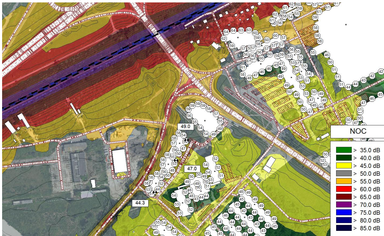
Obrázok 25 Plošná hluková záťaž spôsobená kumulatívnou dopravou vypočítaná vo výške 1,5 m nad terénom, hodnota L_{Aeq} v pozorovacích bodoch v oddychových zónach, najvyššie hodnoty L_{Aeq} 2 m pred fasádami ubytovacieho zariadenia a najvyššie hodnoty L_{Aeq} 2 m pred fasádami okolitých budov pre referenčný časový interval NOC
