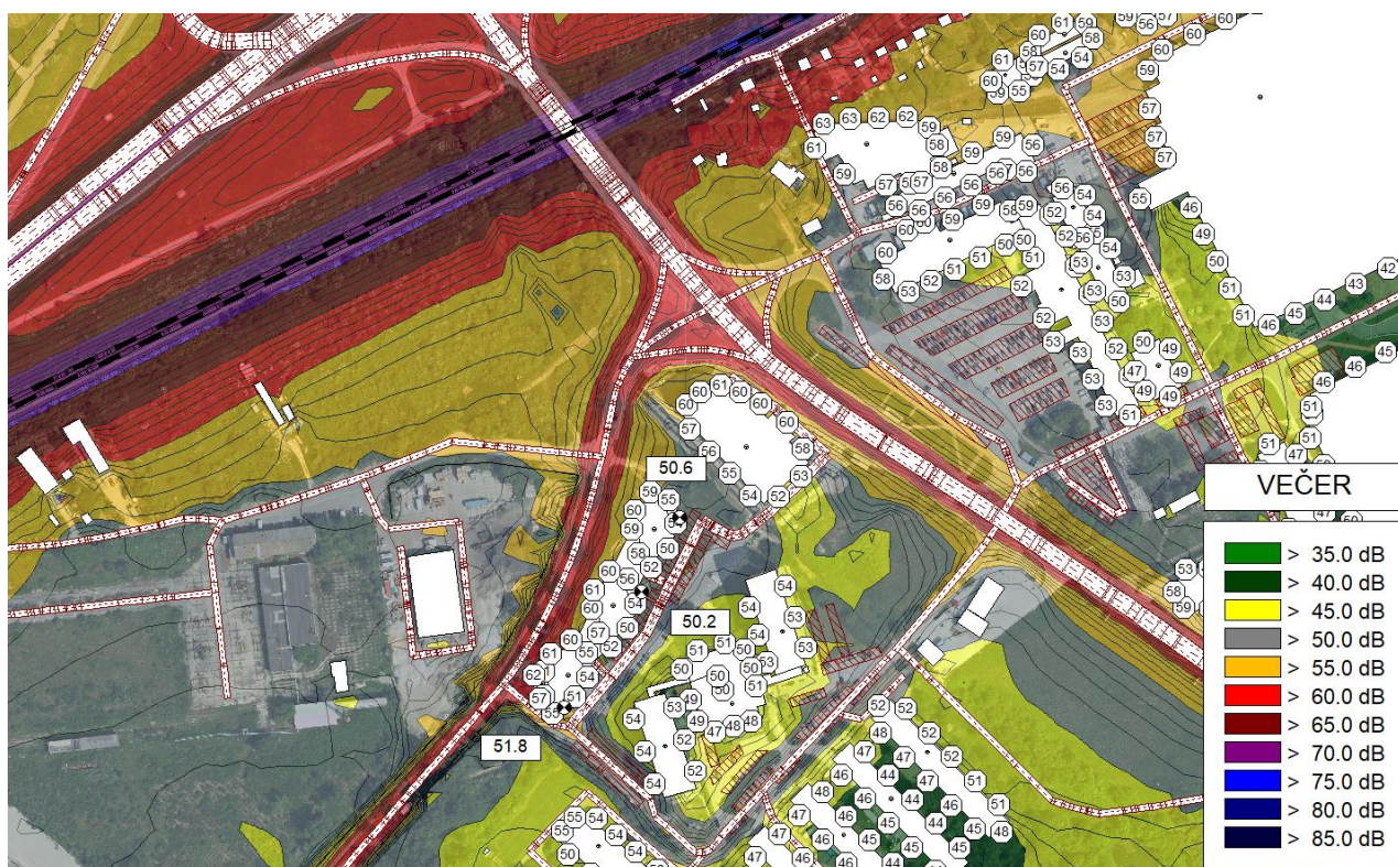
Obrázok 24 Plošná hluková záťaž spôsobená kumulatívnou dopravou vypočítaná vo výške 1,5 m nad terénom, hodnota L_{Aeq} v pozorovacích bodoch v oddychových zónach, najvyššie hodnoty L_{Aeq} 2 m pred fasádami ubytovacieho zariadenia a najvyššie hodnoty L_{Aeq} 2 m pred fasádami okolitých budov pre referenčný časový interval VEČER
