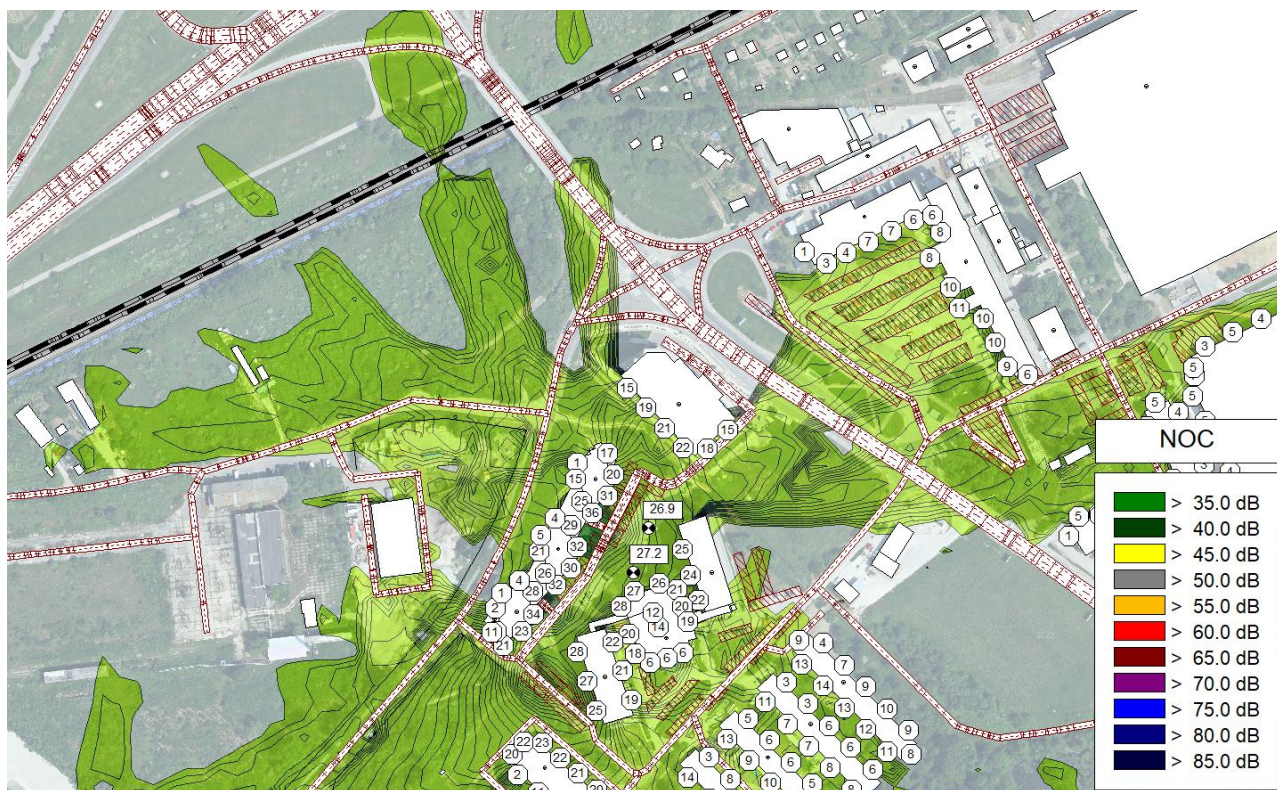
Obrázok 19 Plošná hluková záťaž spôsobená statickou dopravou vypočítaná vo výške 1,5 m nad terénom, hodnota L_{Aeq} v pozorovacích bodoch v oddychových zónach, najvyššie hodnoty L_{Aeq} 2 m pred fasádami ubytovacieho zariadenia a najvyššie hodnoty L_{Aeq} 2 m pred fasádami okolitých budov pre referenčný časový interval NOC
