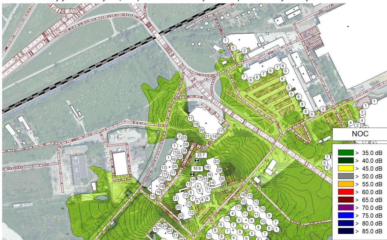
Obrázok 22 Plošná hluková záťaž spôsobená statickou dopravou vypočítaná vo výške 1,5 m nad terénom, hodnota L_{Aeq} v pozorovacích bodoch v oddychových zónach, najvyššie hodnoty L_{Aeq} 2 m pred fasádami bytovacieho zariadenia a najvyššie hodnoty L_{Aeq} 2 m pred fasádami okolitých budov pre referenčný časový interval NOC
