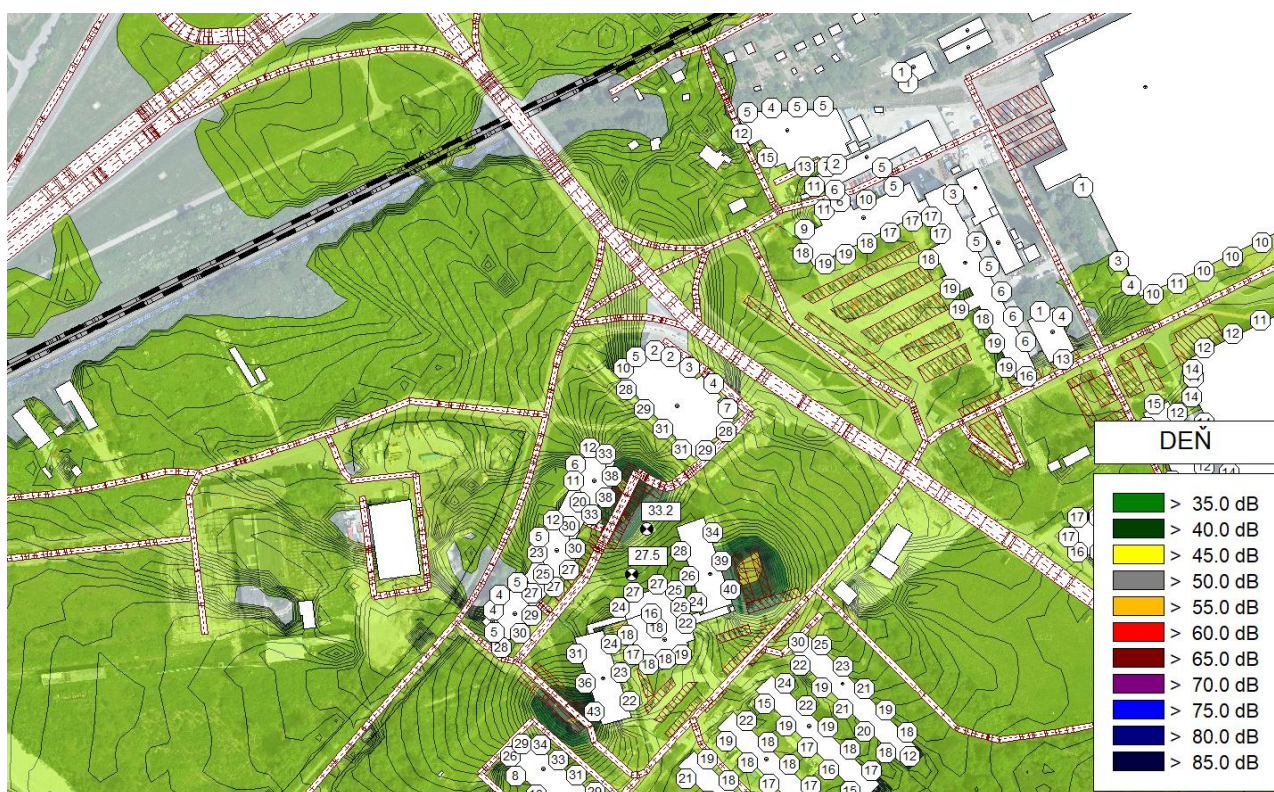
Obrázok 20 Plošná hluková záťaž spôsobená statickou dopravou vypočítaná vo výške 1,5 m nad terénom, hodnota L_{Aeq} v pozorovacích bodoch v oddychových zónach, najvyššie hodnoty L_{Aeq} 2 m pred fasádami ubytovacieho zariadenia a najvyššie hodnoty L_{Aeq} 2 m pred fasádami okolitých budov pre referenčný časový interval DEŇ
