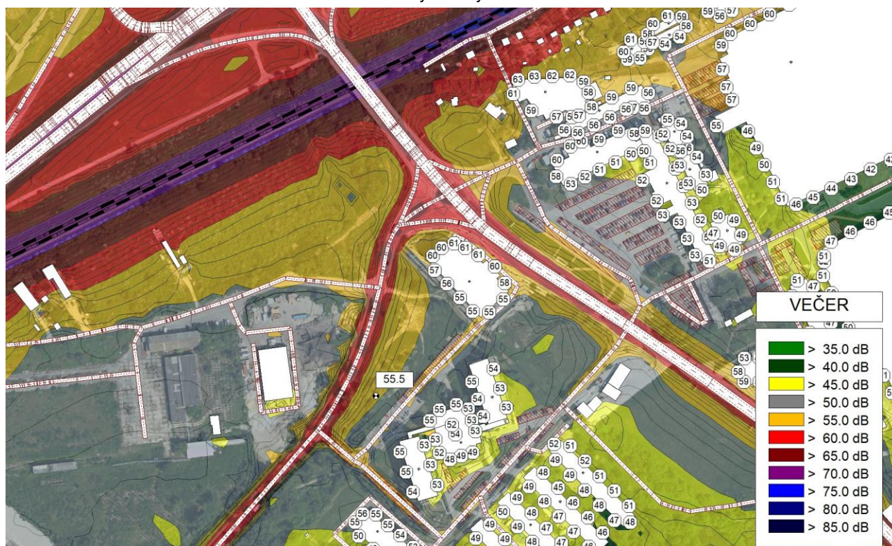
Obrázok 14 Plošná hluková záťaž spôsobená pozemnou dopravou v súčasnom stave vypočítaná vo výške 1,5 m nad terénom, hodnoty L_{Aeq} v pozorovacom bode a najvyššie hodnoty L_{Aeq} 2 m pred fasádami okolitých budov pre referenčný časový interval VEČER
