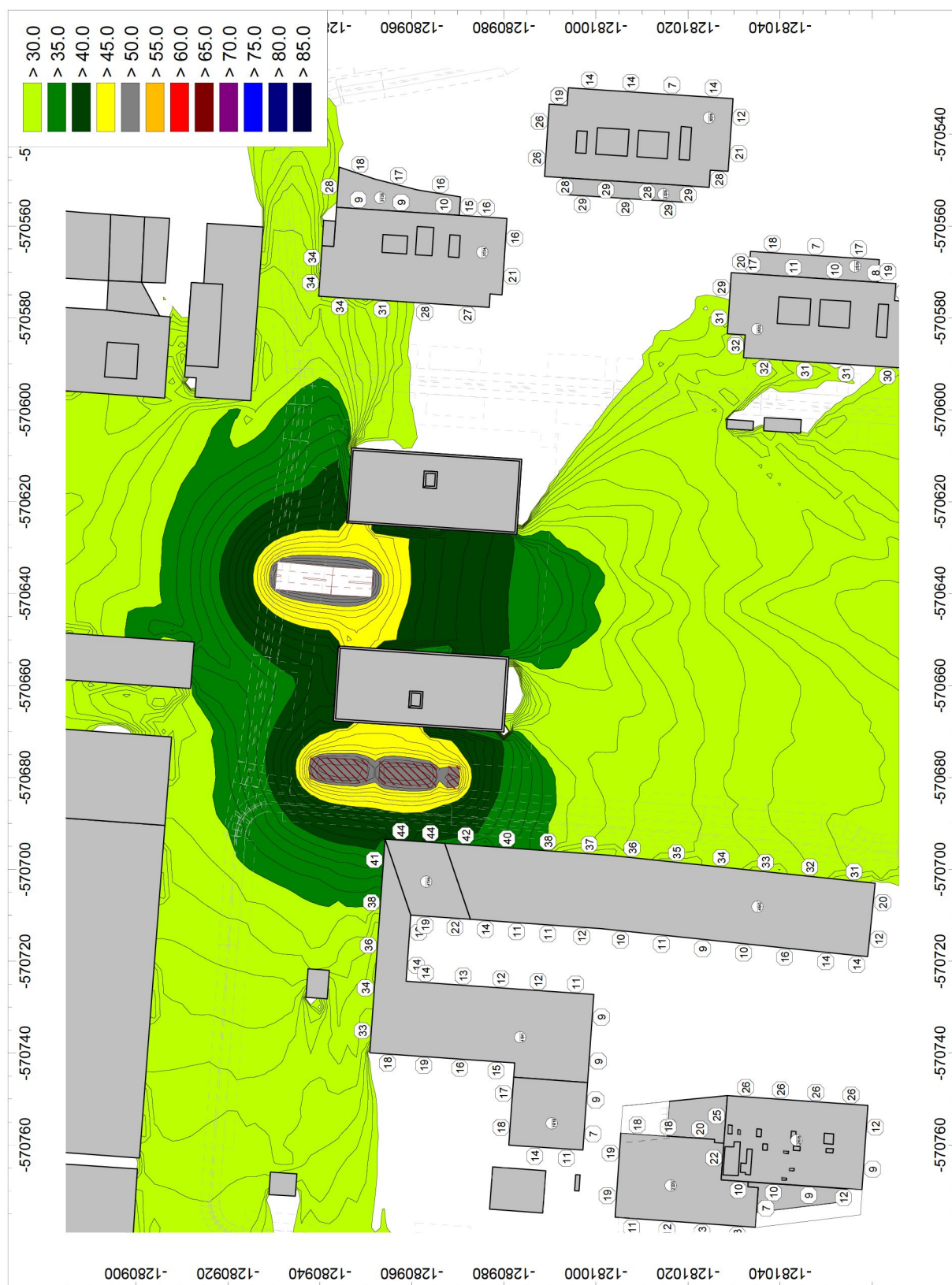
Obr. 18 hluková záťaž vypočítaná vo výške 1,5 m nad terénom, pre večerný referenčný časový interval a hodnoty ekvivalentných hladín A zvuku pred fasádami najbližších chránených objektov, delenie pásiem po 5 dB
