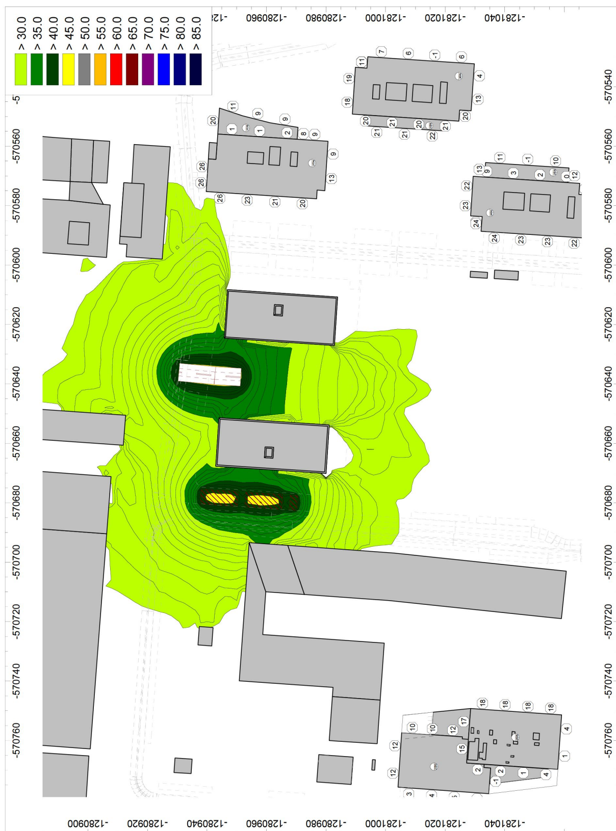
Obr. 19 hluková záťaž vypočítaná vo výške 1,5 m nad terénom, pre nočný referenčný časový interval a hodnoty ekvivalentných hladín A zvuku pred fasádami najbližších chránených objektov, delenie pásiem po 5 dB
