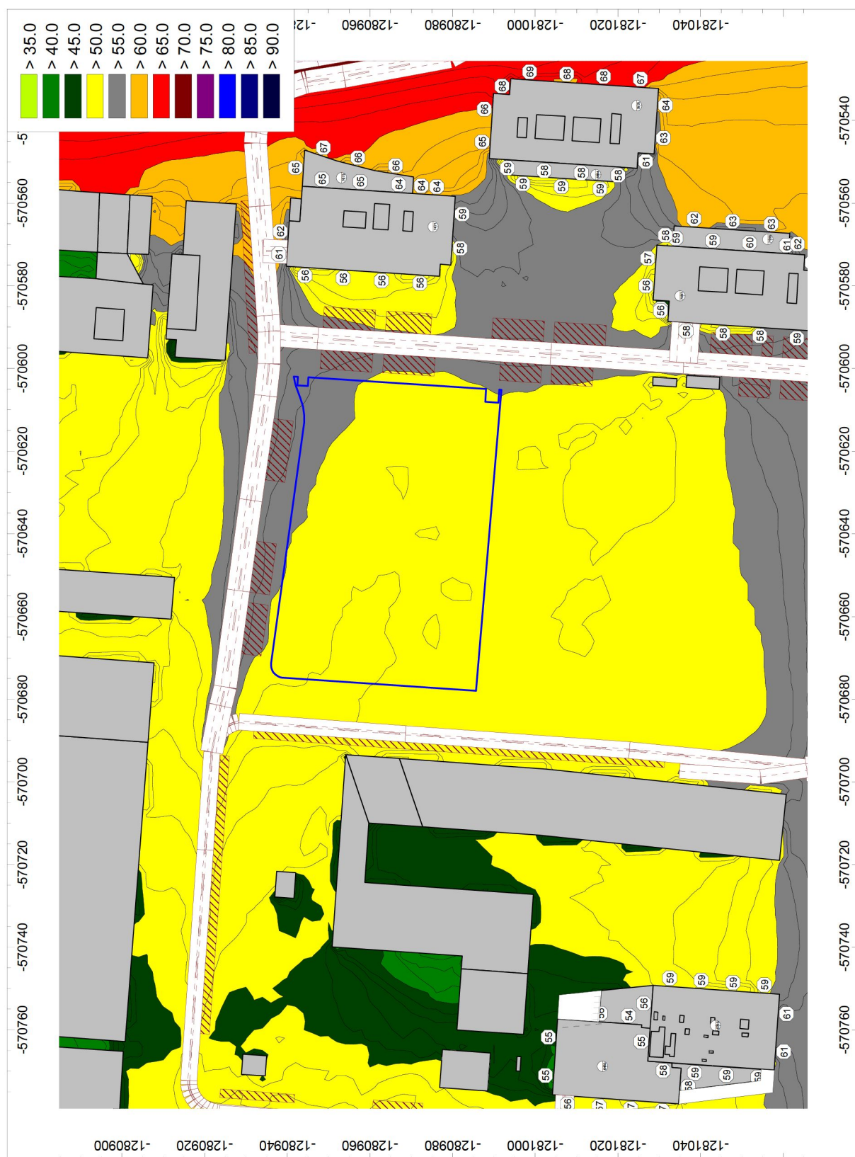
Obr. 22 hluková záťaž vypočítaná vo výške 1,5 m nad terénom, pre nočný referenčný časový interval a hodnoty ekvivalentných hladín A zvuku pred fasádami najbližších chránených objektov, delenie pásiem po 5 dB
