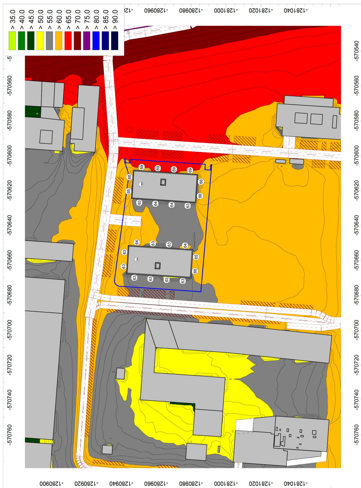
Obr. 28 hluková záťaž vypočítaná vo výške 1,5 m nad terénom, pre večerný referenčný časový interval a hodnoty ekvivalentných hladín A zvuku pred fasádami najbližších chránených objektov, delenie pásiem po 5 dB
