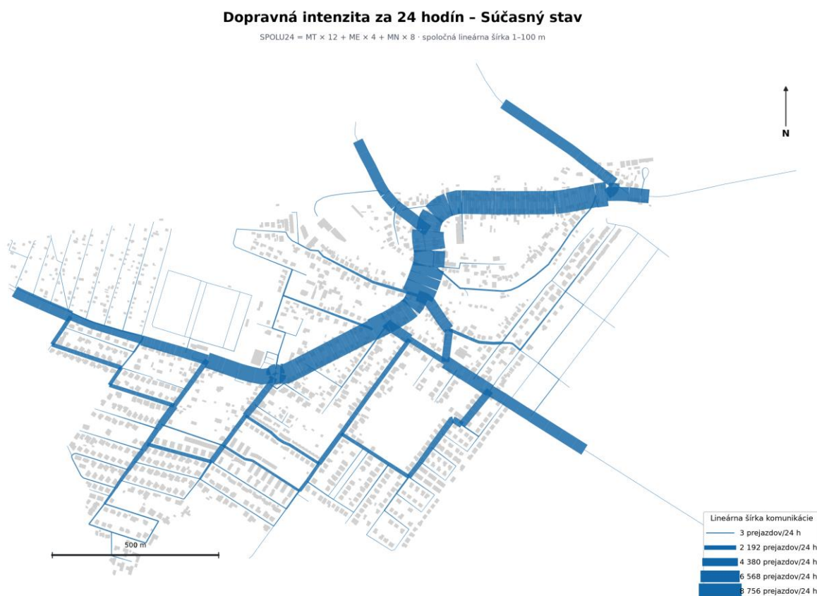
Obr. 3: Modelované 24-hodinové intenzity dopravy v súčasnom stave; šírka línií je vyjadrená lineárne.
