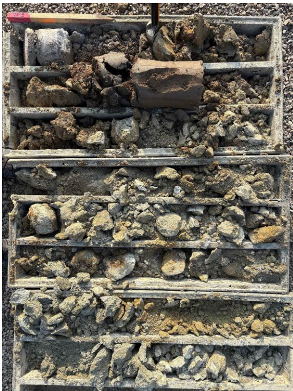
FOTO 22, 23 Vrtaná sonda VS-9, hĺbka 0-8 m a 8-14 m, vrtný výnos kvartérnych a neogénnych sedimentov
