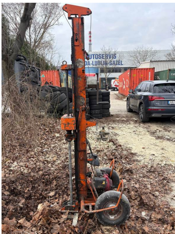
Foto 28, 29 Dynamická penetračná sonda PS-5 a PS-7, súprava Lindenmeyer
