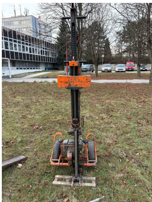
Foto 26, 27 Dynamická penetračná sonda PS-1 a PS-4, súprava Lindenmeyer
