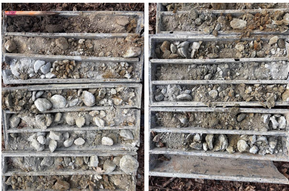
FOTO 10, 11 Vŕtaná sonda VS-3, hĺbka 0-8 m a 8-14 m, vrtný výnos kvartérnych a neogénnych sedimentov
