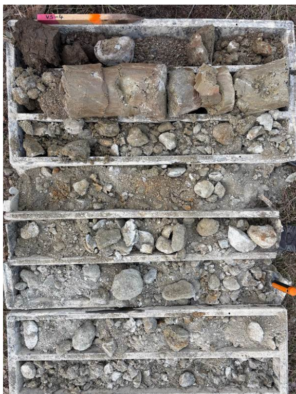
FOTO 12, 13 Vrtaná sonda VS-4, hĺbka 0-8 m a 8-14 m, vrtný výnos kvartérnych a neogénnych sedimentov
