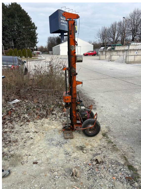
Foto 28, 29 Dynamická penetračná sonda PS-5 a PS-7, súprava Lindenmeyer
