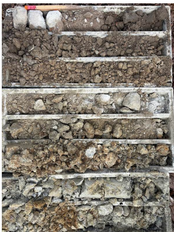
FOTO 14, 15 Vrtaná sonda VS-5, hĺbka 0-8 m a 8-14 m, vrtný výnos kvartérnych a neogénnych sedimentov
