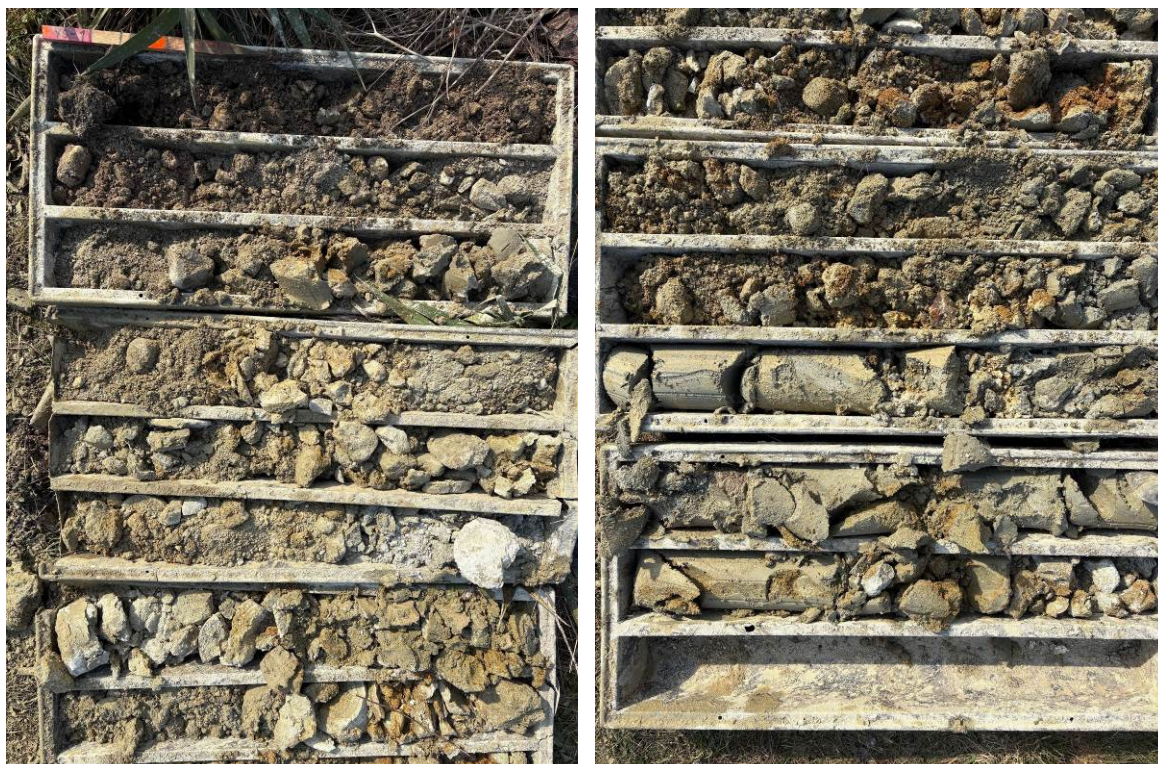
FOTO 6, 7 Vrtaná sonda VS-1, hĺbka 0-8 m a 8-14 m, vrtný výnos kvartérnych a neogénnych sedimentov
