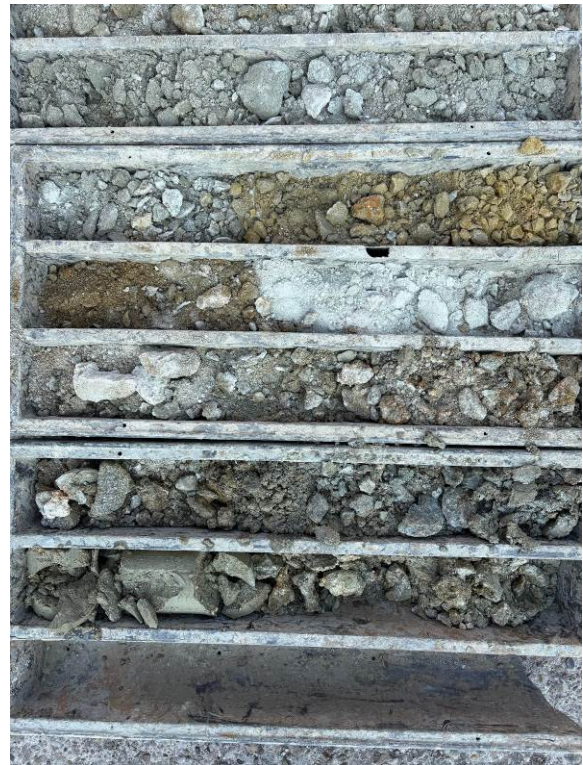
FOTO 20, 21 Vrtaná sonda VS-8, hĺbka 0-8 m a 8-14 m, vrtný výnos kvartérnych a neogénnych sedimentov
