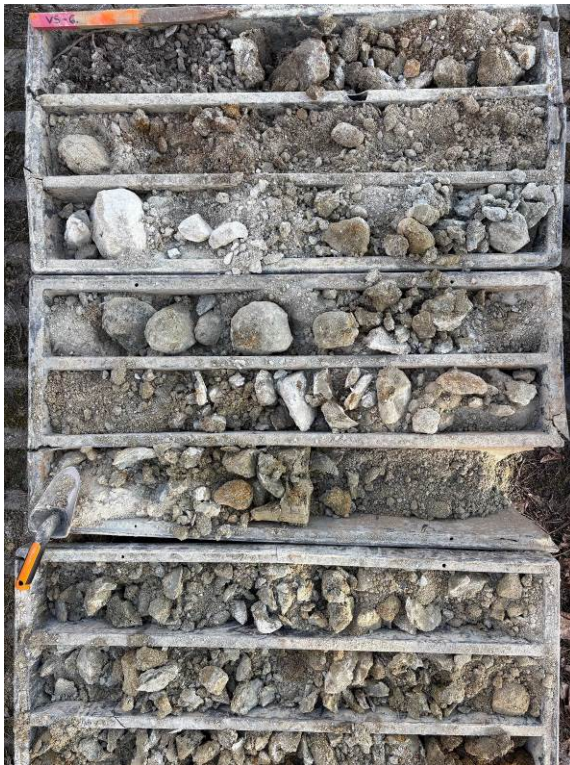
FOTO 16, 17 Vrtaná sonda VS-6, hĺbka 0-8 m a 8-14 m, vrtný výnos kvartérnych a neogénnych sedimentov
