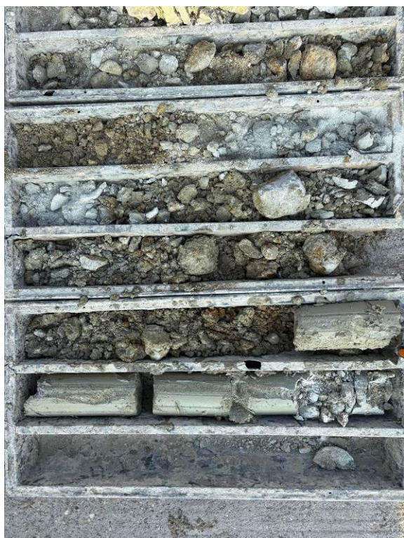
FOTO 24, 25 Vrtaná sonda VS-10, hĺbka 0-8 m a 8-14 m, vrtný výnos kvartérnych a neogénnych sedimentov
