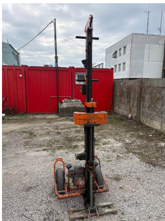
Foto 30 Dynamická penetračná sonda PS-9, súprava Lindenmeyer
