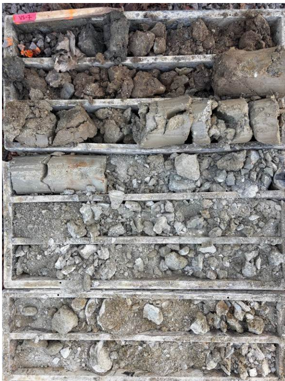
FOTO 18, 19 Vrtaná sonda VS-7, hĺbka 0-8 m a 8-14 m, vrtný výnos kvartérnych a neogénnych sedimentov
