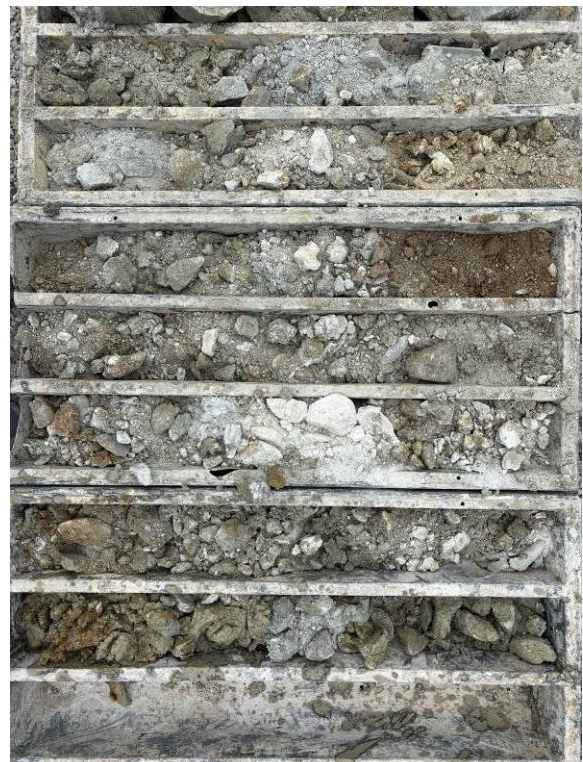
FOTO 22, 23 Vrtaná sonda VS-9, hĺbka 0-8 m a 8-14 m, vrtný výnos kvartérnych a neogénnych sedimentov
