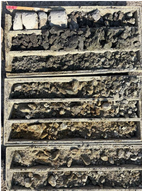
FOTO 20, 21 Vrtaná sonda VS-8, hĺbka 0-8 m a 8-14 m, vrtný výnos kvartérnych a neogénnych sedimentov
