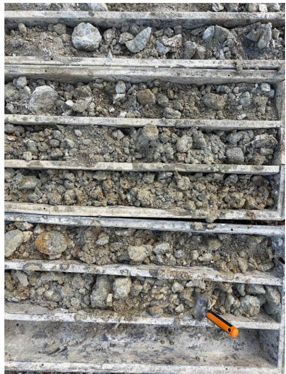
FOTO 18, 19 Vrtaná sonda VS-7, hĺbka 0-8 m a 8-14 m, vrtný výnos kvartérnych a neogénnych sedimentov
