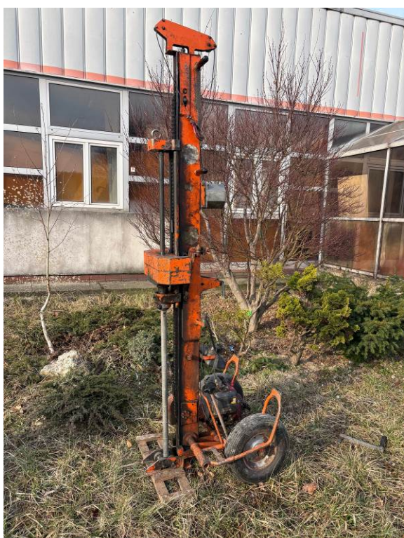
Foto 26, 27 Dynamická penetračná sonda PS-1 a PS-4, súprava Lindenmeyer
