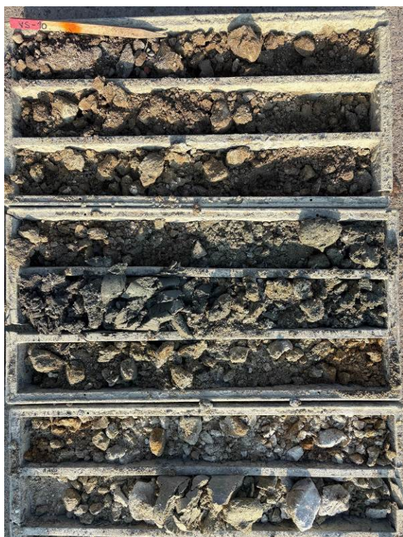
FOTO 24, 25 Vrtaná sonda VS-10, hĺbka 0-8 m a 8-14 m, vrtný výnos kvartérnych a neogénnych sedimentov
