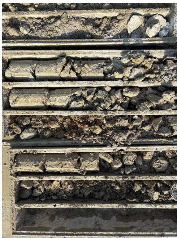
FOTO 12, 13 Vrtaná sonda VS-4, hĺbka 0-8 m a 8-14 m, vrtný výnos kvartérnych a neogénnych sedimentov
