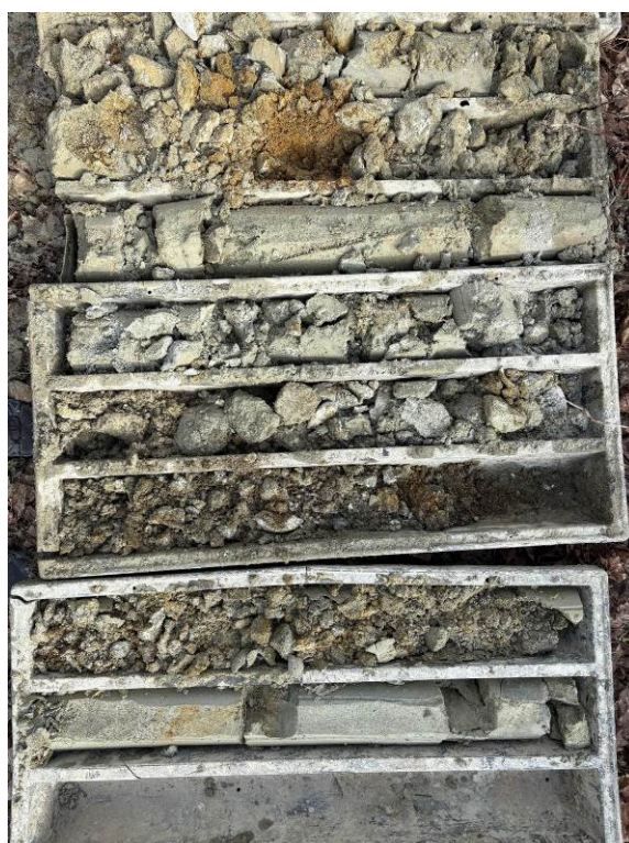
FOTO 14, 15 Vrtaná sonda VS-5, hĺbka 0-8 m a 8-14 m, vrtný výnos kvartérnych a neogénnych sedimentov
