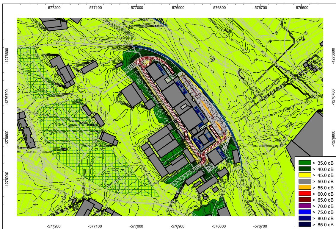
Obr. 20 Plošná hluková záťaž vypočítaná vo výške 1,5 m nad terénom vo večernom referenčnom časovom intervale – samostatná prevádzka posudzovaného zámeru
