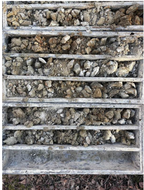
FOTO 16, 17 Vrtaná sonda VS-6, hĺbka 0-8 m a 8-14 m, vrtný výnos kvartérnych a neogénnych sedimentov
