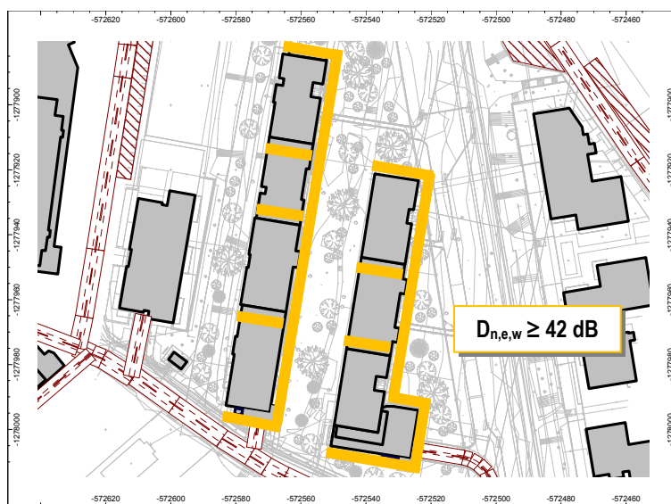
Obr. 43 Odporúčaný rozsah použitia vetracích akustických štrbín a ich minimálna hodnota D_{n,e,w}
