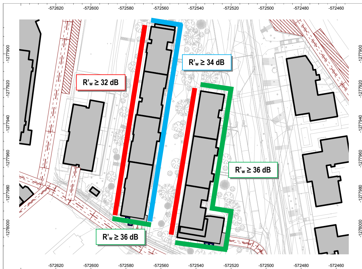
Obr. 42 Situácia stavby a minimálne odporúčané hodnoty zvukovej izolácie obvodového plášťa v miestach vnútorných chránených priestorov (platí aj pre okná ako celok, nie pre izolačné sklá)
