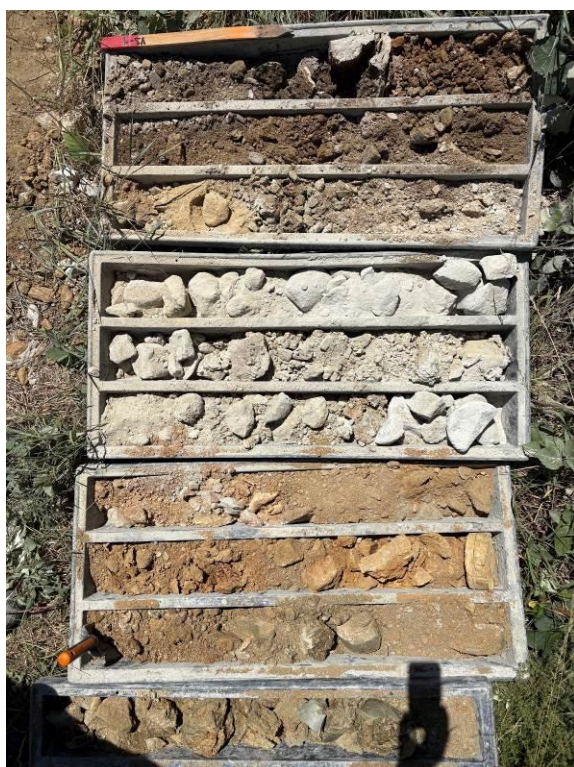
FOTO 3, 4 Vŕtaná sonda VS-1 a VS-2, výnos jadra, hĺbka 10,00 m
