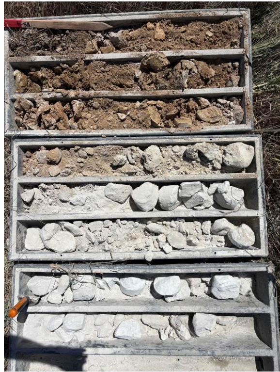
FOTO 5, 6 Víťaná sonda VS-3 a VS-4, výnos jadra, hĺbka 10,00 m a 8,00 m
