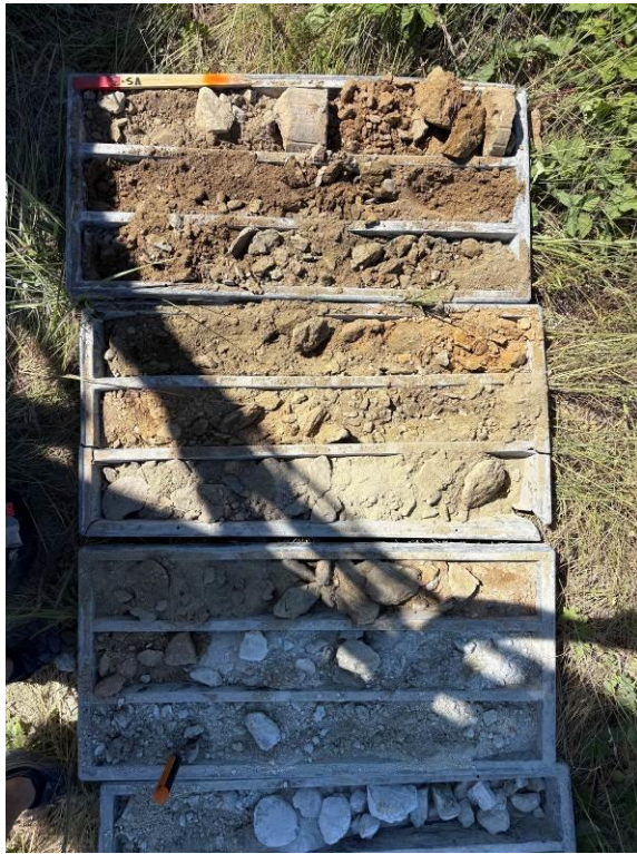
FOTO 5, 6 Víťaná sonda VS-3 a VS-4, výnos jadra, hĺbka 10,00 m a 8,00 m
