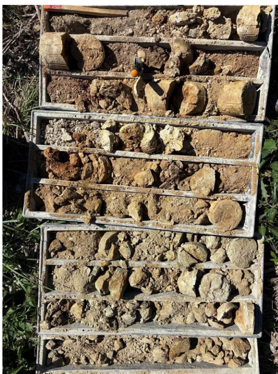
FOTO 3, 4 Vŕtaná sonda VS-1 a VS-2, výnos jadra, hĺbka 10,00 m
