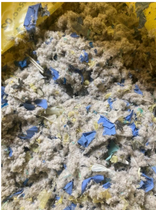
Obrázok 6 | Dekontaminovaný odpad zo zariadenia SW (Zdroj: Nemocnica Havířov)
