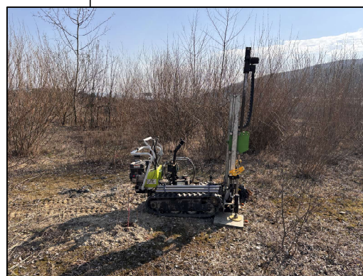
Foto 01: Dynamická penetračná sonda DP-3
