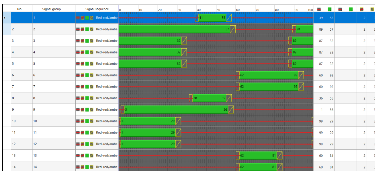
Obrázok 19 Signálny plán križovatky Prievozská - Bajkalská pre rannú špičkovú hodinu
