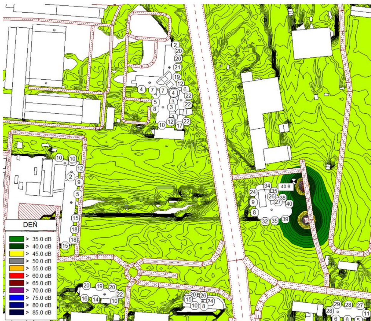
Obrázok 23 Plošná hluková záťaž spôsobená statickou dopravou vypočítaná vo výške 1,5 m nad terénom a najvyššie hodnoty L_{Aeq} 2 m pred fasádami posudzovaného objektu a fasádami okolitých budov a hodnota L_{Aeq} v pozorovacom bode umiestnenom v mieste oddychovej zóny pre referenčný časový interval DEŇ
