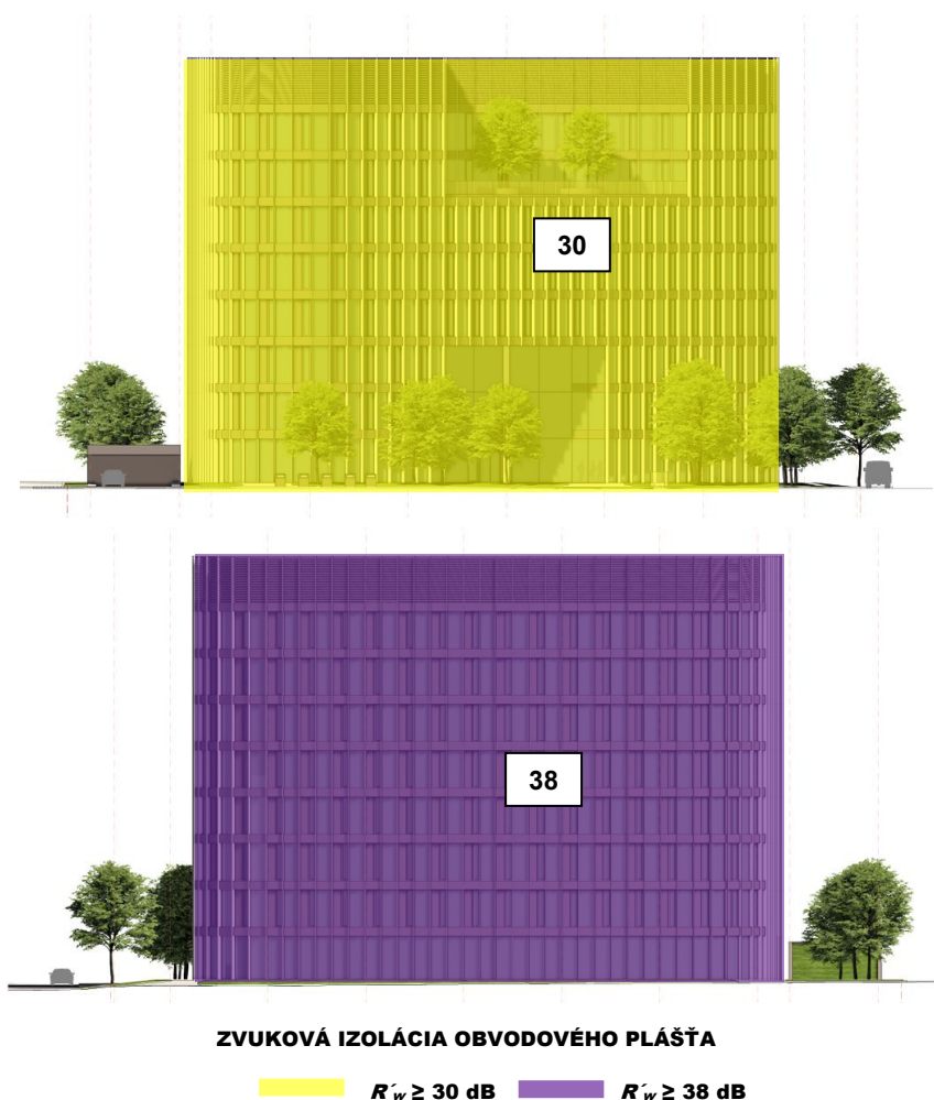
Obrázok 30 Návrh zvukovej izolácie obvodového plášťa administratívnej budovy východný pohľad (hore) a západný pohľad (dole)
