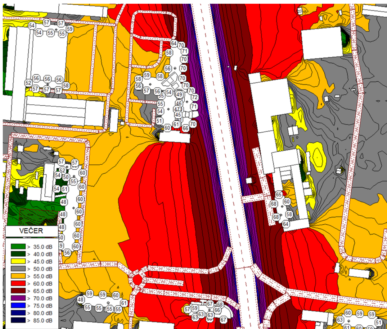
Obrázok 20 Plošná hluková záťaž spôsobená pozemnou dopravou v súčasnom stave vypočítaná vo výške 1,5 m nad terénom a najvyššia hodnota L_{Aeq} 2 m pred fasádami okolitých budov a hodnota L_{Aeq} v pozorovacom bode umiestnenom na streche terajšieho objektu pre referenčný časový interval VEČER
