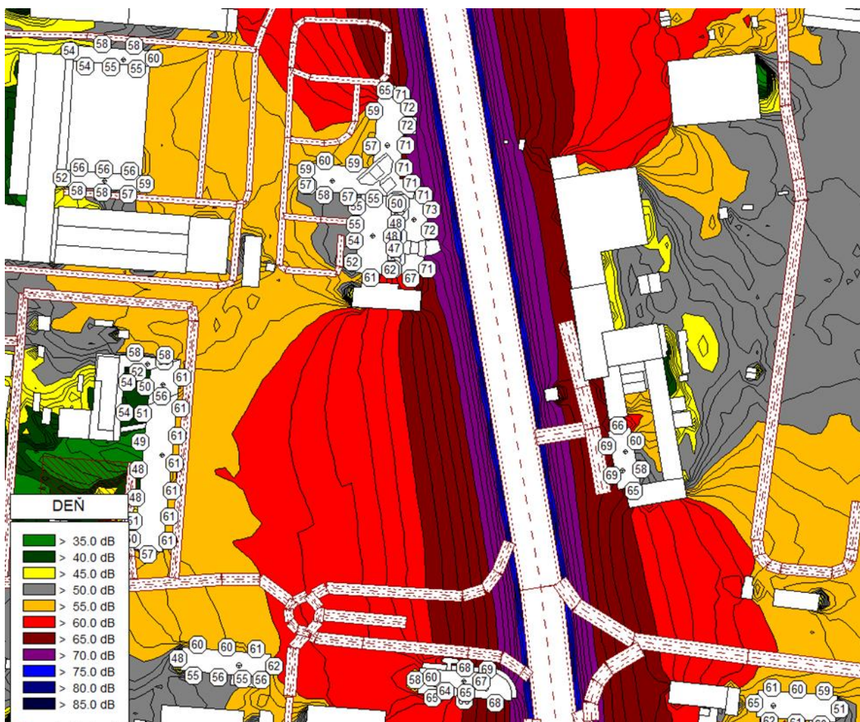
Obrázok 19 Plošná hluková záťaž spôsobená pozemnou dopravou v súčasnom stave vypočítaná vo výške 1,5 m nad terénom a najvyššia hodnota L_{Aeq} 2 m pred fasádami okolitých budov a hodnota L_{Aeq} v pozorovacom bode umiestnenom na streche terajšieho objektu pre referenčný časový interval DEŇ
