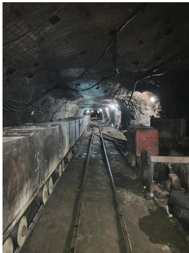
Foto č. 13: Doprava vozíkovým obehom – v podzemí
