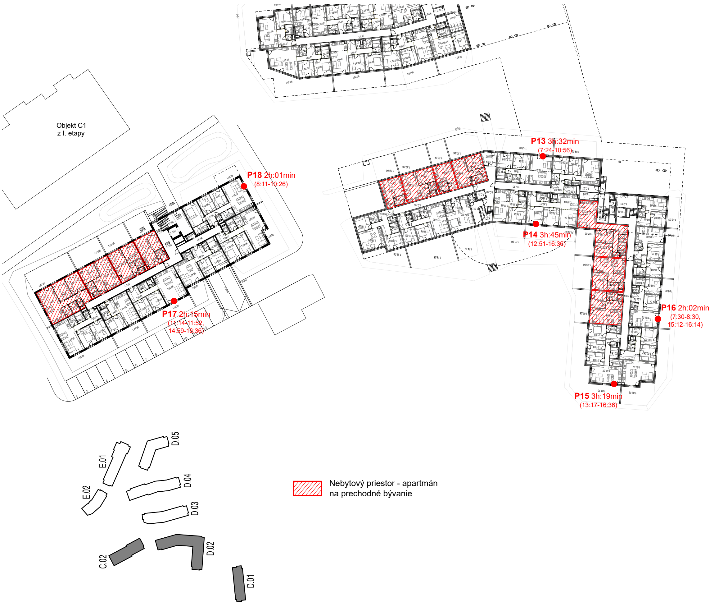
Obr. 9 Pôdorys 1.NP objektov D.01, D.02 a C.02 a hodnoty preslnenia posudzovaných kontrolných bodov
