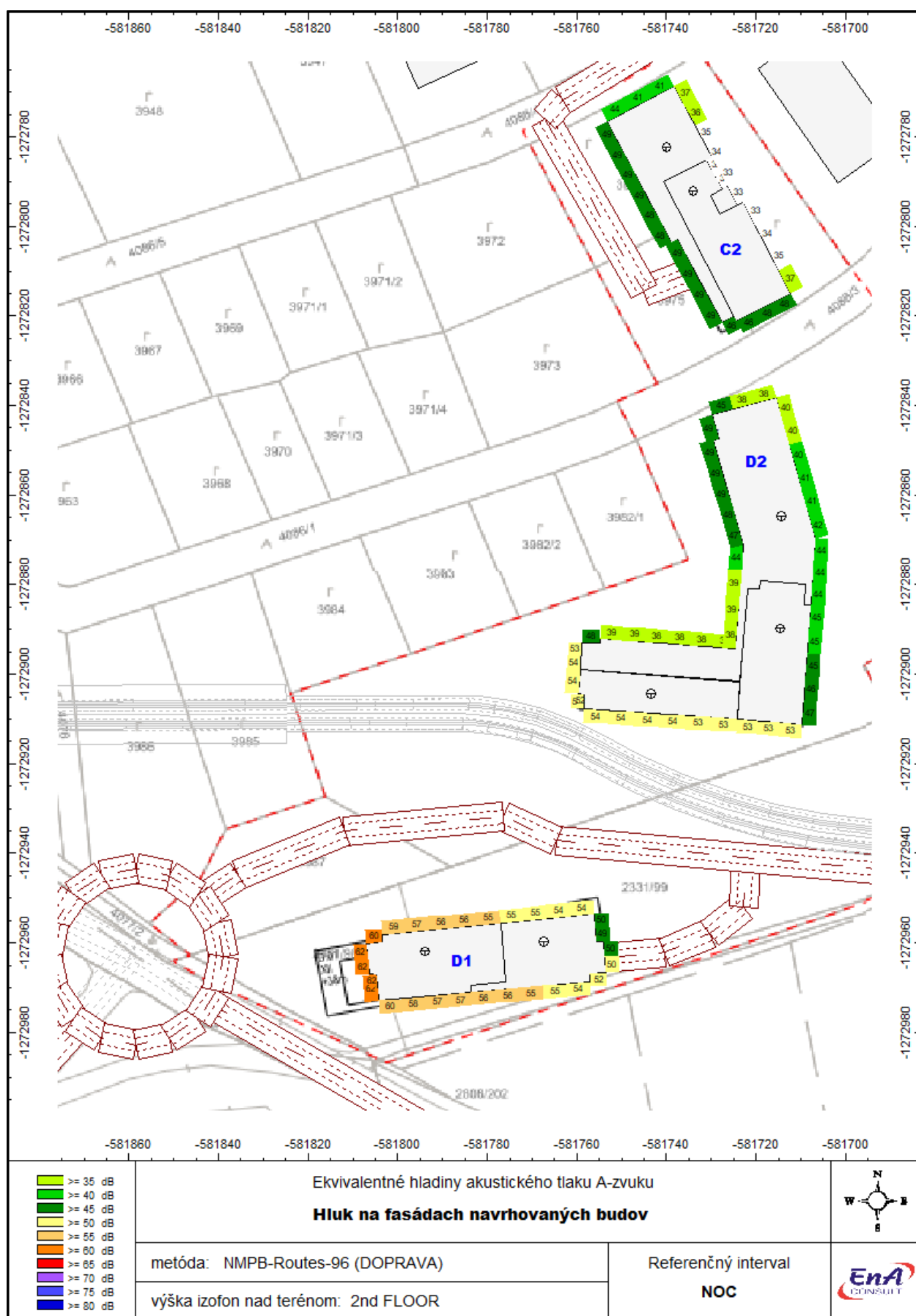
Obr. 10a Hladiny hluku L_{Aeq,8h} na fasádach budov C2, D1 a D2 vo výške 2.NP
