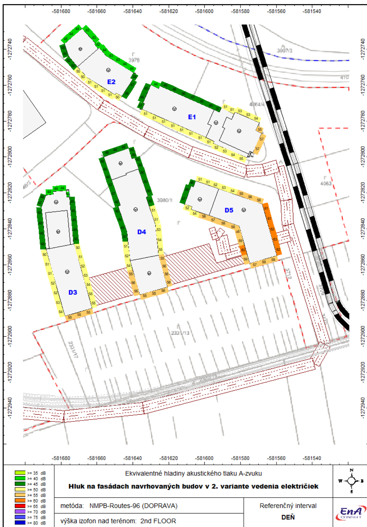
Obr. 11c Hladiny hluku L_{Aeq,12h} na fasádach budov D3, D4, D5, E1 a E2 vo výške 2.NP
