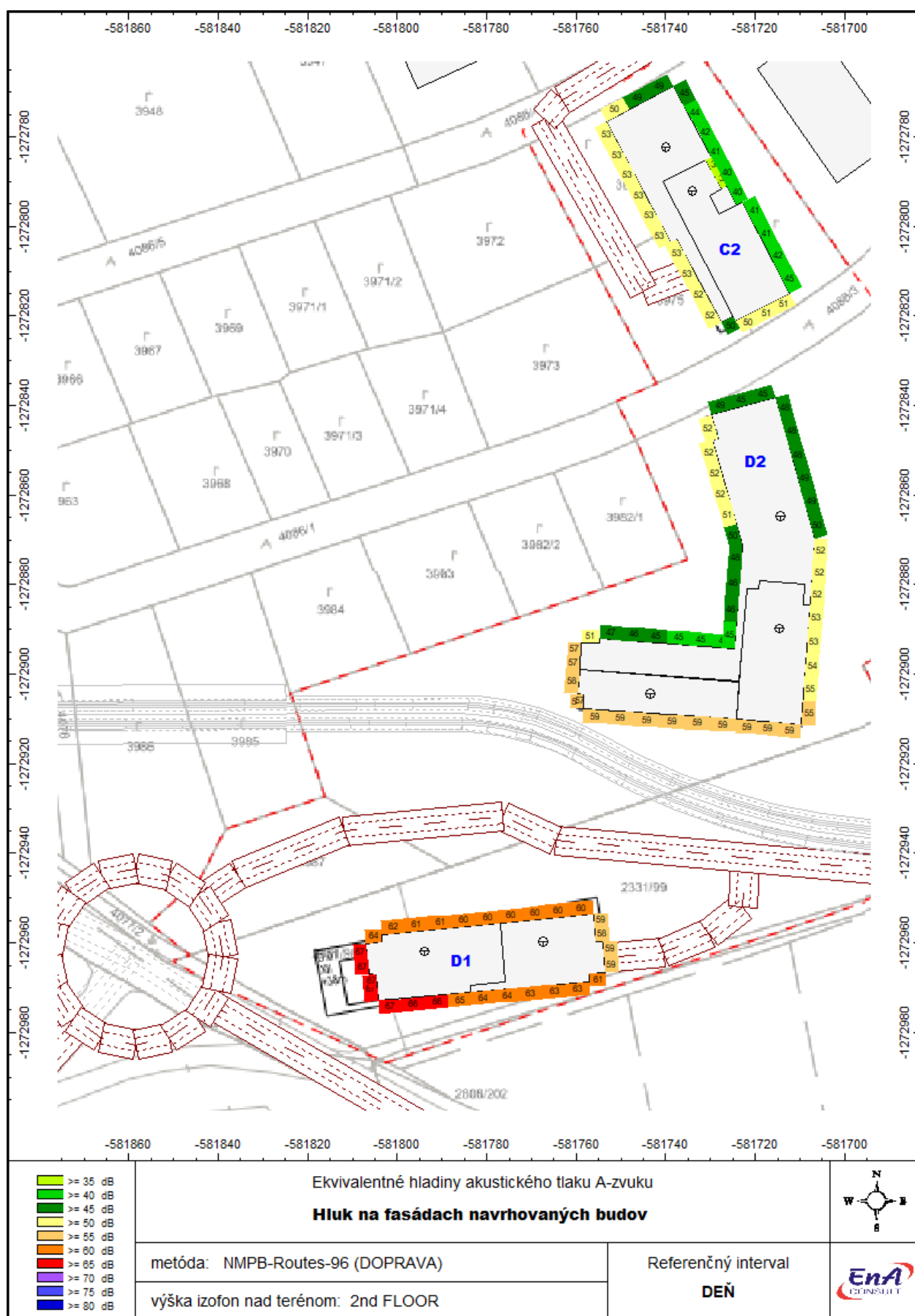
Obr. 9a Hladiny hluku L_{Aeq,12h} na fasádach budov C2, D1 a D2 vo výške 2.NP
