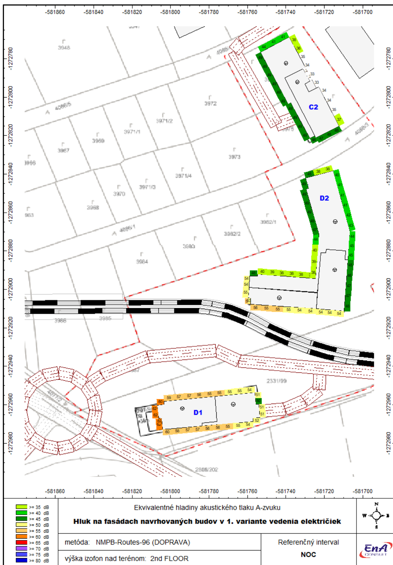
Obr. 10b Hladiny hluku L_{Aeq,4h} na fasádach budov C2, D1 a D2 vo výške 2.NP
