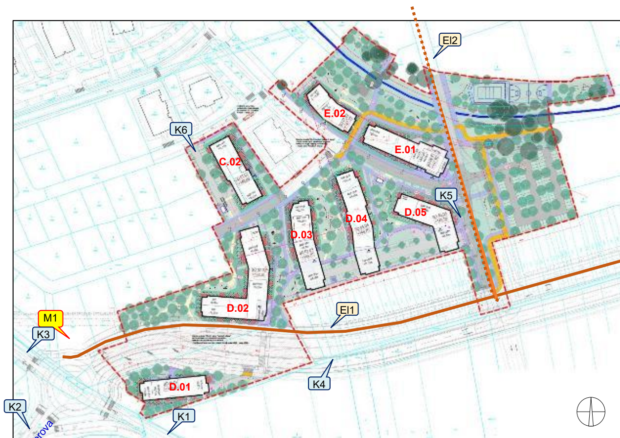
Obr. 1: Situačná schéma zastavanosti územia, M1 - miesto merania hluku, K1..K6 – cestné líniové zdroje hluku, EI1..EI2 – výhľad vedenia električky vo variante 1 alebo 2
