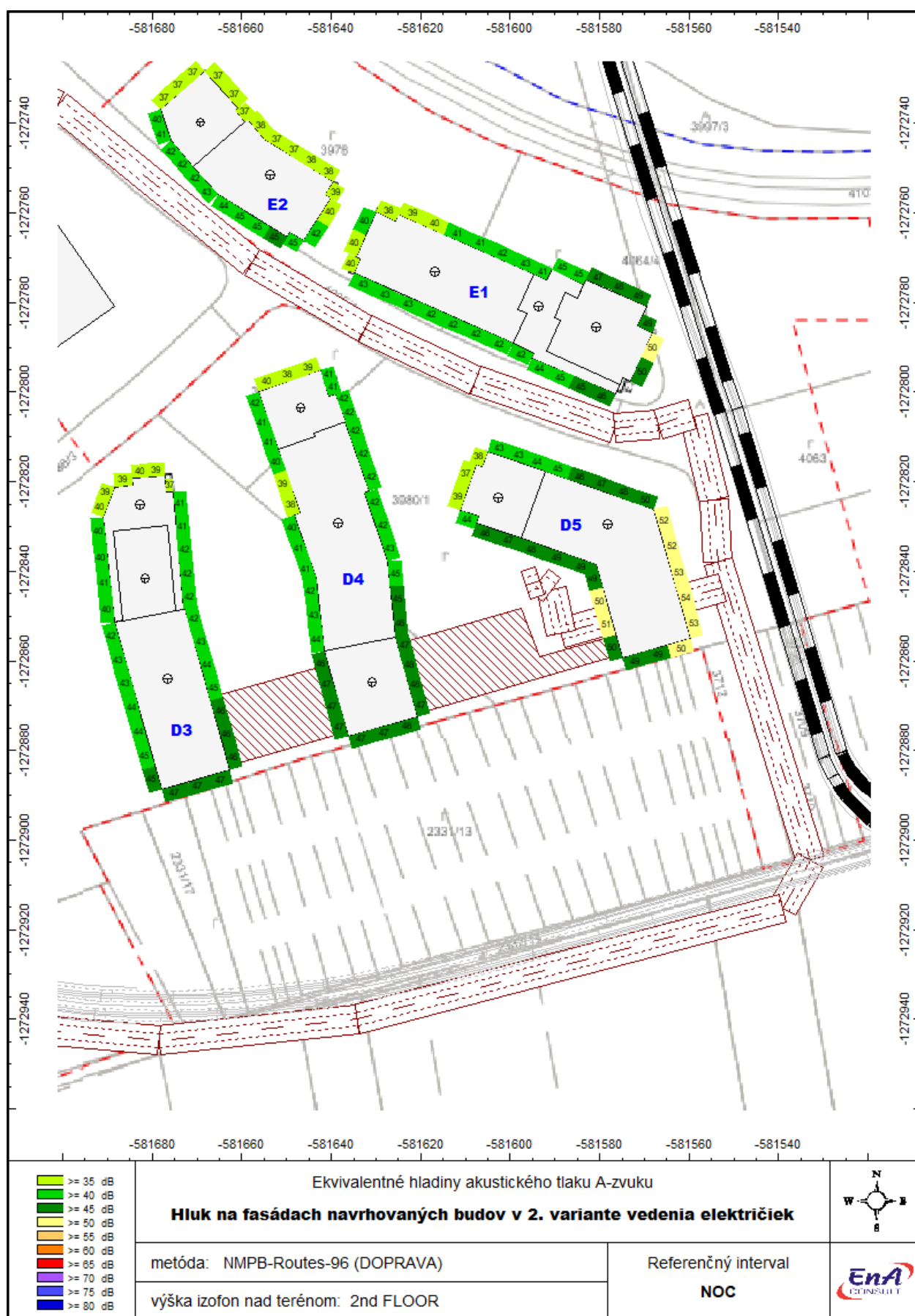
Obr. 12c Hladiny hluku L_{Aeq,4h} na fasádach budov D3, D4, D5, E1 a E2 vo výške 2.NP
