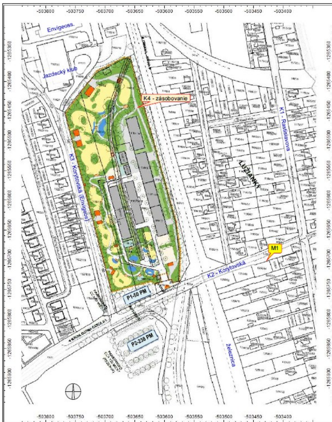
Obr. 1: Situačná schéma zastavanosti územia, K1..K4 –liniové zdroje hluku, P1..P2 – plošný zdroj hluku
