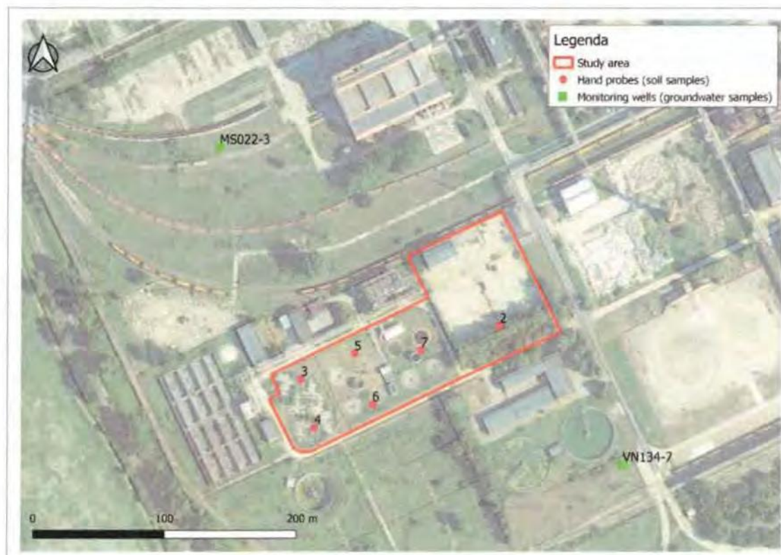
Obrázok 5: Situácia ručných sond a existujúcich monitorovacích vrtov
