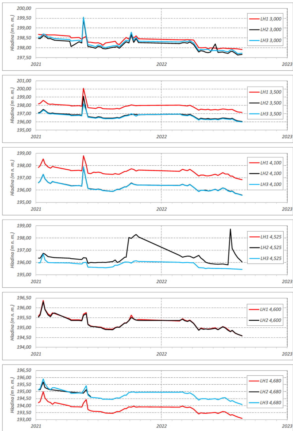
Obr. č. 30 Režim podzemnej vody v pozorovacích objektoch EH prírodného kanála
