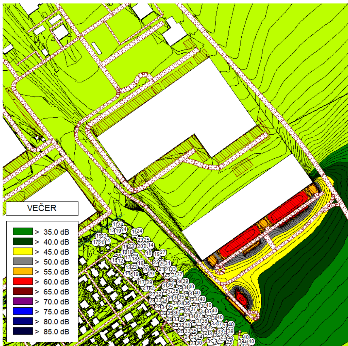
Obrázok 17 Plošná hluková záťaž spôsobená statickou dopravou vypočítaná vo výške 1,5 m nad terénom a najvyššie vypočítané hodnoty ekvivalentnej hladiny A zvuku L_{Aeq} 2 m pred fasádami okolitých rodinných domov, pre referenčný časový interval VEČER
