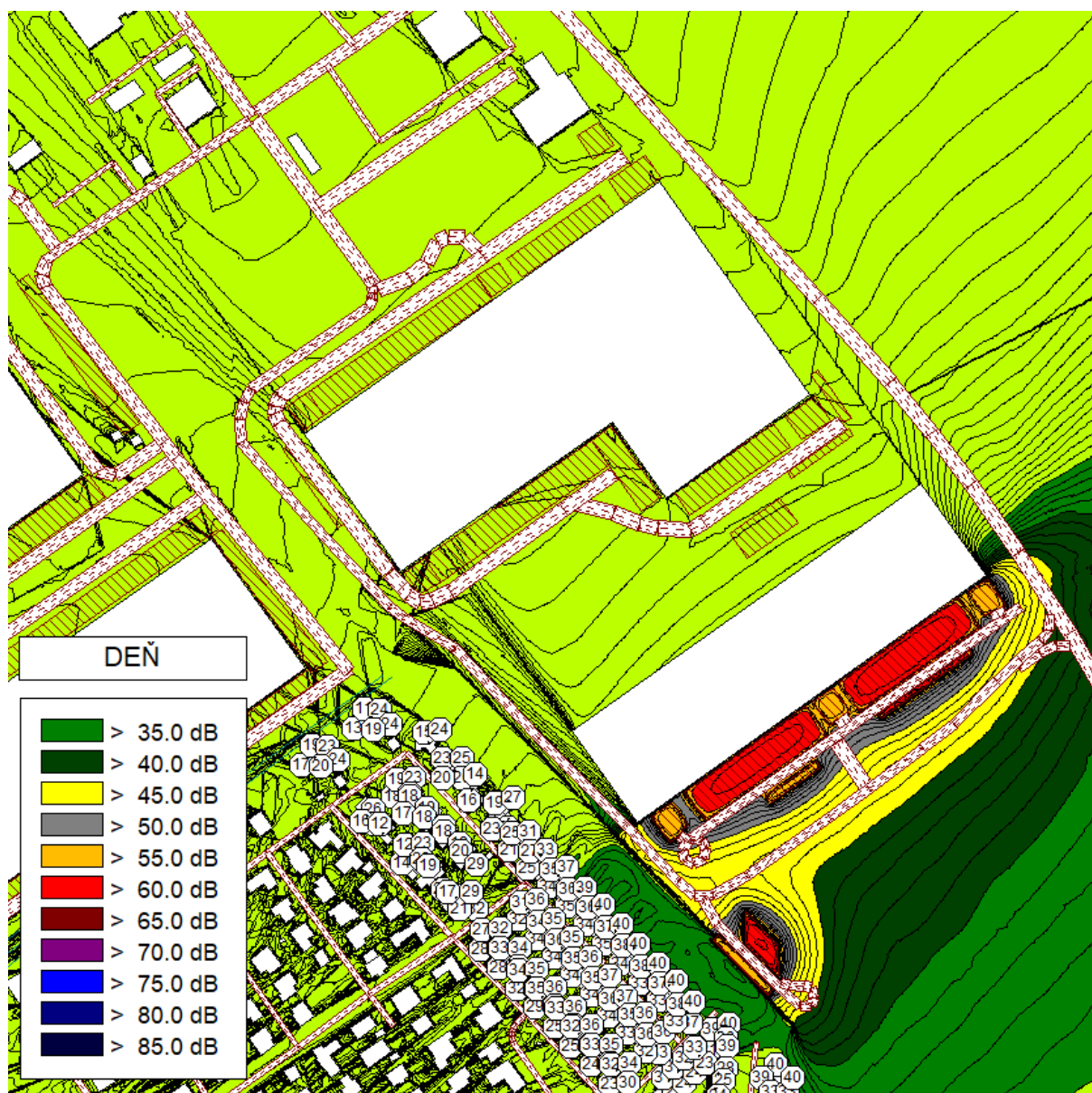
Obrázok 16 Plošná hluková záťaž spôsobená statickou dopravou vypočítaná vo výške 1,5 m nad terénom a najvyššie vypočítané hodnoty ekvivalentnej hladiny A zvuku L_{Aeq} 2 m pred fasádami okolitých rodinných domov, pre referenčný časový interval DEŇ
