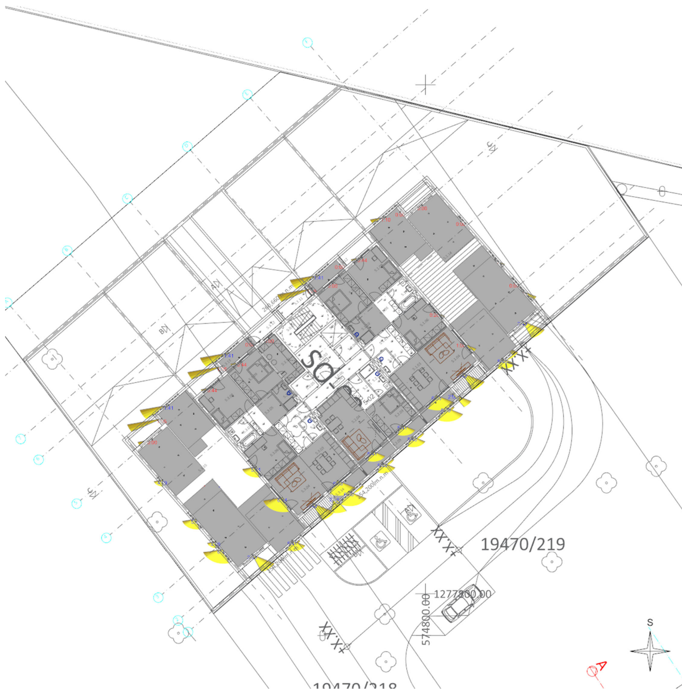
▪ Obr 9. Situačná schéma s vyznačením doby preslnenia dňa 21.marca a 22.septembra.
