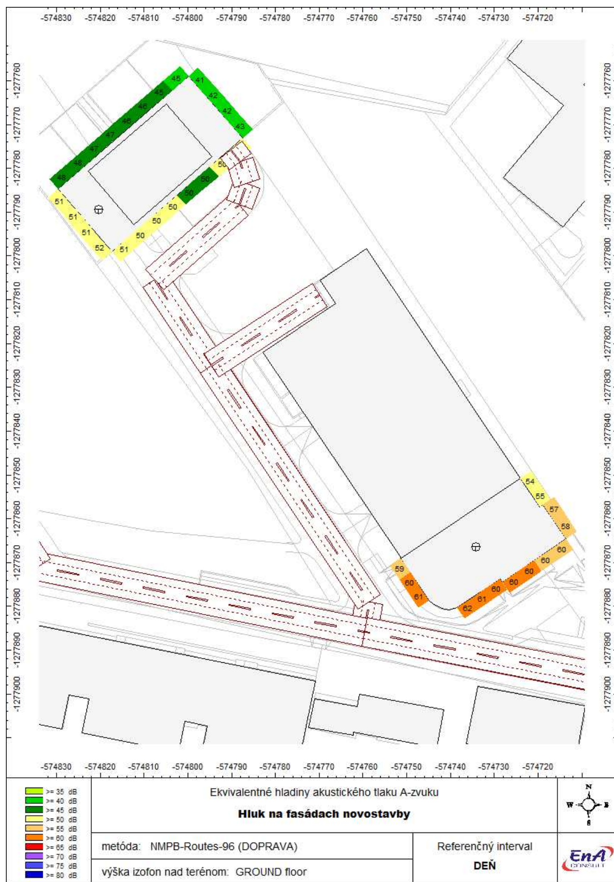
Obr. 9 Hladiny hluku L_{Aeq,12h} na fasádach budov vo výške 1.NP
