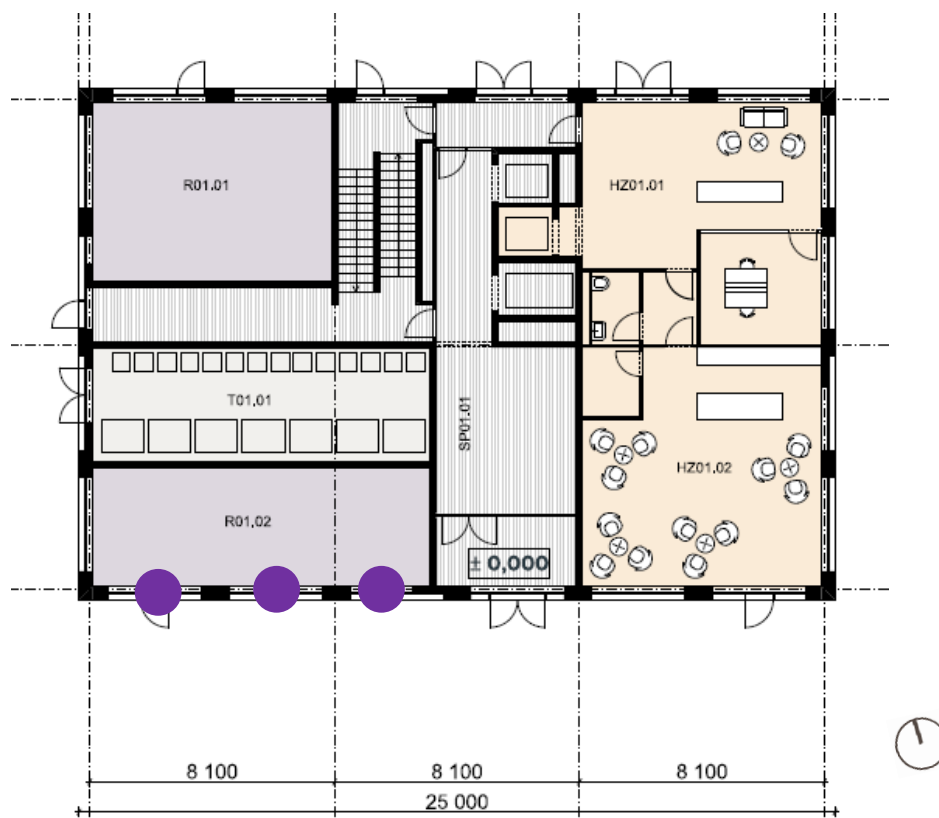
Obr. 13: Pôdorys 1.NP navrhovaného objektu: Polyfunkčný objekt Millhaus (zdroj: objednávateľ)
