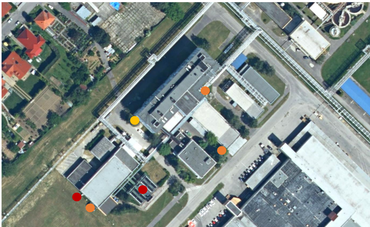
OBR. 7 Dispozícia umiestnenia zdrojov zvuku v areáli prevádzky – žltými bodmi sú vyznačené čerpadlá, oranžovými bodmi – výduchy, červenými bodmi – vzduchotechnické jednotky
