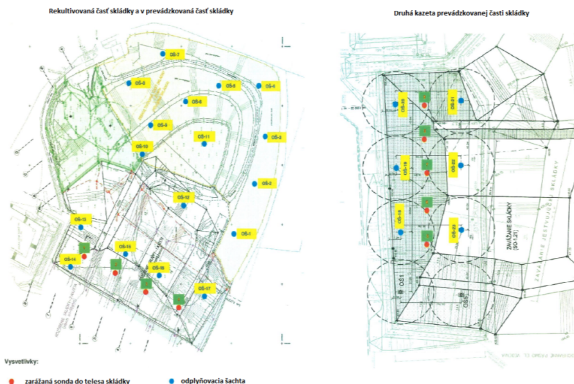
Obr. 7 - Situácia rozmiestnenia narážaných sond a odplyňovacích šácht
