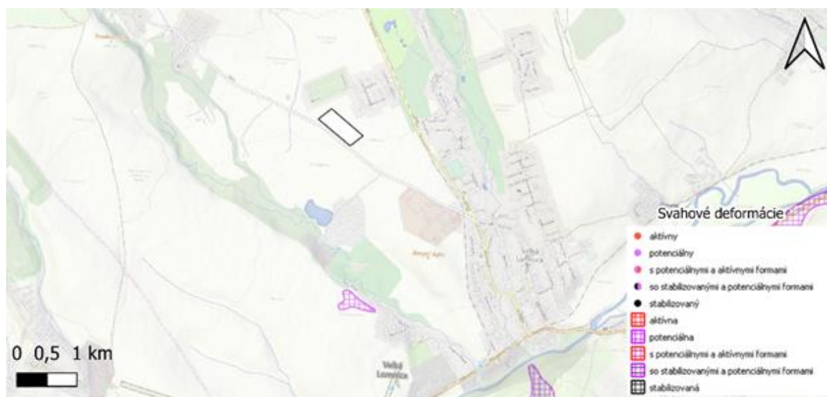
Obr. 8 Svahové deformácie územia zámeru (zdroj: https://app.geology.sk/atlassd/ ).
