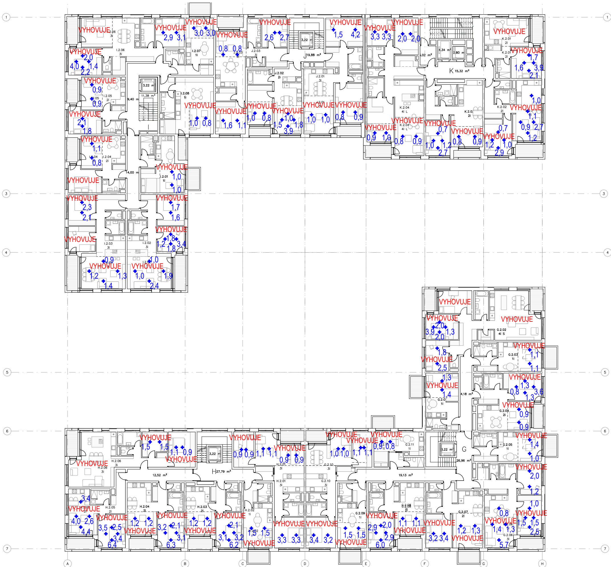
Obr. 10 Pôdorys 2.NP sekcií H,G,I,J,K a hodnoty č.d.o. na porovnávacej rovine obytných miestností
