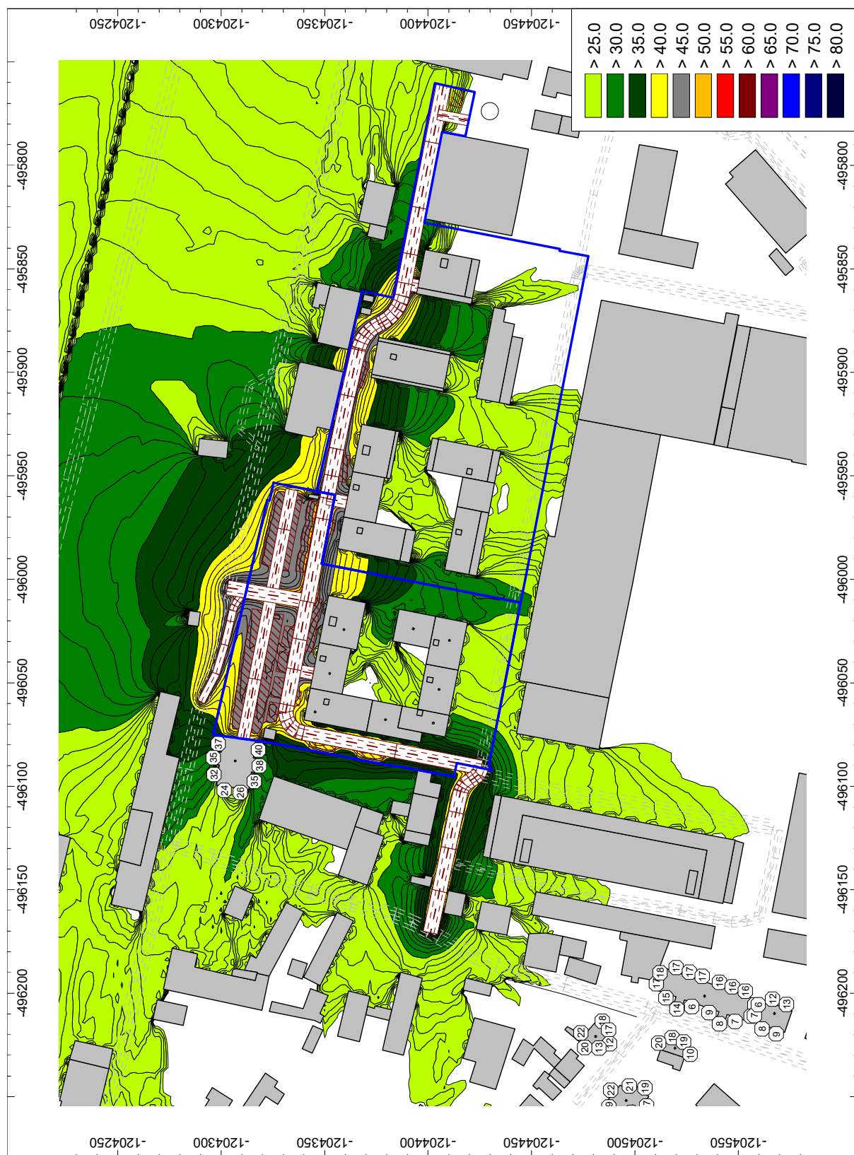
Obr. 36 vypočítaná plošná hluková záťaž vypočítaná vo výške 1,5 m nad terénom a hodnoty L_{Aeq} pred fasádami najbližších chránených objektov pre nočný referenčný čas
