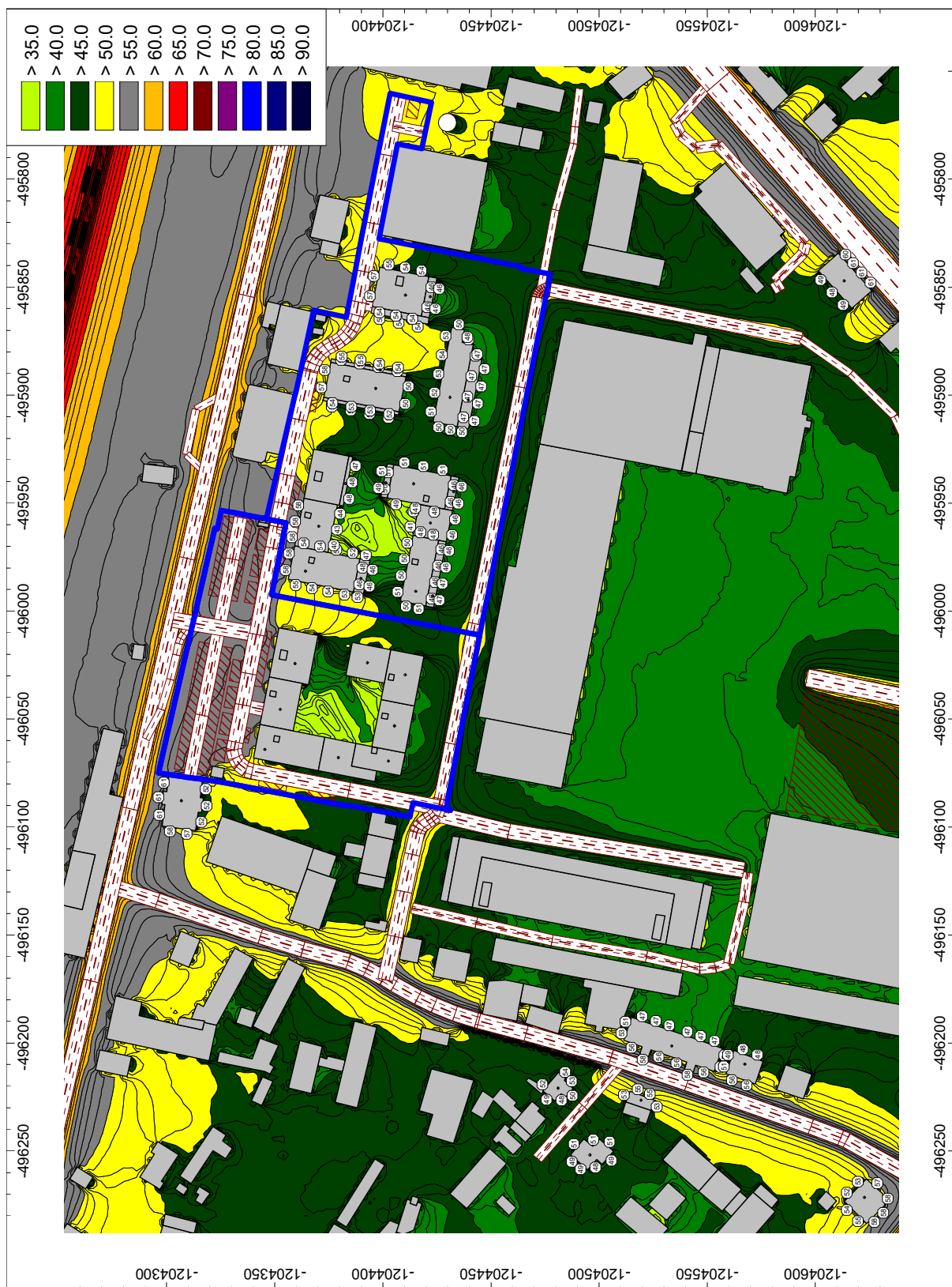
Obr. 42 hluková záťaž vypočítaná vo výške 1,5 m nad terénom, pre nočný referenčný časový interval a hodnoty ekvivalentných hladín A zvuku pred fasádami najbližších chránených objektov, delenie pásiem po 5 dB
