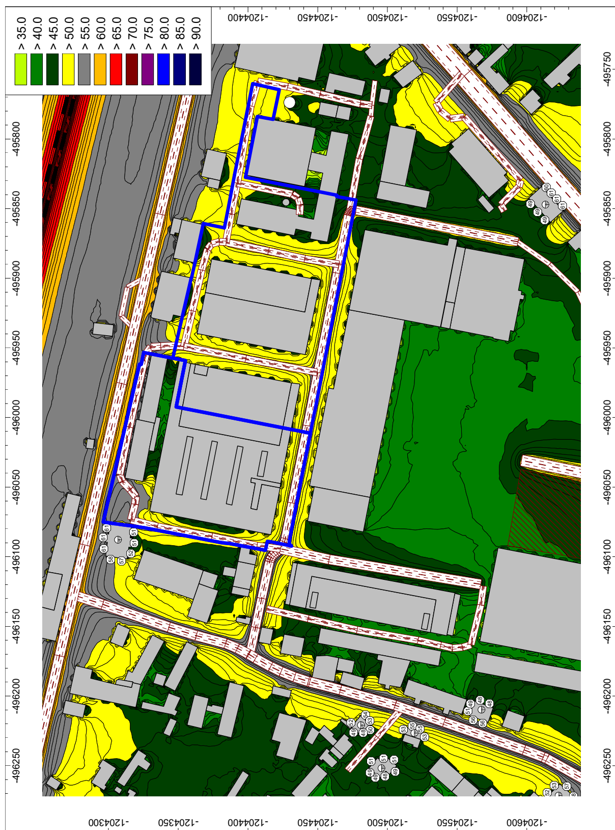
Obr. 39 hluková záťaž vypočítaná vo výške 1,5 m nad terénom, pre nočný referenčný časový interval a hodnoty ekvivalentných hladín A zvuku pred fasádami najbližších chránených objektov, delenie pásiem po 5 dB
