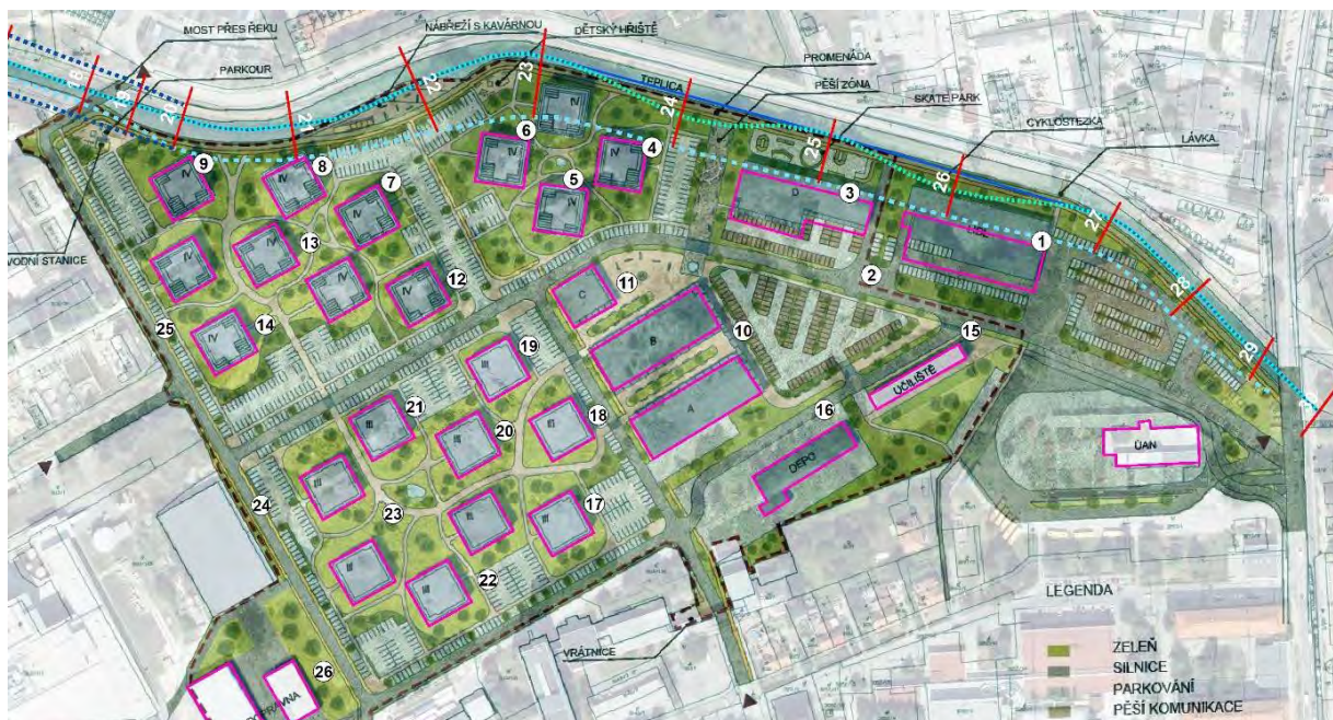
Obr. 10.10 Rozmiestnenie referenčných bodov pre definovanie výšky povodňovej hladiny na území Novej Hodvábky
