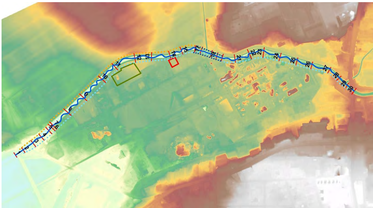
Obr. 9.3 Navrhnutá trasa s pravidelným zakrivením, Alternatíva C – celý riešený úsek
