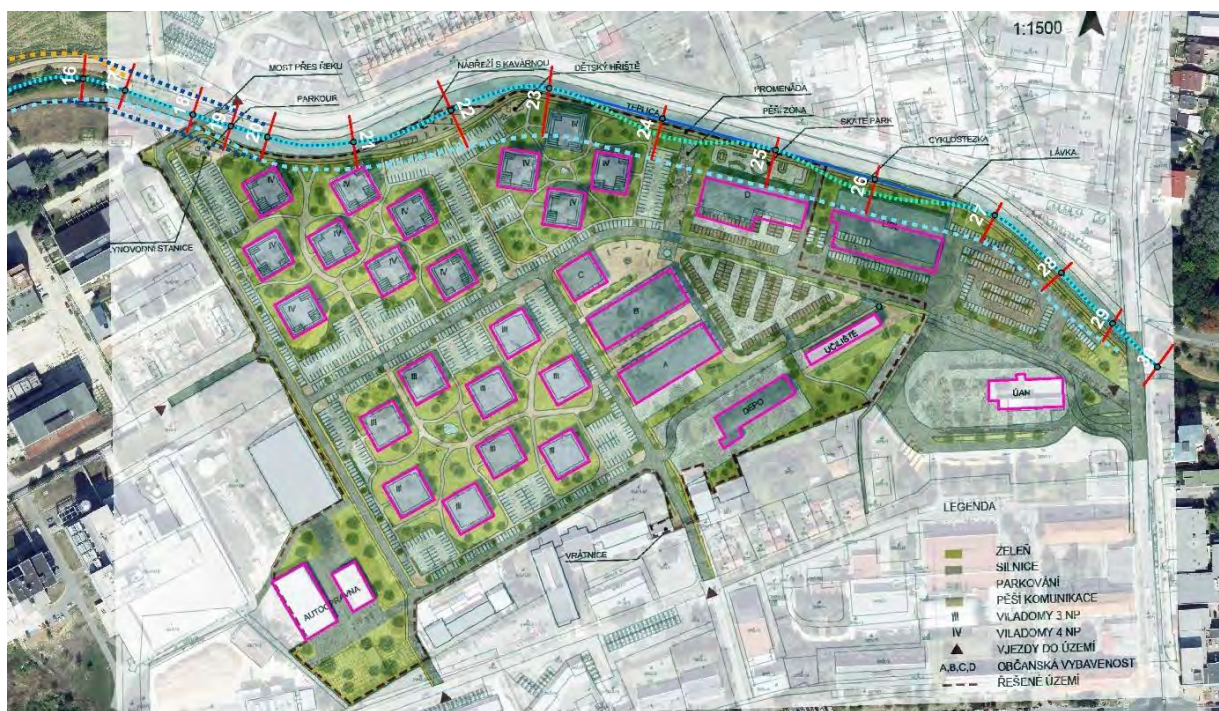
Obr. 10.9 Rozmiestnenie kontrolných priečných profilov v koryte Teplice v primárnom záujmovom území Novej Hodvábky
