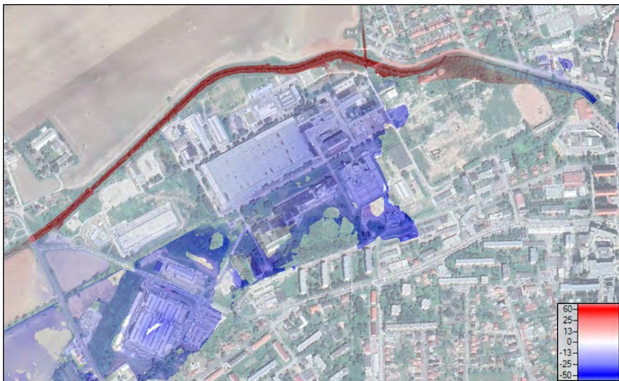
Obrázek 4.5 – Rozdílová mapa hladin za současného a návrhového stavu v cm
