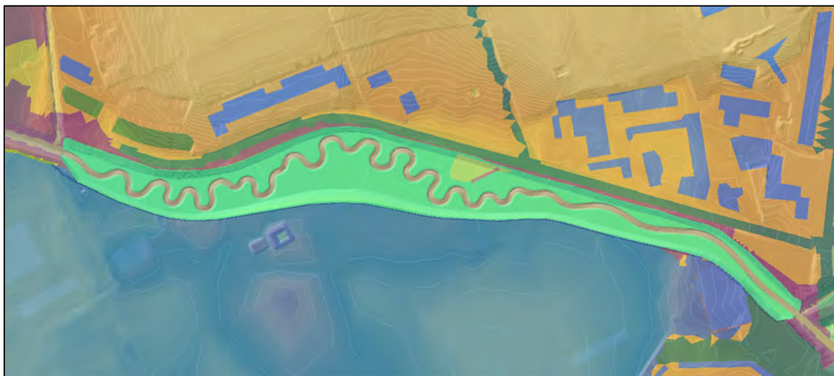
Obrázek 4.4 – Prostorové rozložení drsnostních součinitelů
