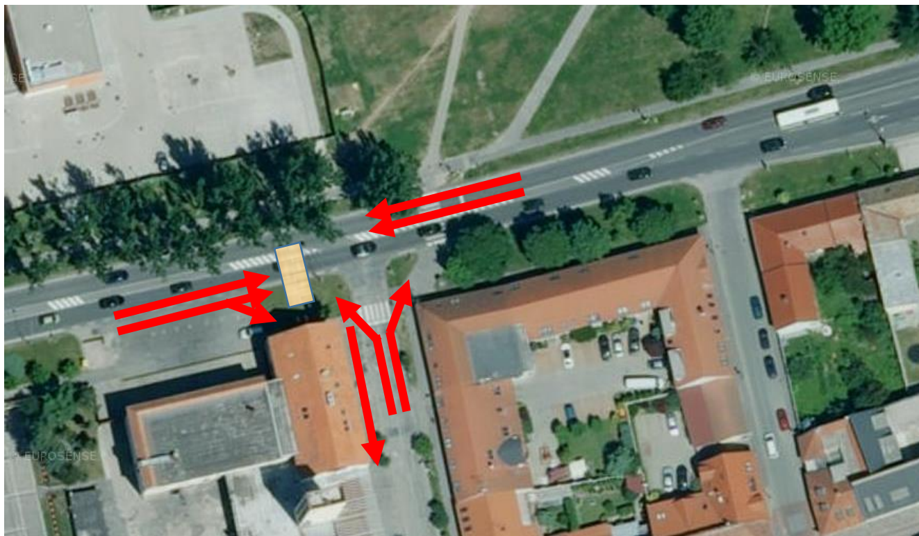
Obrázok 33 - Schéma dopravných smerov v križovatke Rybníková – Jerichova (definitívny stav)
