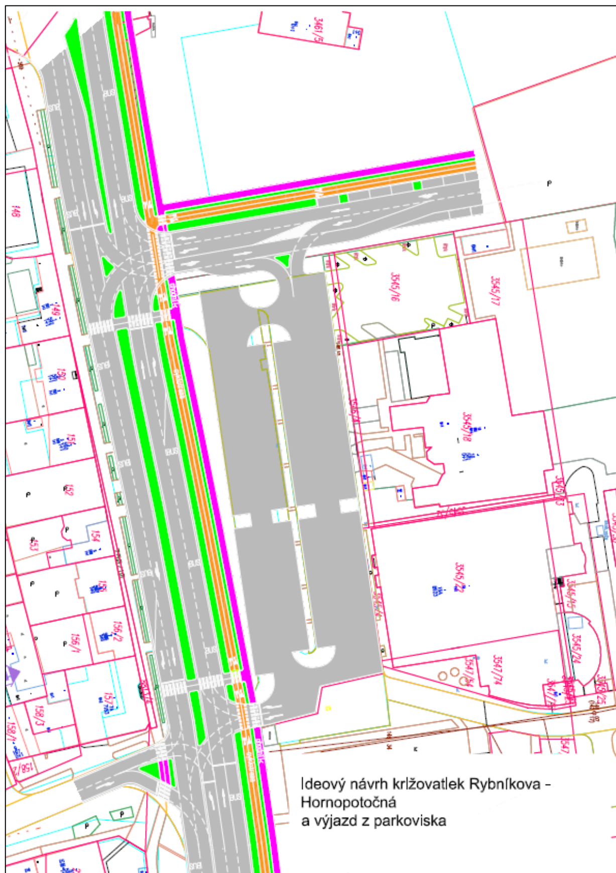
Obrázok 26 – Ideový návrh napojenia parkoviska Rybníkova + Zóna Cukrovar (definitívny stav – Rybníková ul. ako 4-pruh)
