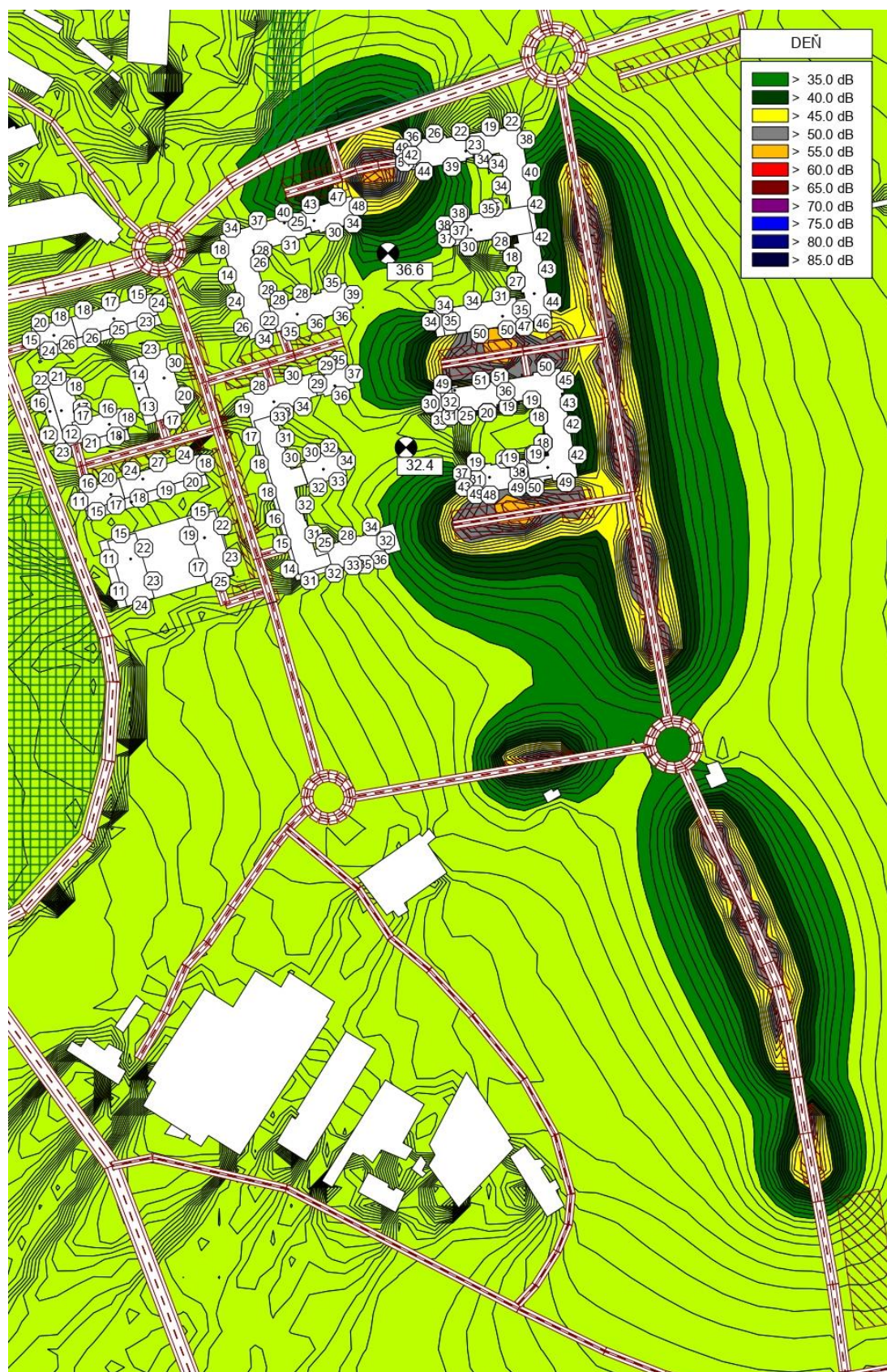
Obrázok 30 Plošná hluková záťaž spôsobená statickou dopravou vypočítaná vo výške 1,5 m nad terénom a najvyššie hodnoty L_{Aeq} 2 m pred fasádami objektov A3 a A4 Obytnéj zóny Cukrovar a fasádami okolitých budov a hodnota L_{Aeq} v pozorovacích bodoch umiestnených v mieste oddychovej zóny pre referenčný časový interval DEŇ
