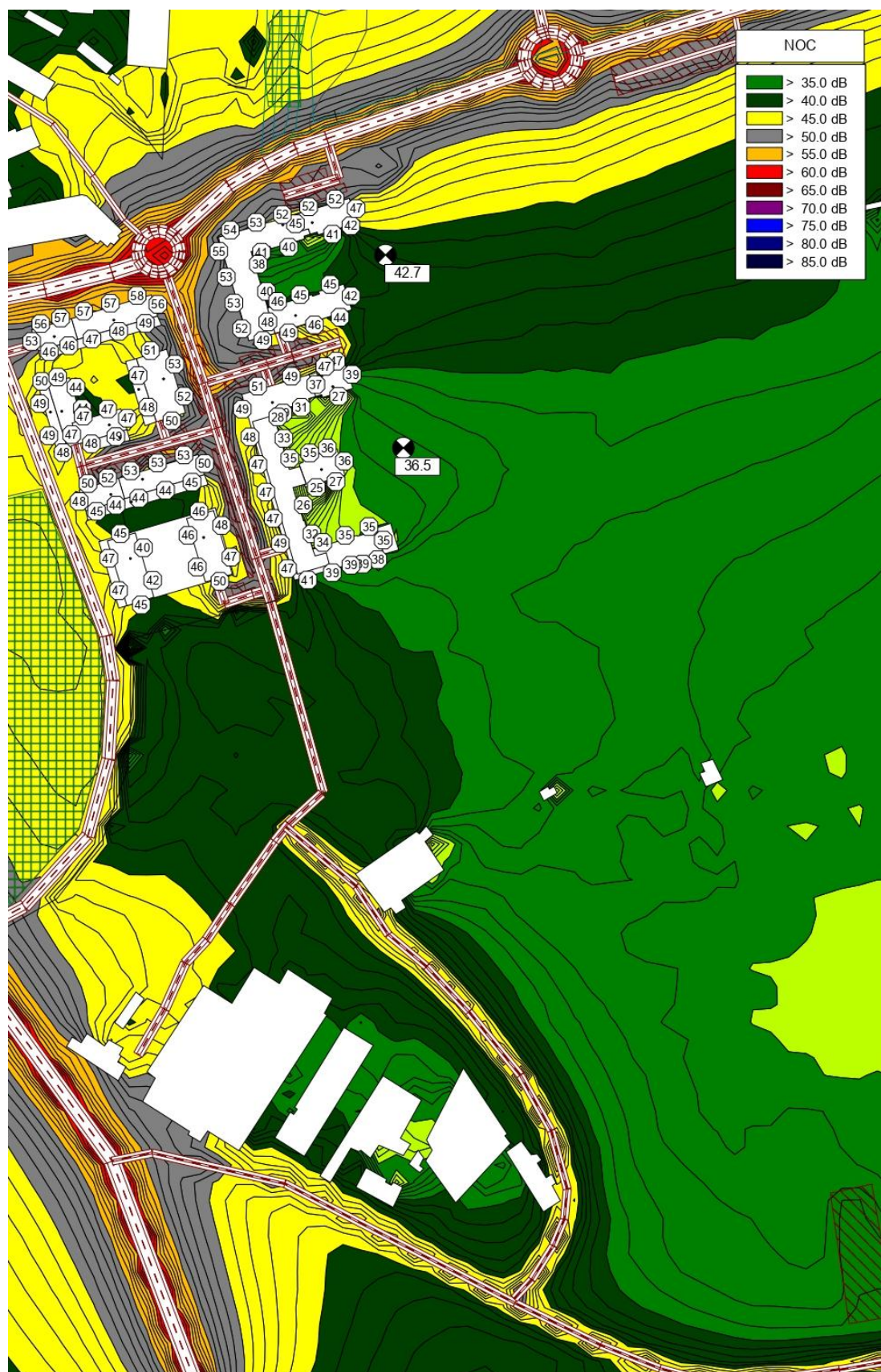
Obrázok 27 Plošná hluková záťaž spôsobená pozemnou dopravou v súčasnom stave vypočítaná vo výške 1,5 m nad terénom a najvyššia hodnota L_{Aeq} 2 m pred fasádami okolitých budov a hodnota L_{Aeq} v pozorovacích bodoch umiestnených v mieste oddychových zón pre referenčný časový interval NOC
