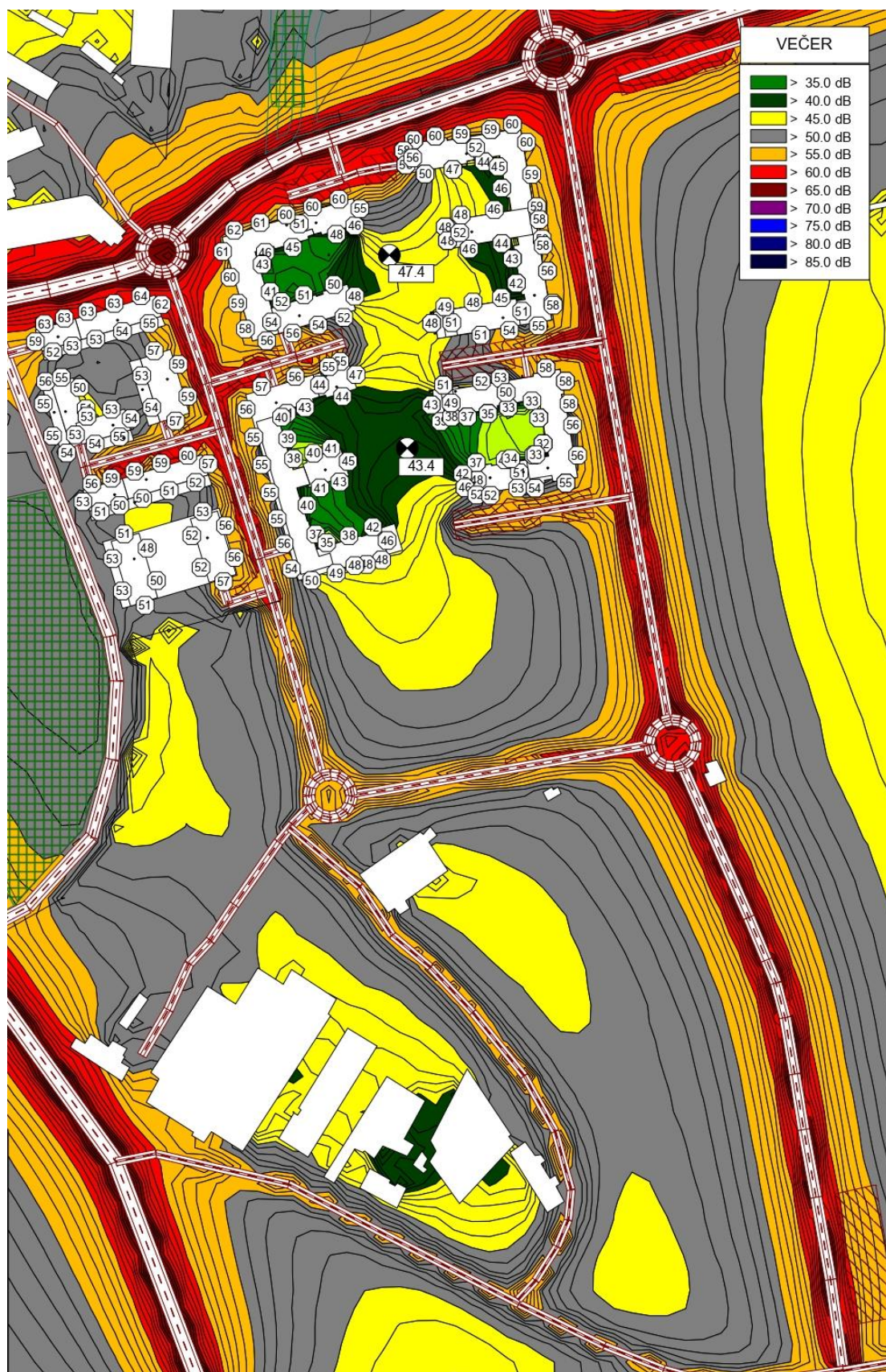
Obrázok 34 Plošná hluková záťaž spôsobená kumulatívnou dopravou vypočítaná vo výške 1,5 m nad terénom a najvyššie hodnoty L_{Aeq} 2 m pred fasádami objektov A3 a A4 Obytnej zóny Cukrovar a fasádami okolitých budov a hodnota L_{Aeq} v pozorovacích bodoch umiestnených v mieste oddychovej zóny pre referenčný časový interval VEČER
