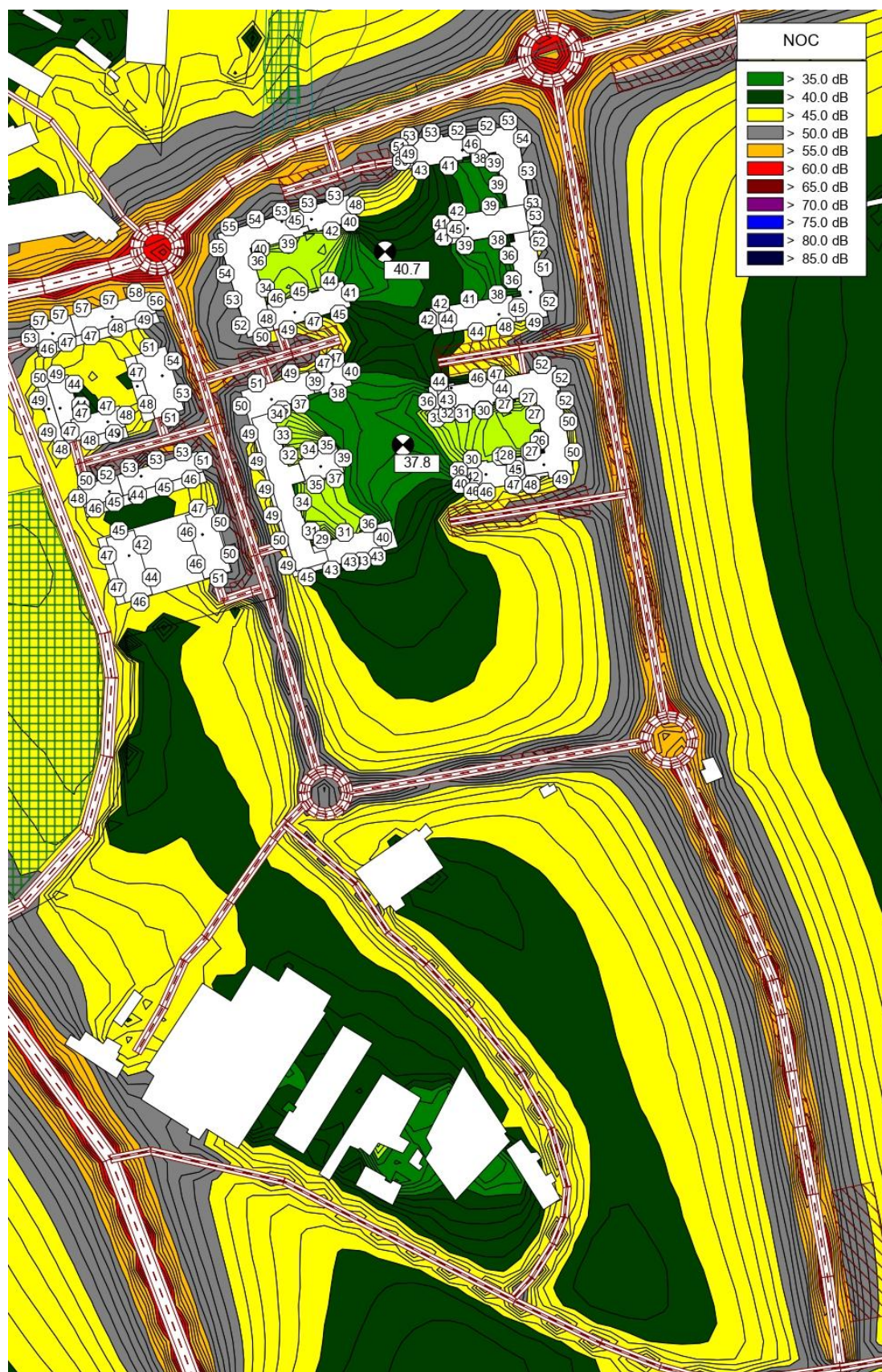
Obrázok 35 Plošná hluková záťaž spôsobená kumulatívnou dopravou vypočítaná vo výške 1,5 m nad terénom a najvyššie hodnoty L_{Aeq} 2 m pred fasádami objektov A3 a A4 Obytnej zóny Cukrovar a fasádami okolitých budov a hodnota L_{Aeq} v pozorovacích bodoch umiestnených v mieste oddychovej zóny pre referenčný časový interval NOC
