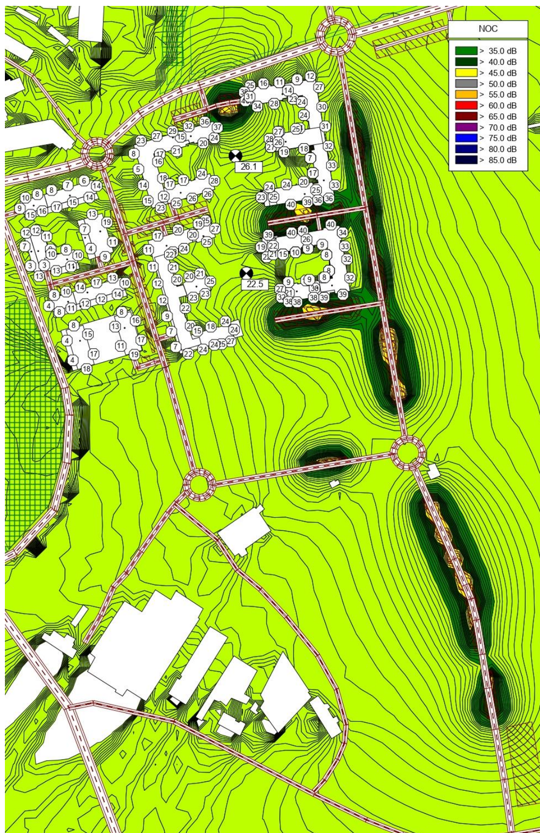
Obrázok 32 Plošná hluková záťaž spôsobená statickou dopravou vypočítaná vo výške 1,5 m nad terénom a najvyššie hodnoty L_{Aeq} 2 m pred fasádami objektov A3 a A4 Obytnéj zóny Cukrovar a fasádami okolitých budov a hodnota L_{Aeq} v pozorovacích bodoch umiestnených v mieste oddychovej zóny pre referenčný časový interval NOC
