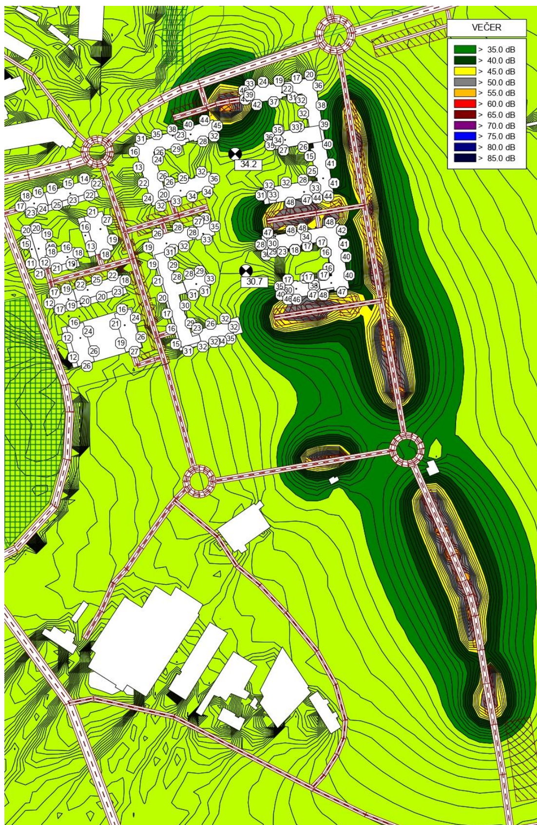
Obrázok 31 Plošná hluková záťaž spôsobená statickou dopravou vypočítaná vo výške 1,5 m nad terénom a najvyššie hodnoty L_{Aeq} 2 m pred fasádami objektov A3 a A4 Obytnej zóny Cukrovar a fasádami okolitých budov a hodnota L_{Aeq} v pozorovacích bodoch umiestnených v mieste oddychovej zóny pre referenčný časový interval VEČER
