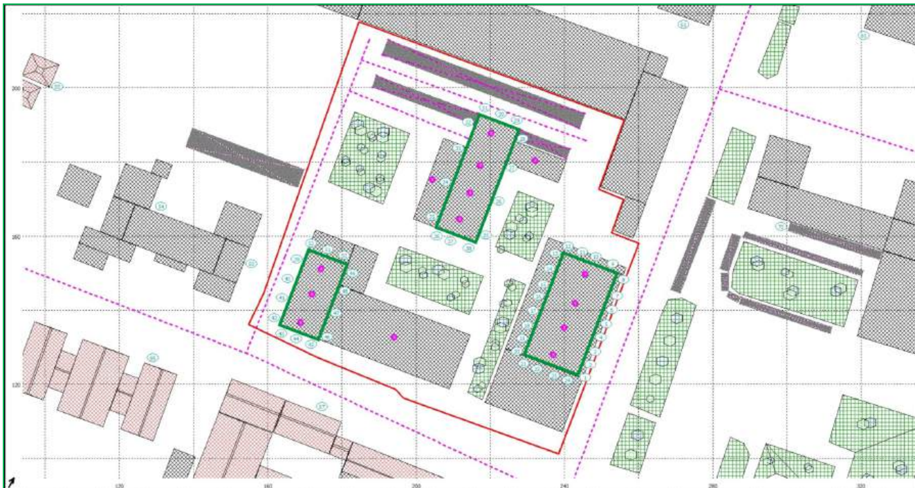
Obr. 2.12 Nepriezvučnosť obvodového plášťa R'_w \geq 30 dB pre projekt „NEO CITY, MARTIN“
