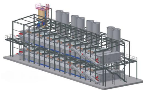
Obrázok 7 – Princíp sušenia drevných triesok v nepriamo vyhrievanej sušiarňi
