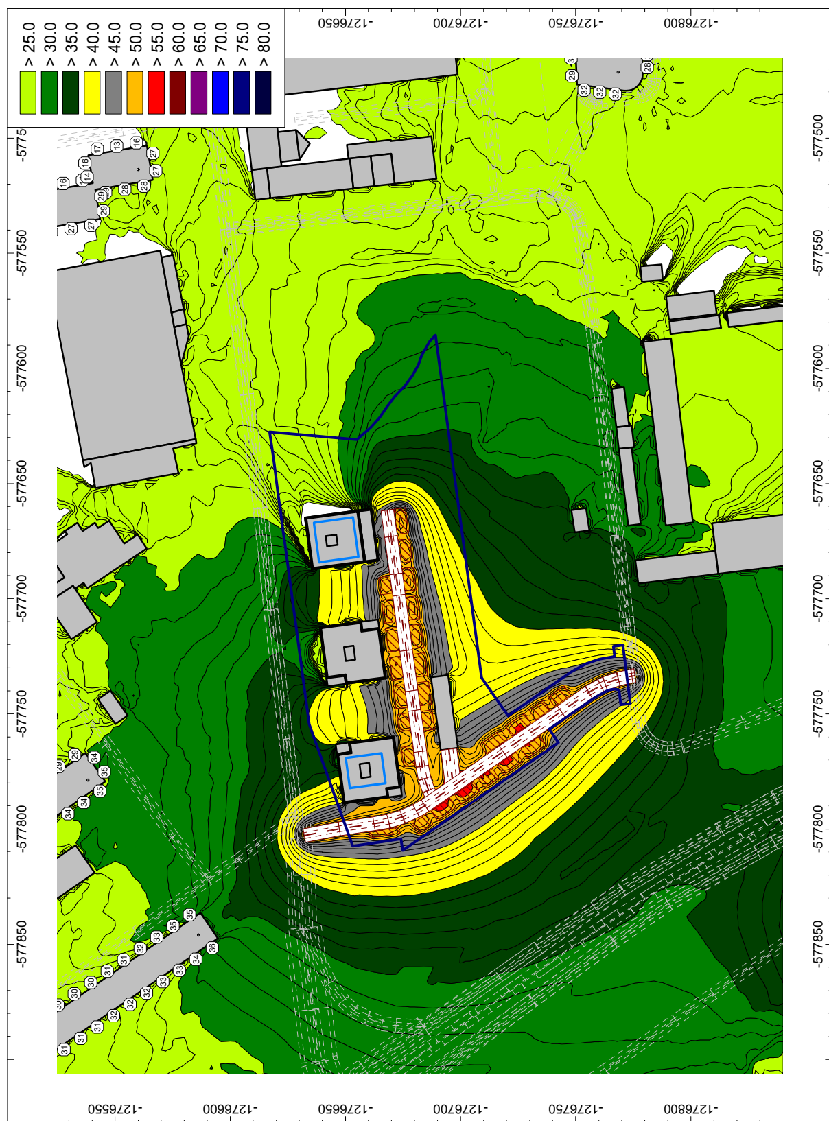
Obr. 22 vypočítaná plošná hluková záťaž vypočítaná vo výške 1,5 m nad terénom a hodnoty L Aeq v území pre večerný referenčný čas
