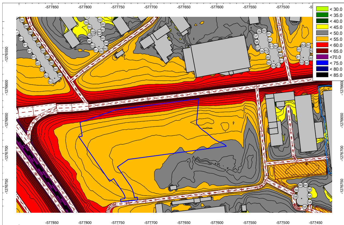
Obr. 26 hluková záťaž vypočítaná vo výške 1,5 m nad terénom a hodnoty ekvivalentných hladín A zvuku pred fasádami existujúcich chránených objektov vypočítané pre večerný referenčný časový interval
