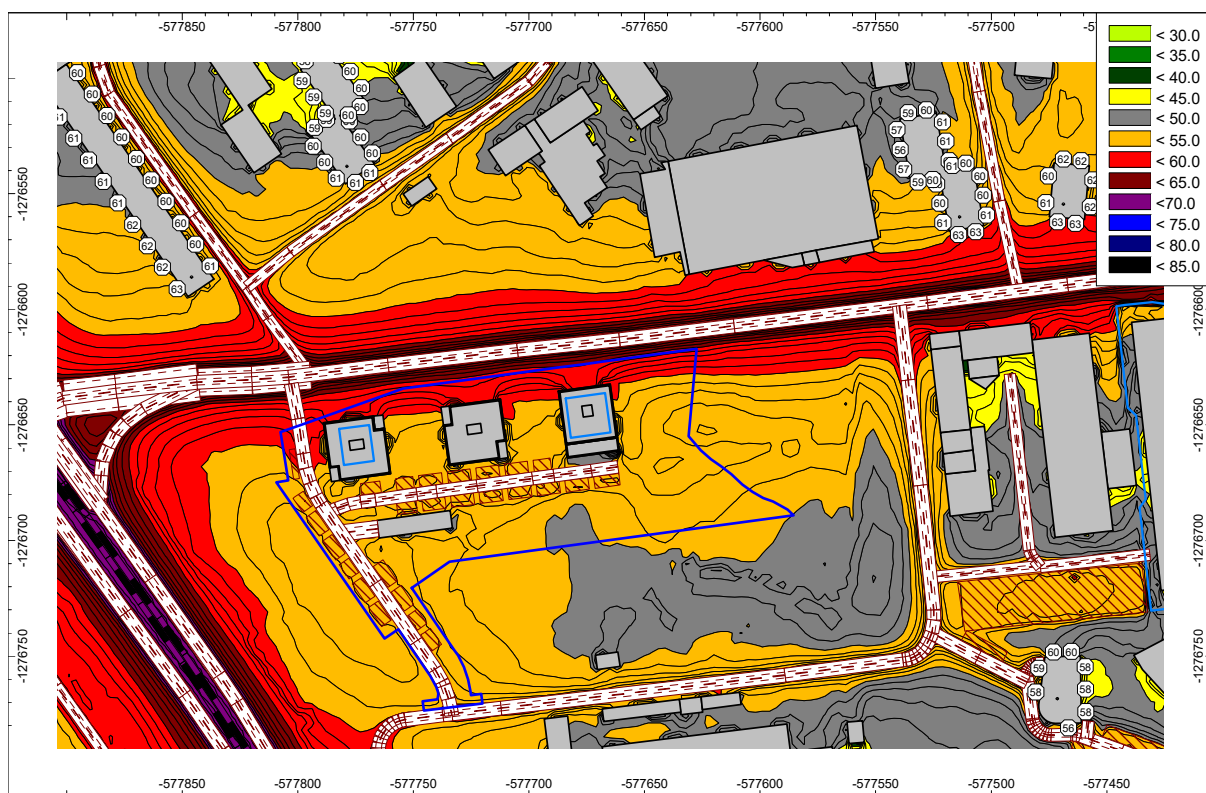
Obr. 27 hluková záťaž vypočítaná vo výške 1,5 m nad terénom a hodnoty ekvivalentných hladín A zvuku pred fasádami existujúcich chránených objektov vypočítané pre večerný referenčný časový interval
