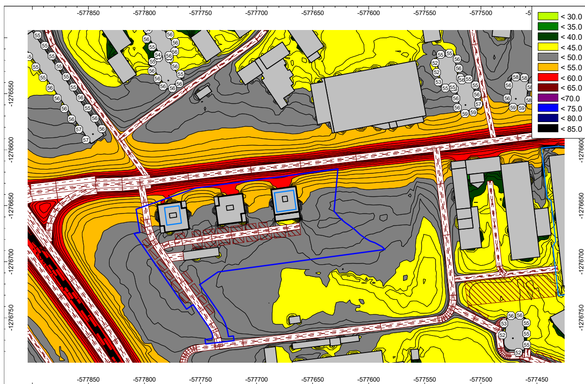
Obr. 29 hluková záťaž vypočítaná vo výške 1,5 m nad terénom a hodnoty ekvivalentných hladín A zvuku pred fasádami existujúcich chránených objektov vypočítané pre nočný referenčný časový interval
