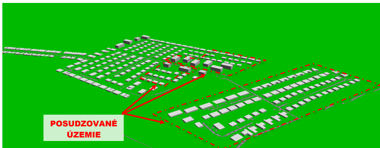
Obrázok 13 Perspektívny pohľad na 3D model budúceho stavu po výstavbe druhej etapy v akustickom programe CadnaA, riešené územie je označené červenou čiarkovanou čiarou
