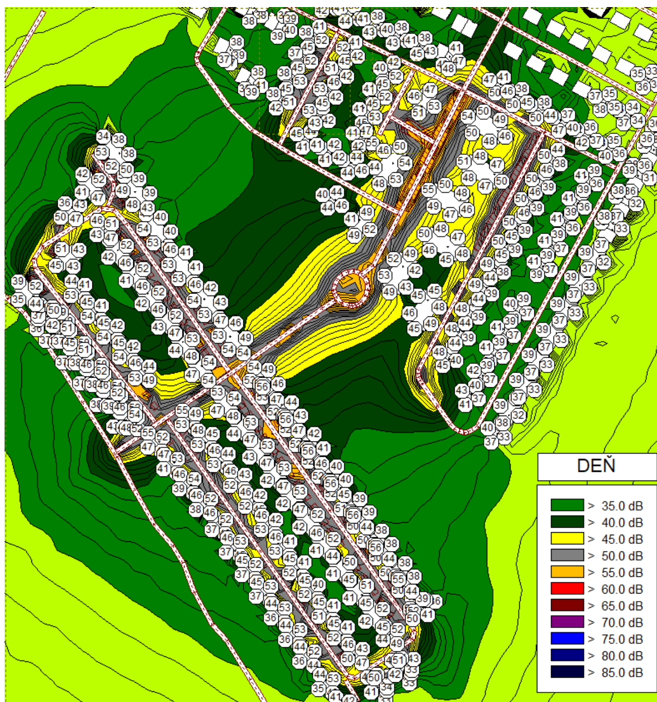
Obrázok 14 Plošná hluková záťaž spôsobená statickou dopravou vypočítaná vo výške 1,5 m nad terénom a najvyššie hodnoty L_{Aep} 2 m pred fasádami posudzovaných objektov a okolitých budov pre referenčný časový interval DEŇ
