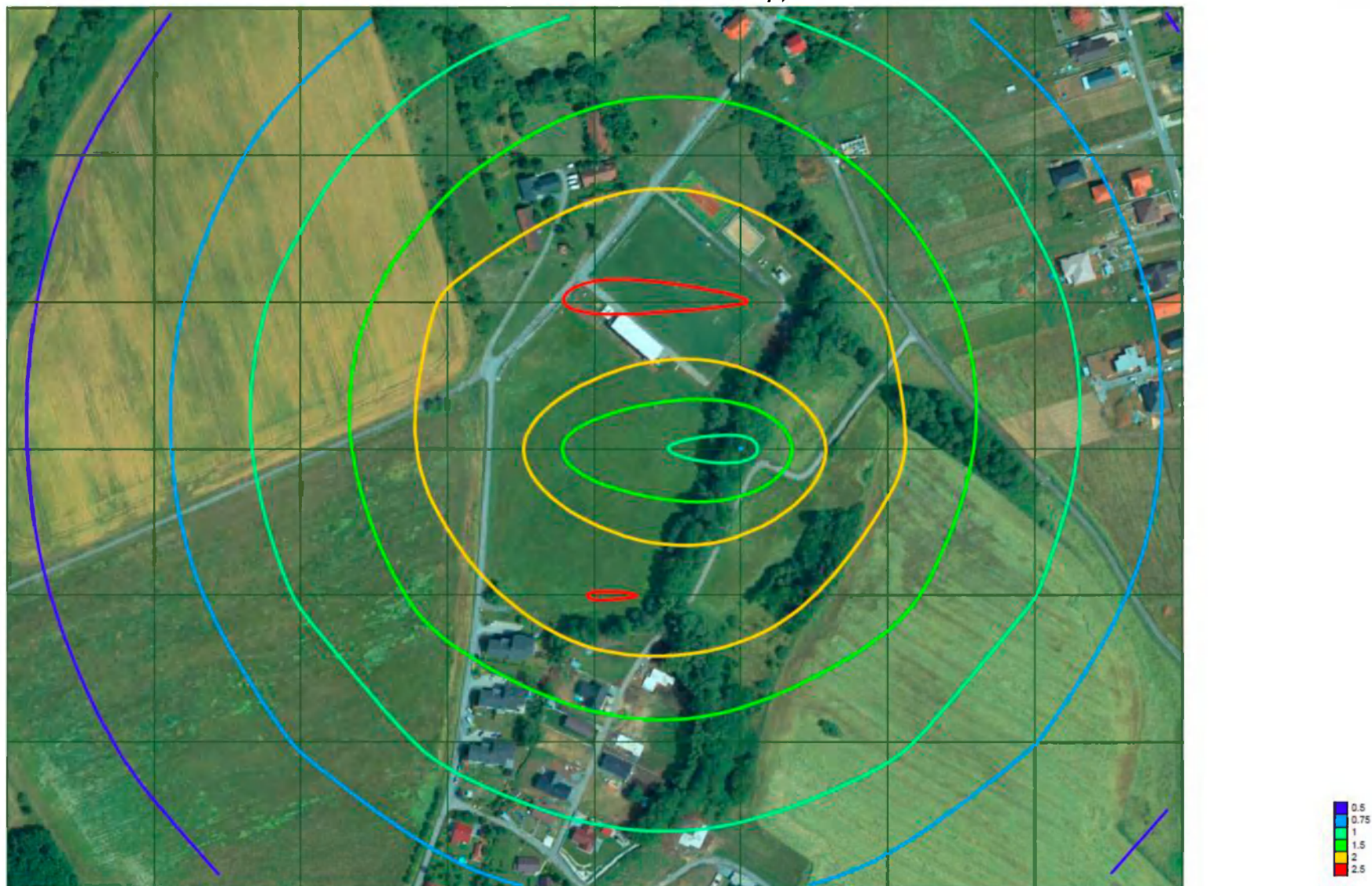
Príloha č. 16 Maximálne krátkodobé koncentrácie \text{NO}_2 [ \mu\text{g}/\text{m}^3 ] – izočiare rozptylu ZL zo zdrojov znečisťovania ovzdušia navrhovanej činnosti – Všetky etapy
