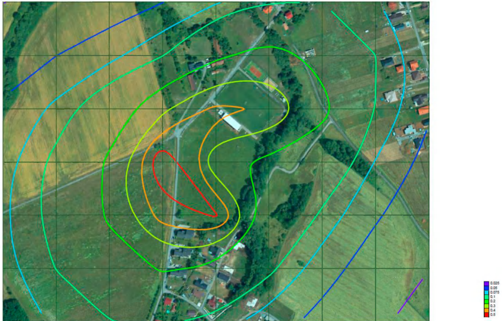
Príloha č. 21 Priemerné ročné koncentrácie TOC (VOC) [ \mu\text{g}/\text{m}^3 ] – izočiare rozptylu ZL zo zdrojov znečisťovania ovzdušia navrhovanej činnosti – Všetky etapy
