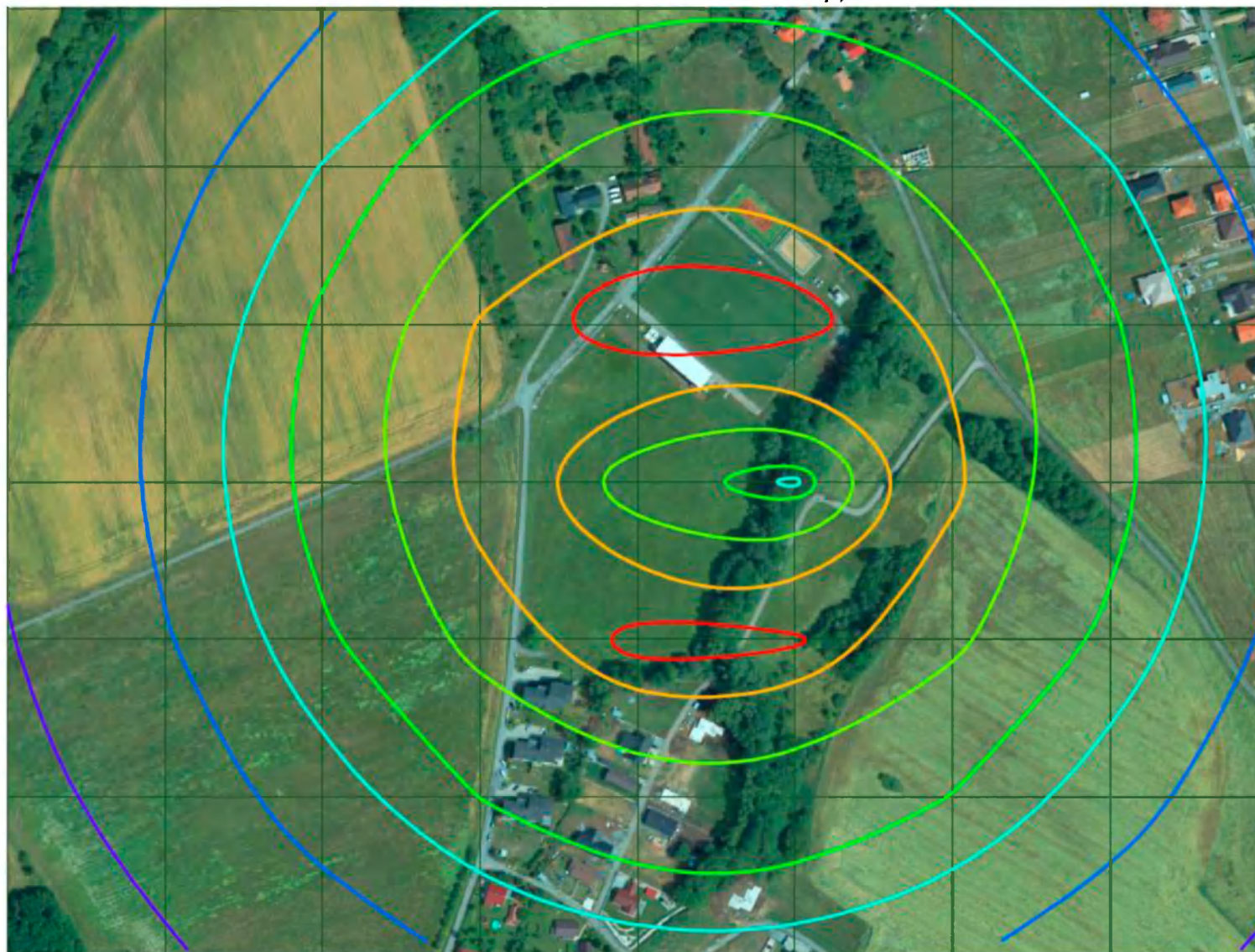
Príloha č. 12 Maximálne krátkodobé koncentrácie PM_{10} [ \mu g/m^3 ] – izočiary rozptylu ZL zo zdrojov znečisťovania ovzdušia navrhovanej činnosti – Všetky etapy
