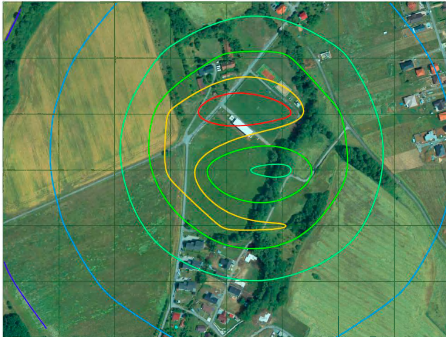
Príloha č. 4 Maximálne krátkodobé koncentrácie PM_{2.5} [ \mu g/m^3 ] – izočiary rozptylu ZL zo zdrojov znečisťovania ovzdušia navrhovanej činnosti – I. Etapa
