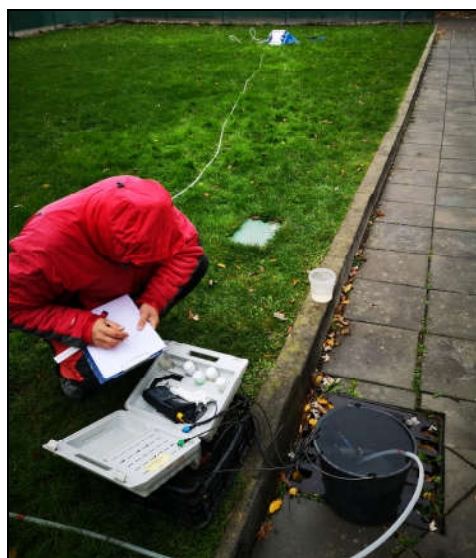
Obr.11c: Odber vzoriek podzemnej vody dynamickým začerpaním+ terénne merania prístrojom WTW (existujúci monitorovací vrt HGV-5)
