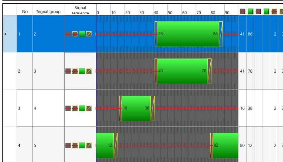
Obrázok 30 Schéma križovatky K2, Bajkalská - Drieňová Schéma križovatky a signálny plán pre 6:30 - 14:00 a 14:00 – 19:00
