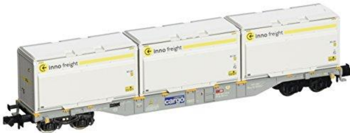
Obrázok 5 Plošinový vozeň radu S na prepravu kontajnerov s drevnou biomasou
