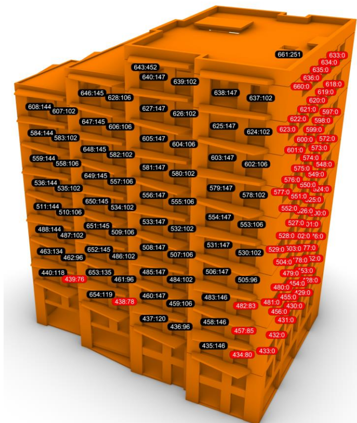
Obr. 46 – Preslnenie v kontrolných bodoch (v minútach)
