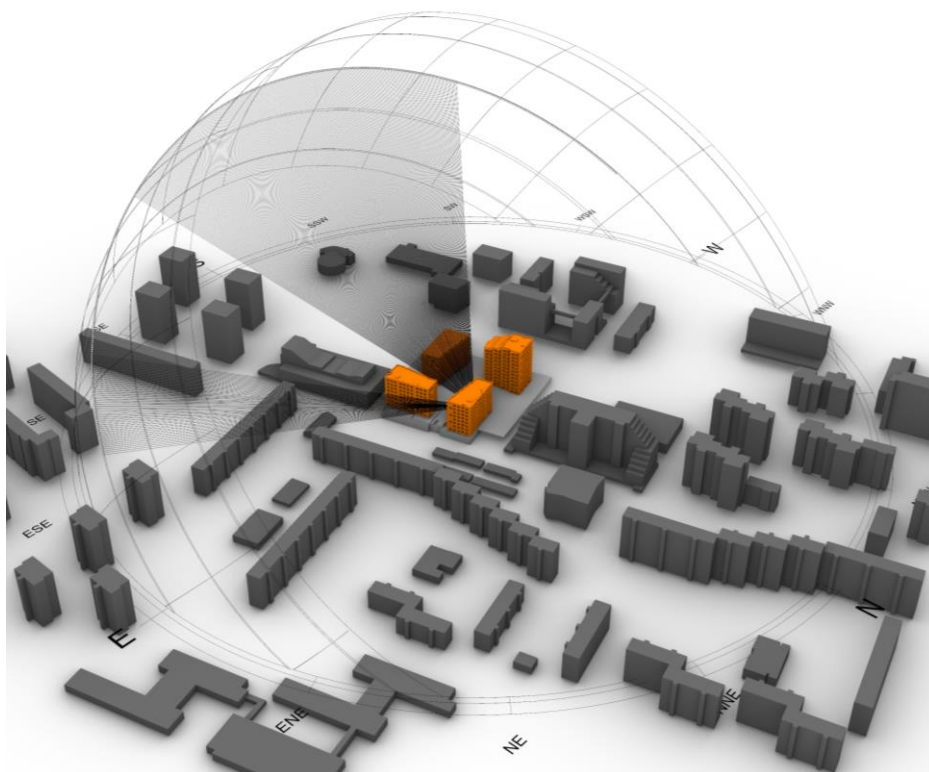
Obr. 42 – 3D model situácie s dráhami Slnka pre kontrolný bod KB211
