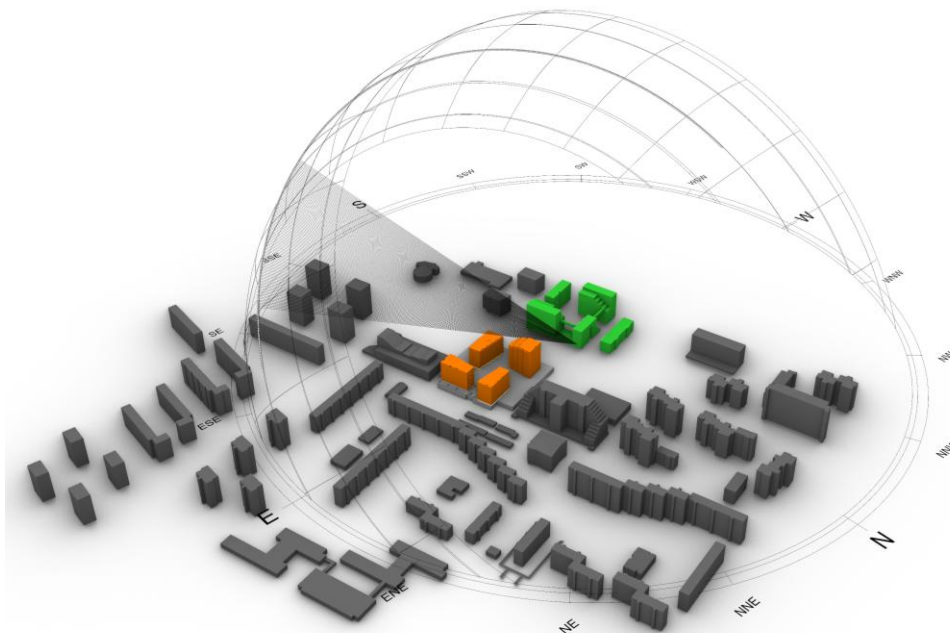
Obr. 37 – 3D model situácie s dráhami Slnka pre kontrolný bod KB0
