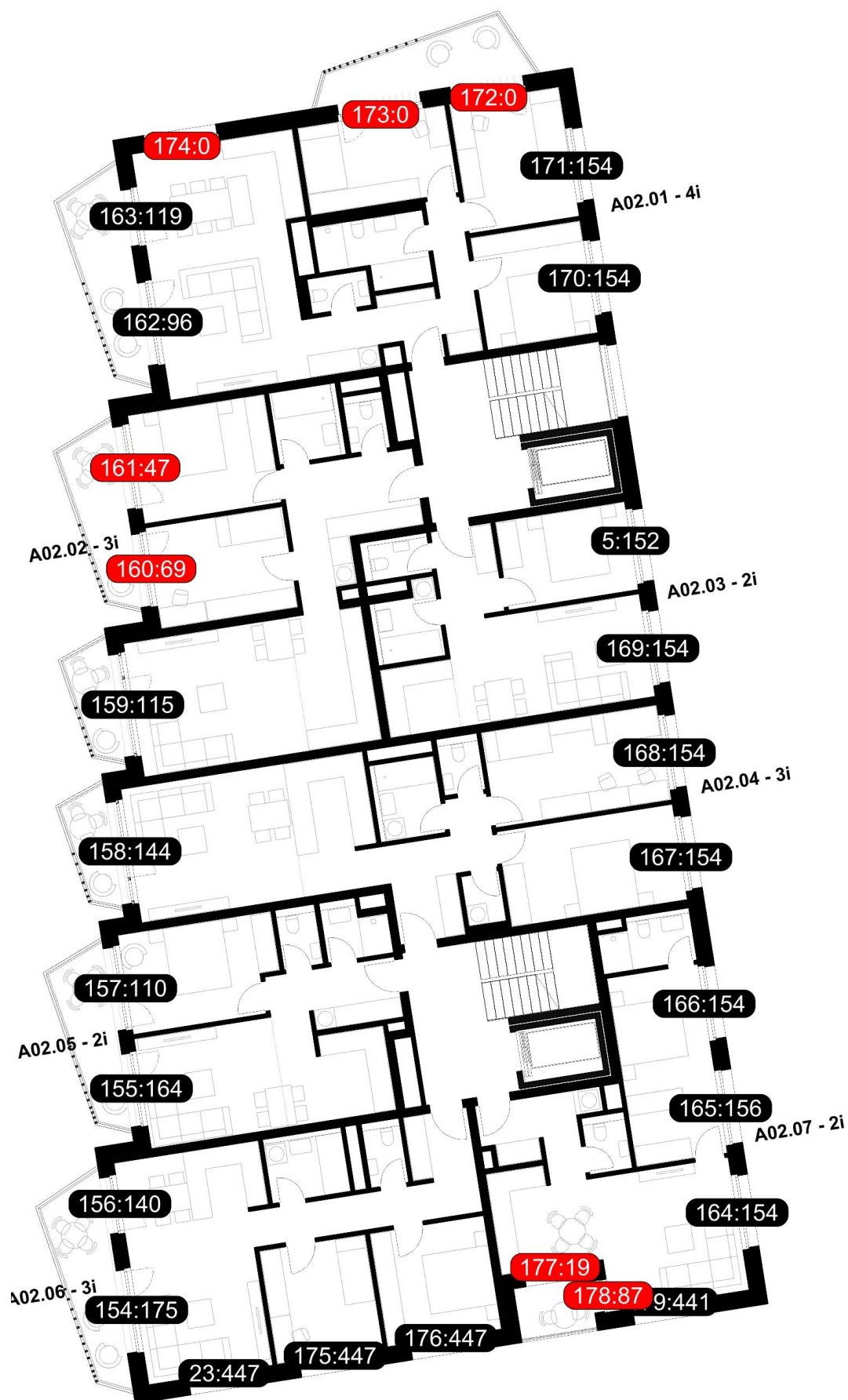
Obr. 32 – Preslnenie v kontrolných bodoch (v minútach) - 3. NP - 01/S01 Bytový dom
