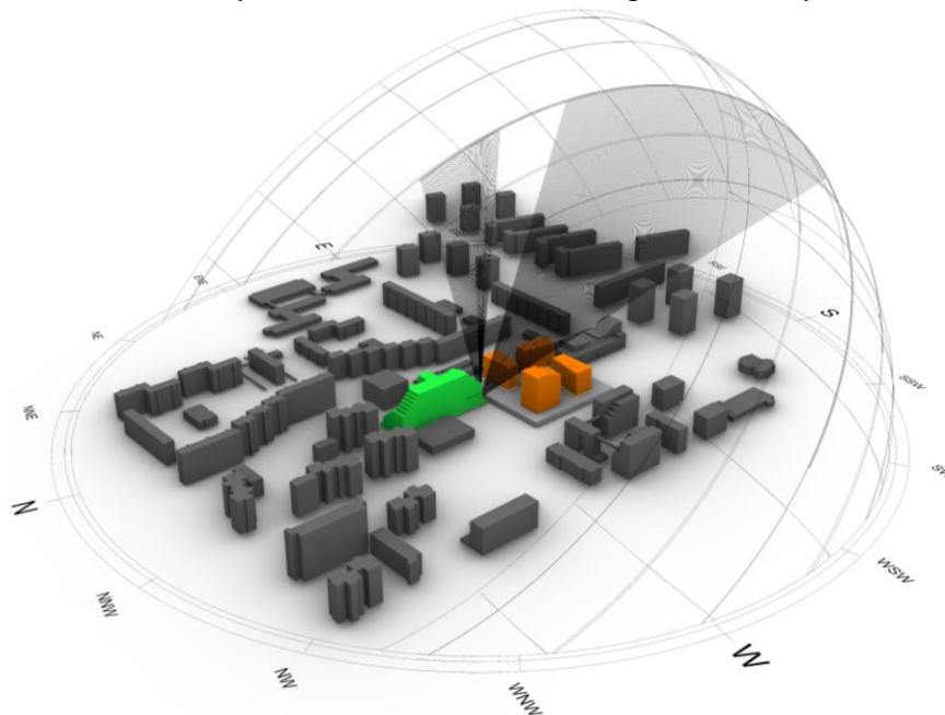
Obr. 22 – 3D model situácie s dráhami Slnka pre kontrolný bod KB27
