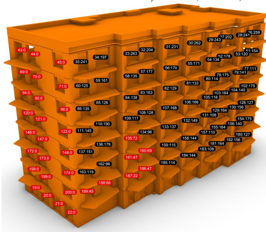
Obr. 29 – Preslnenie v kontrolných bodoch (v minútach)
