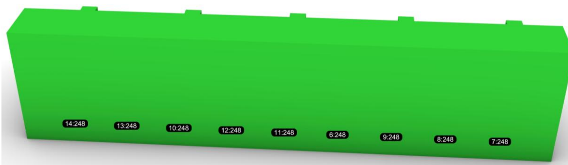
Obr. 25 – Preslnenie v kontrolných bodoch (v minútach) – bez vplyvu plánovanej výstavby
