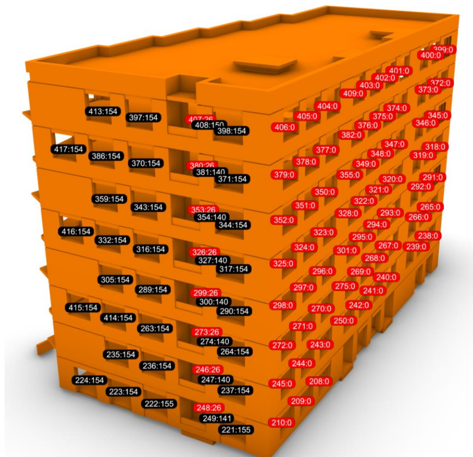
Obr. 37 – Preslnenie v kontrolných bodoch (v minútach)
