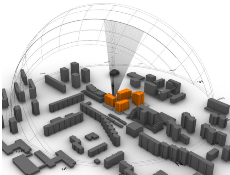
Obr. 33 – 3D model situácie s dráhami Slnka pre kontrolný bod KB185
