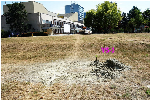
Obr č. 6: Za vrtom VS-3 sa mocnosť navážiek zväčšuje o cca 70 cm na takmer 4 m
