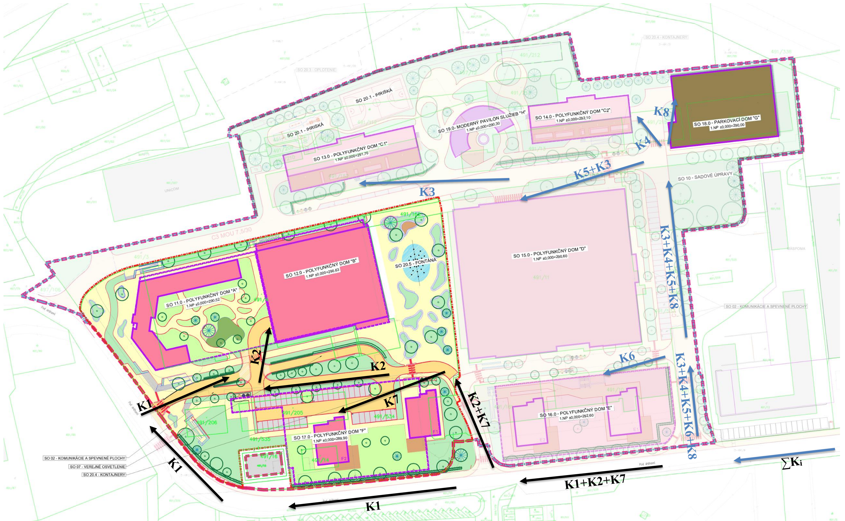
Obr. 5.4 Vyznačenie odhadovaného trasovania dopravy v polyfunkčnom komplexe
