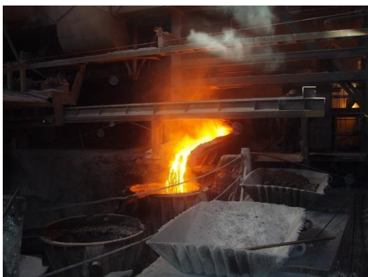
Obrázok 4: OFZ odpich a odlievanie do panvy
