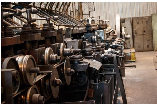
Obrázok 8: výroba plnených profilov
