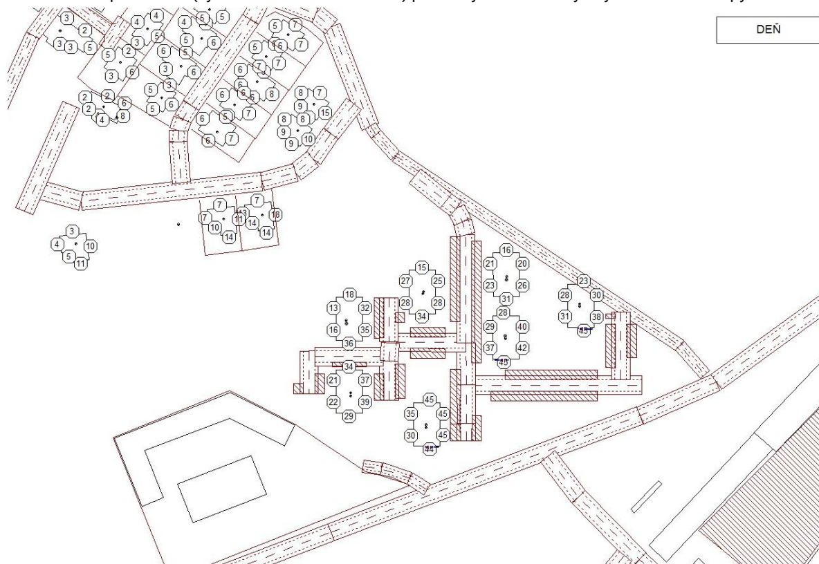
Obrázok 30 Simulácia hlukovej záťaže spôsobenej stacionárnymi zdrojmi hluku s protihlukovými opatreniami - hodnoty L_{Aeq} 2 m pred fasádami bytových domov II. etapy a fasádami okolitých objektov, doplnené o neistoty merania (+2,3 dB) a korekciou na tónový hluk zo zariadení (+5 dB) pre referenčný časový interval DEŇ
